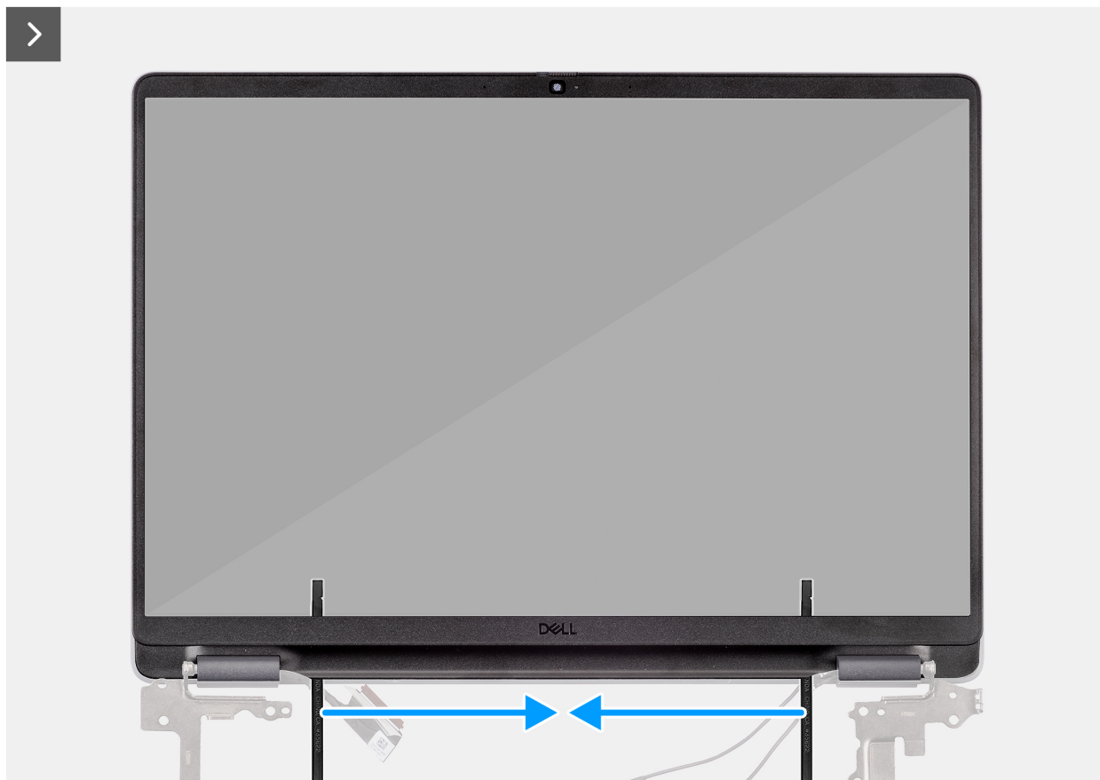
Figura 78. Rimozione della cornice del display
