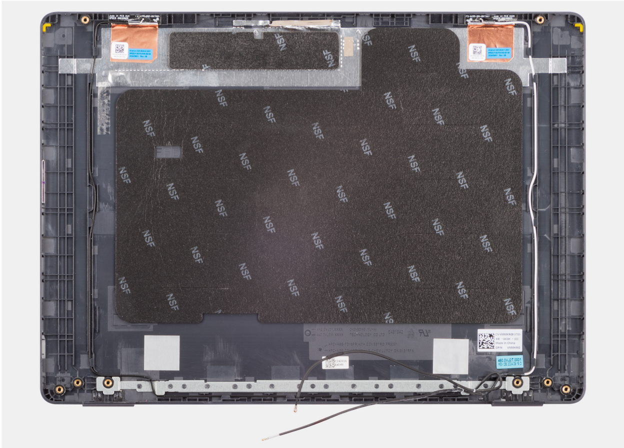
Figura 96. Rimozione del gruppo coperchio posteriore del display
