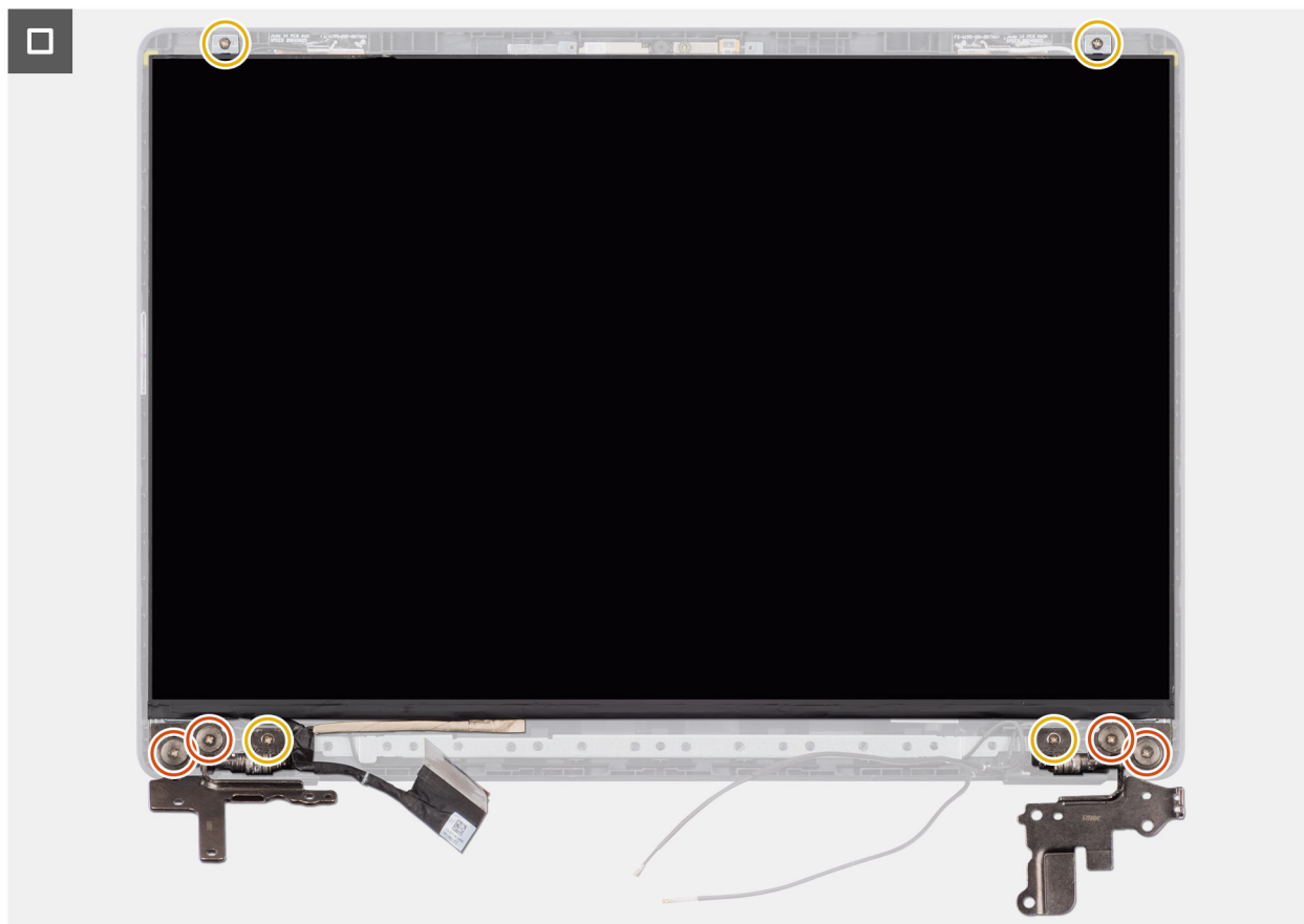
Figura 91. Installazione del gruppo del pannello del display
