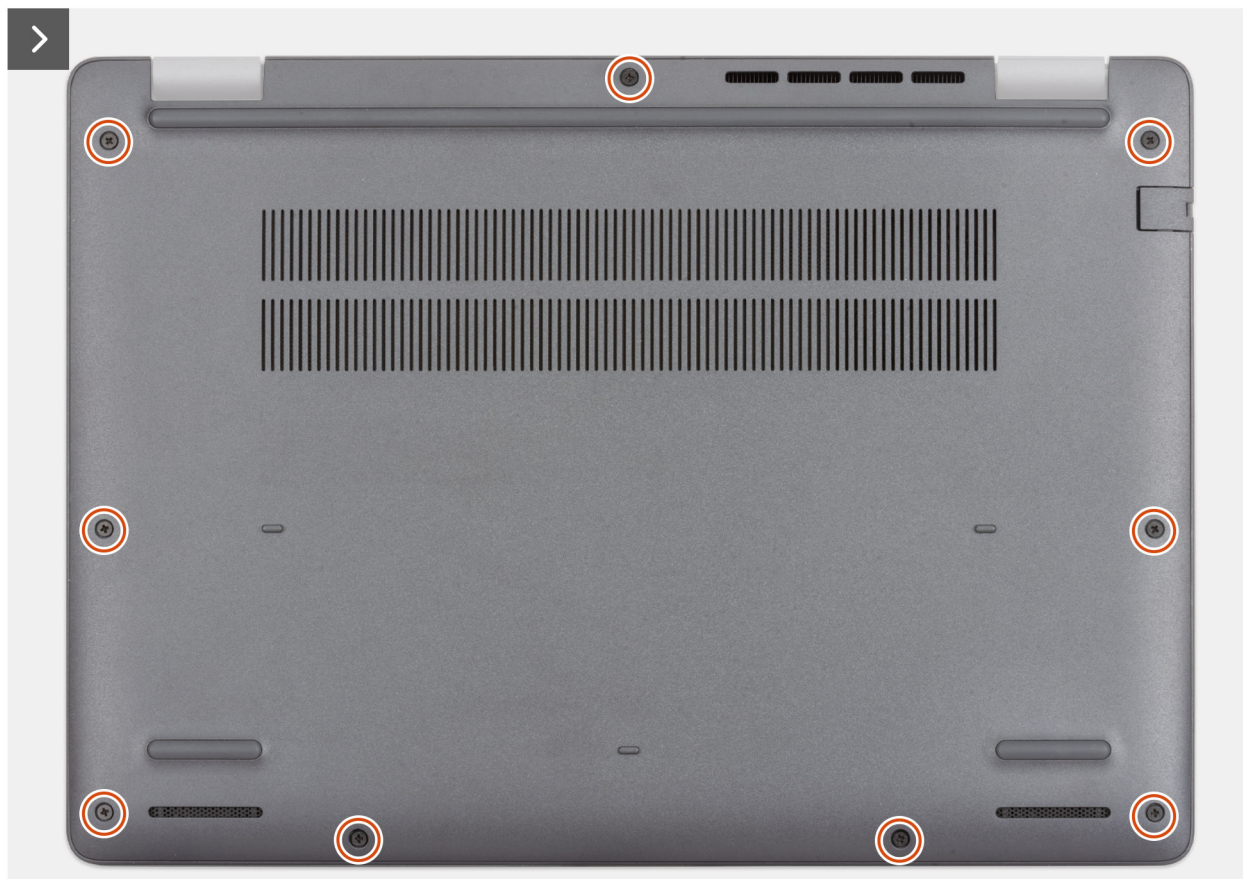
Figura 11. Rimozione del coperchio della base
