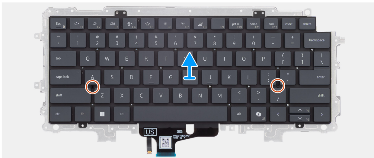
Figura 66. Rimozione della piastra di supporto della tastiera
