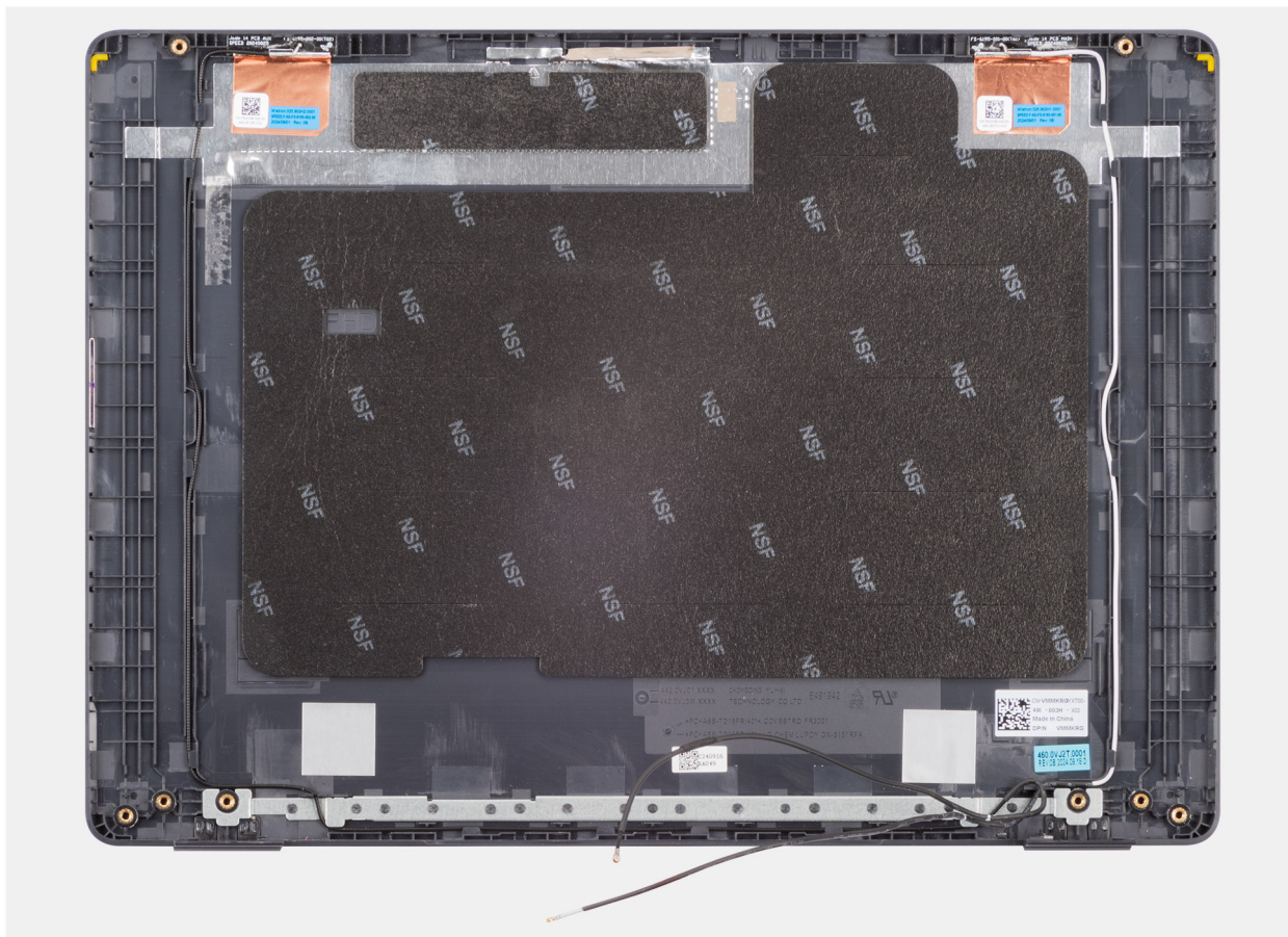
Figura 97. Installazione del gruppo coperchio posteriore del display
