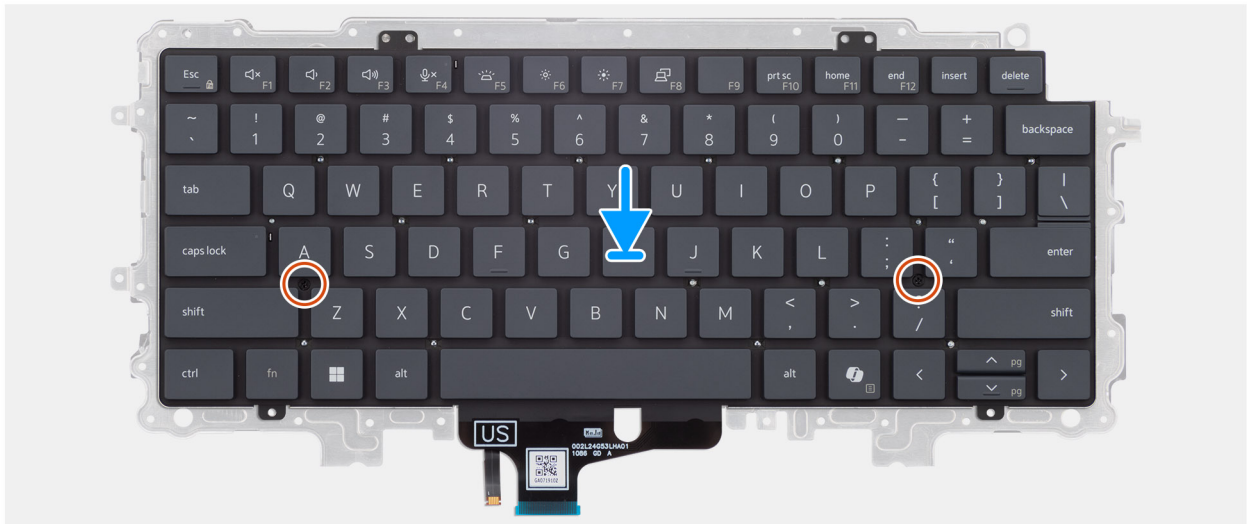
Figura 69. Installazione della piastra di supporto della tastiera
