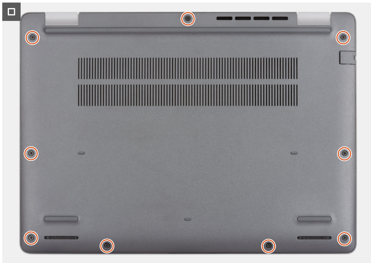
Figura 16. Installazione del coperchio della base
