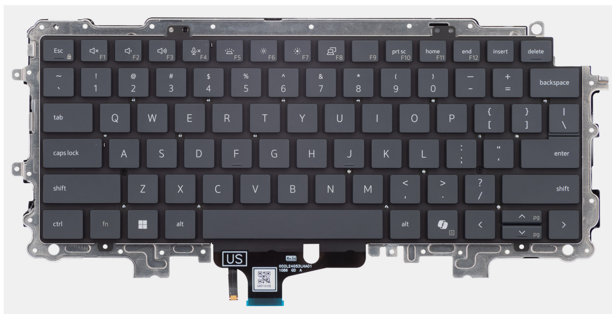
Figura 62. Rimozione della tastiera
