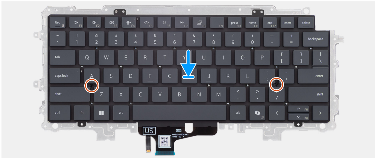
Figura 94. Installazione della piastra di supporto della tastiera
