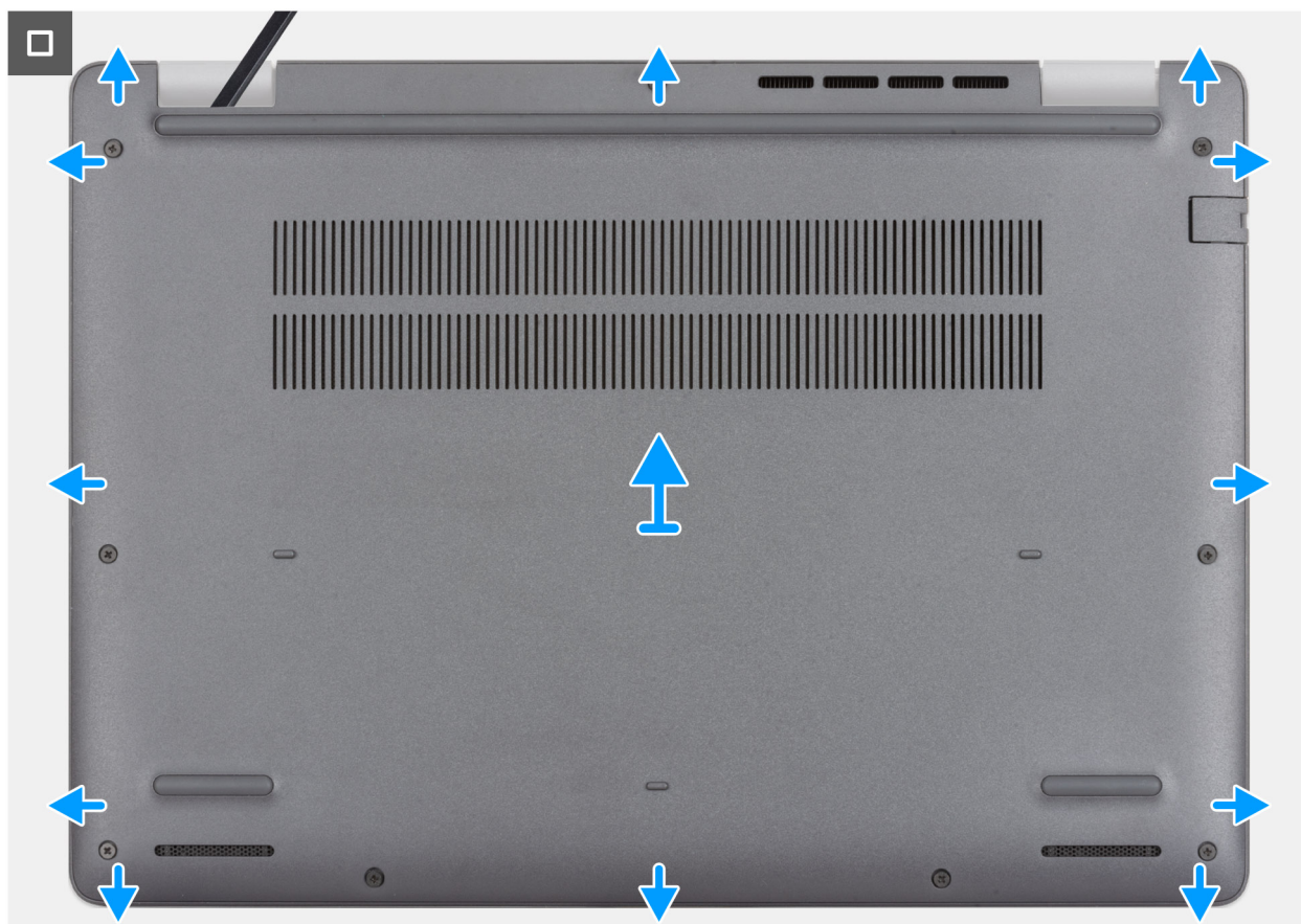
Figura 12. Rimozione del coperchio della base
