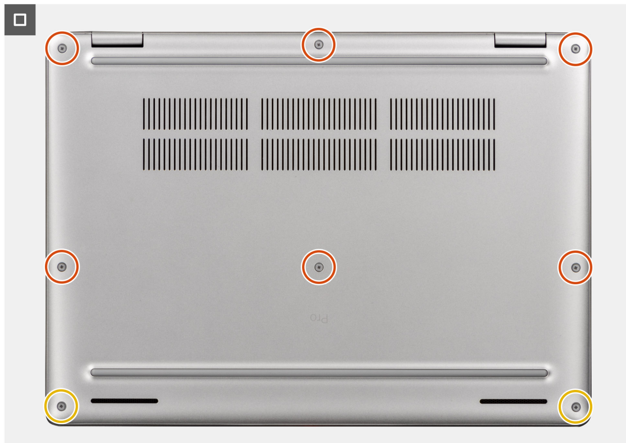
Figura 27. Installazione del coperchio della base
