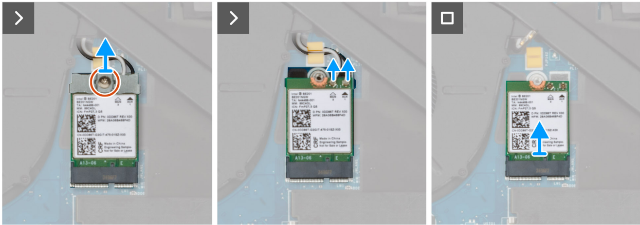
Figura 40. Rimozione della scheda WLAN
