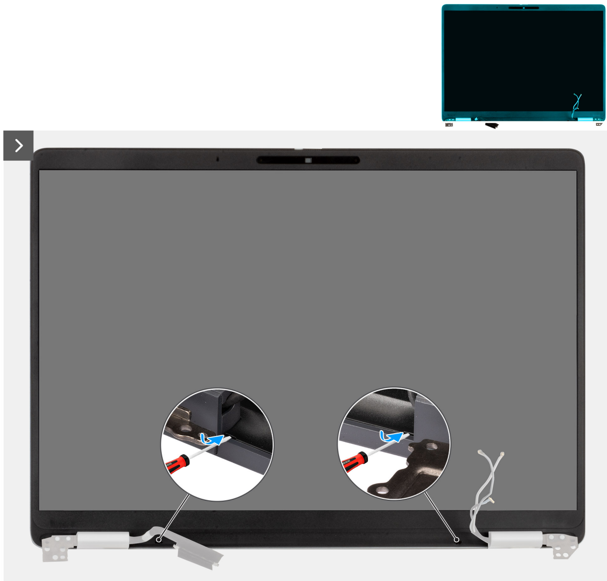
Figura 68. Rimozione della cornice del display
