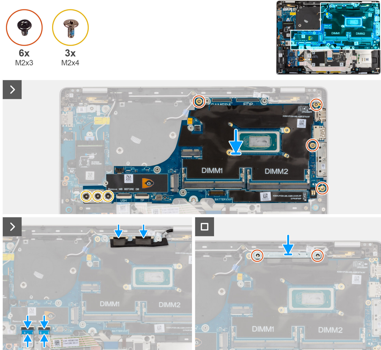
Figura 53. Installazione della scheda di sistema
