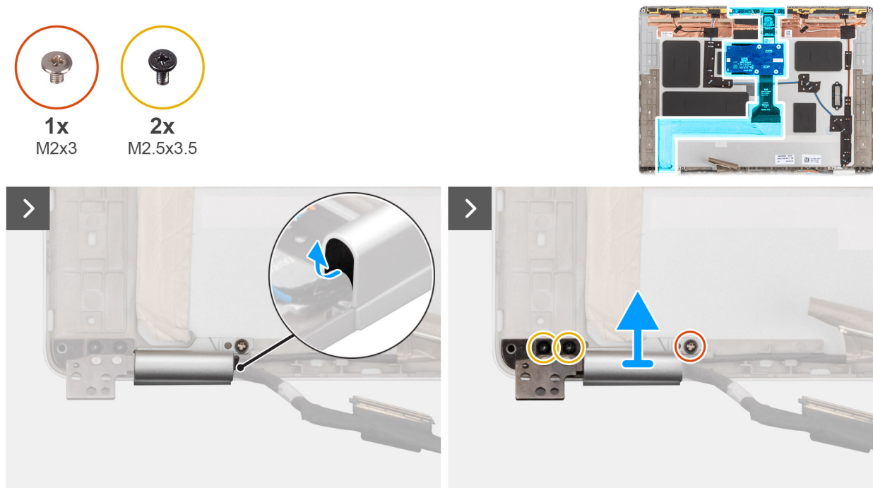
Figura 84. Rimozione del cavo del display
