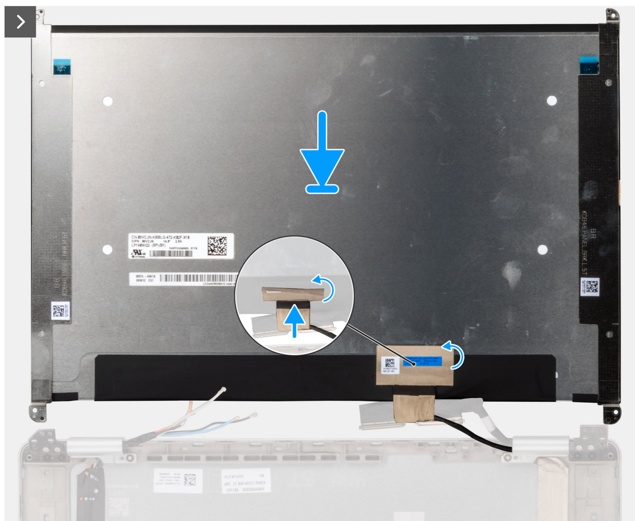
Figura 52. Installazione del cavo del display
