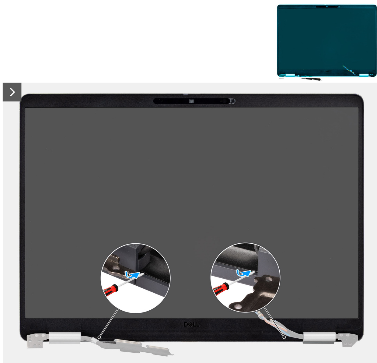
Figura 43. Sollevamento della cornice in plastica
