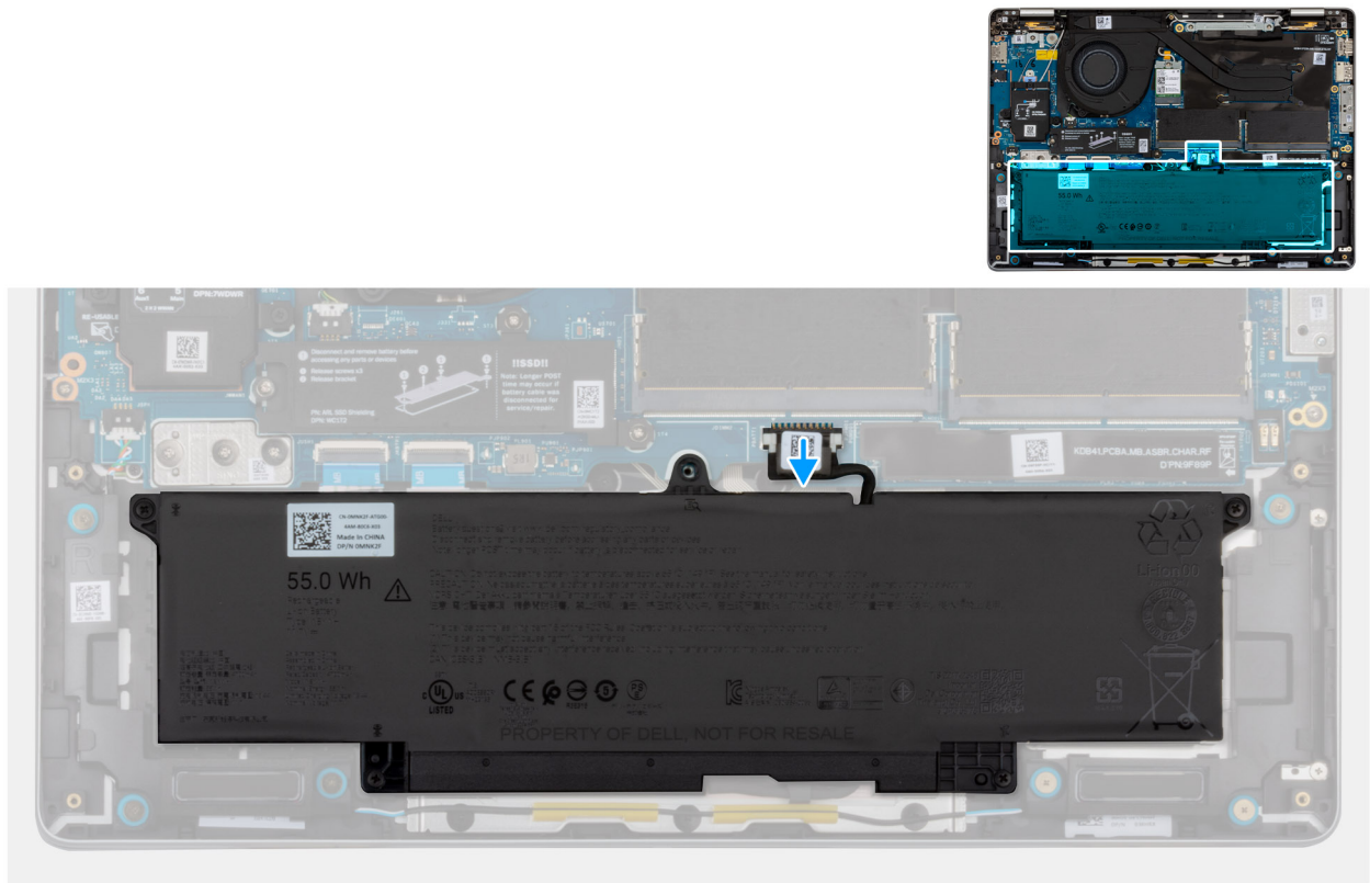
Figura 24. Scollegamento del cavo della batteria
