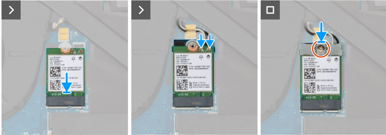
Figura 41. Installazione della scheda WLAN
