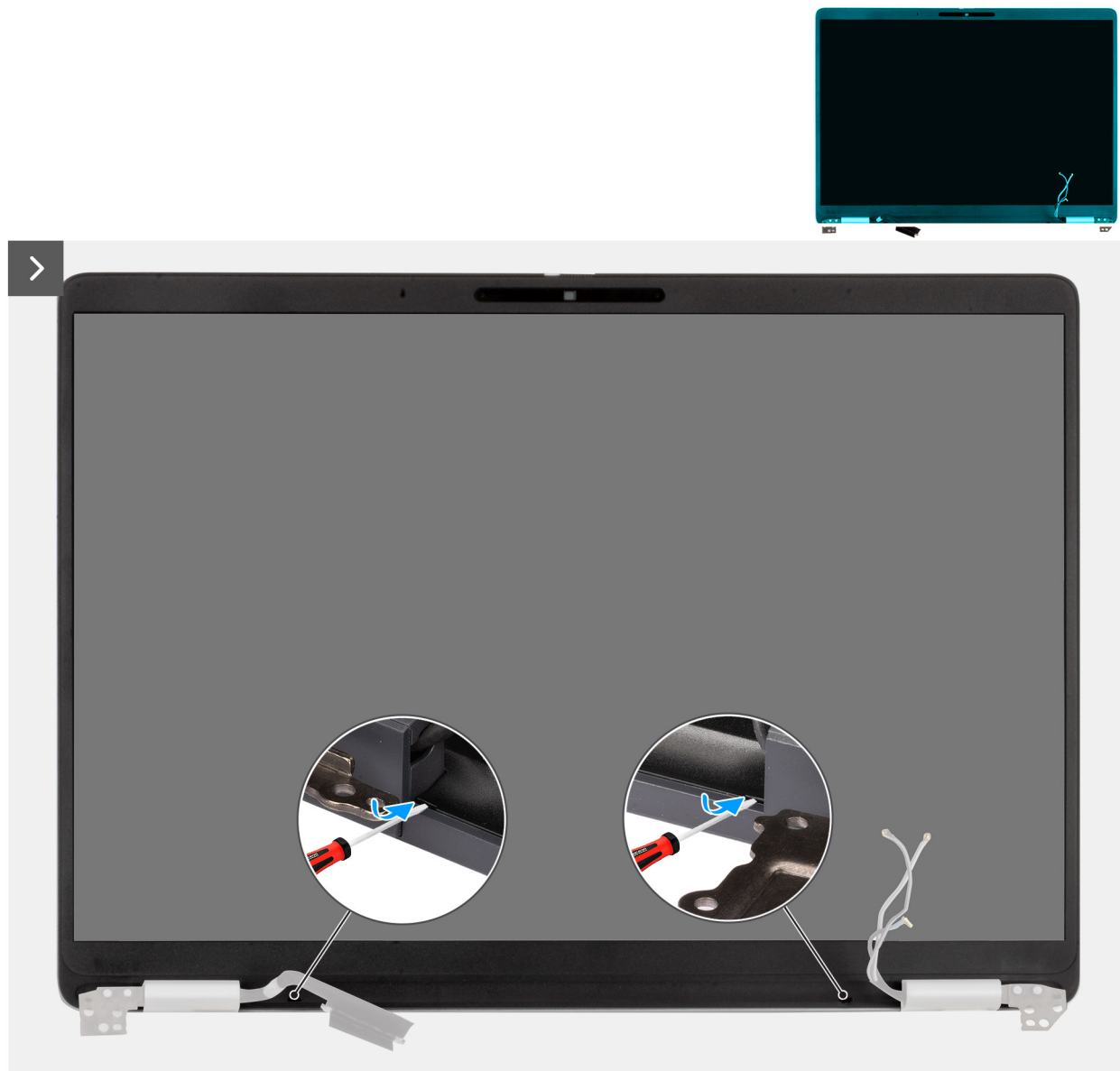
Figura 68. Rimozione della cornice del display
