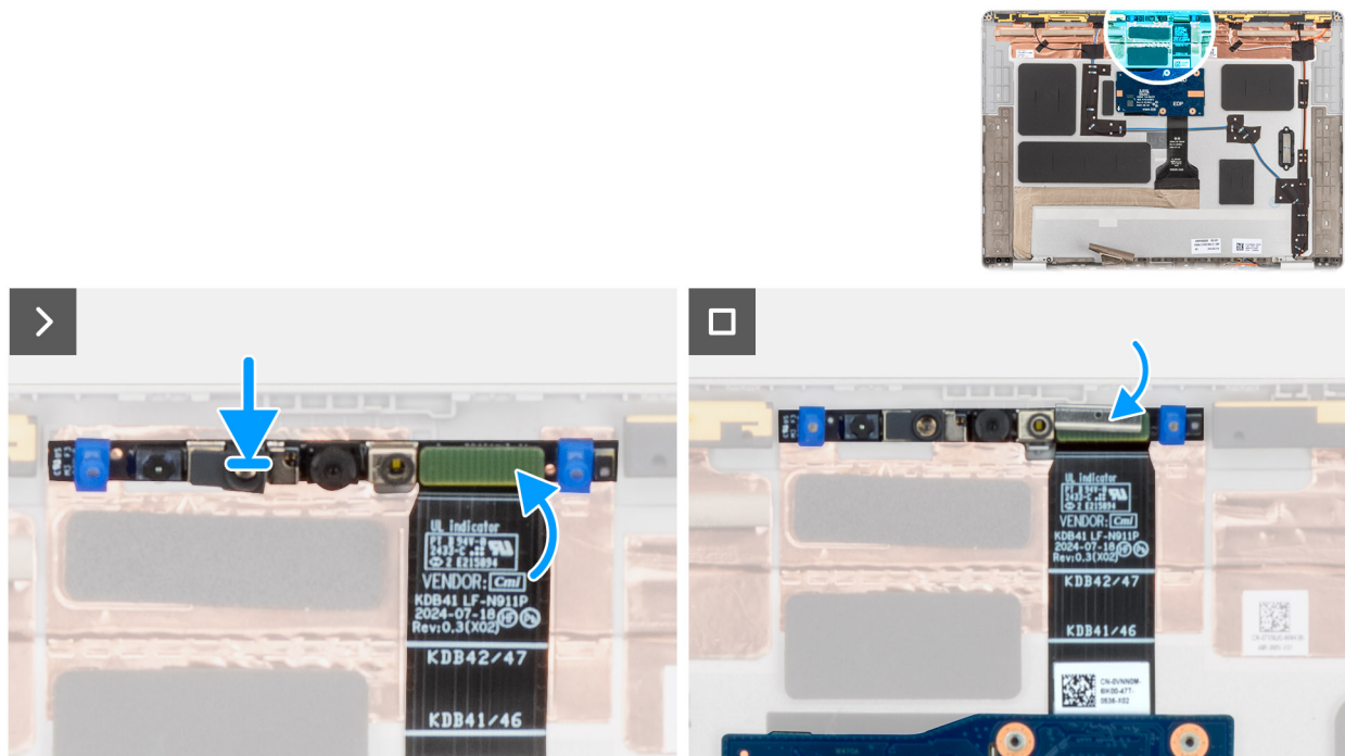
Figura 89. Installazione della fotocamera MIPI
