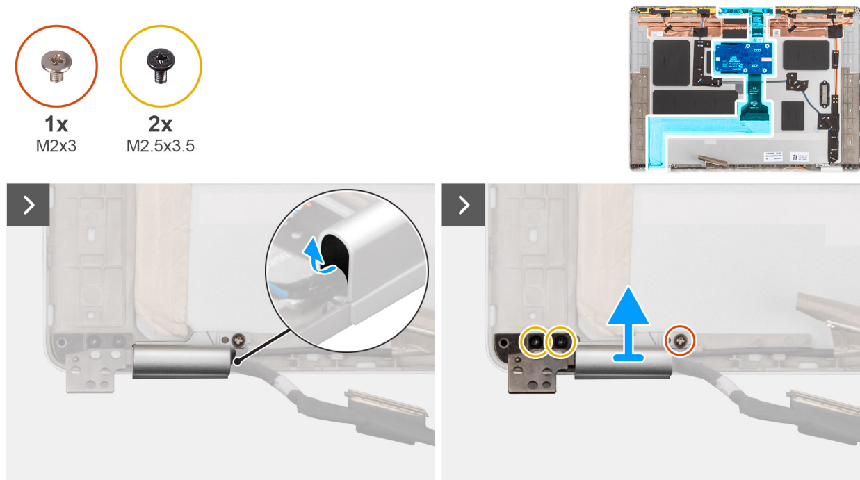
Figura 84. Rimozione del cavo del display
