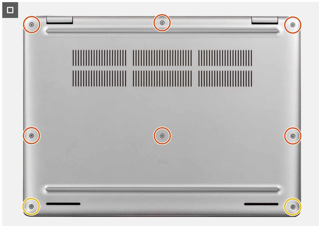
Figura 27. Installazione del coperchio della base
