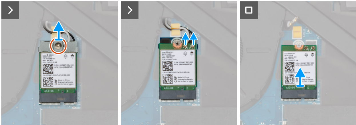
Figura 40. Rimozione della scheda WLAN
