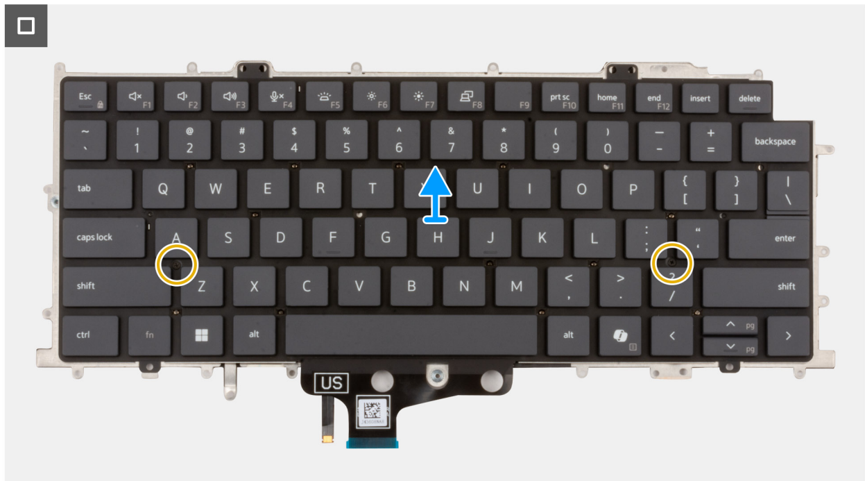
Figura 99. Rimozione della tastiera
