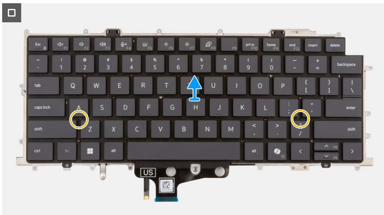
Figura 99. Rimozione della tastiera
