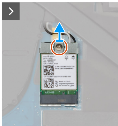
Figura 40. Rimozione della scheda WLAN
