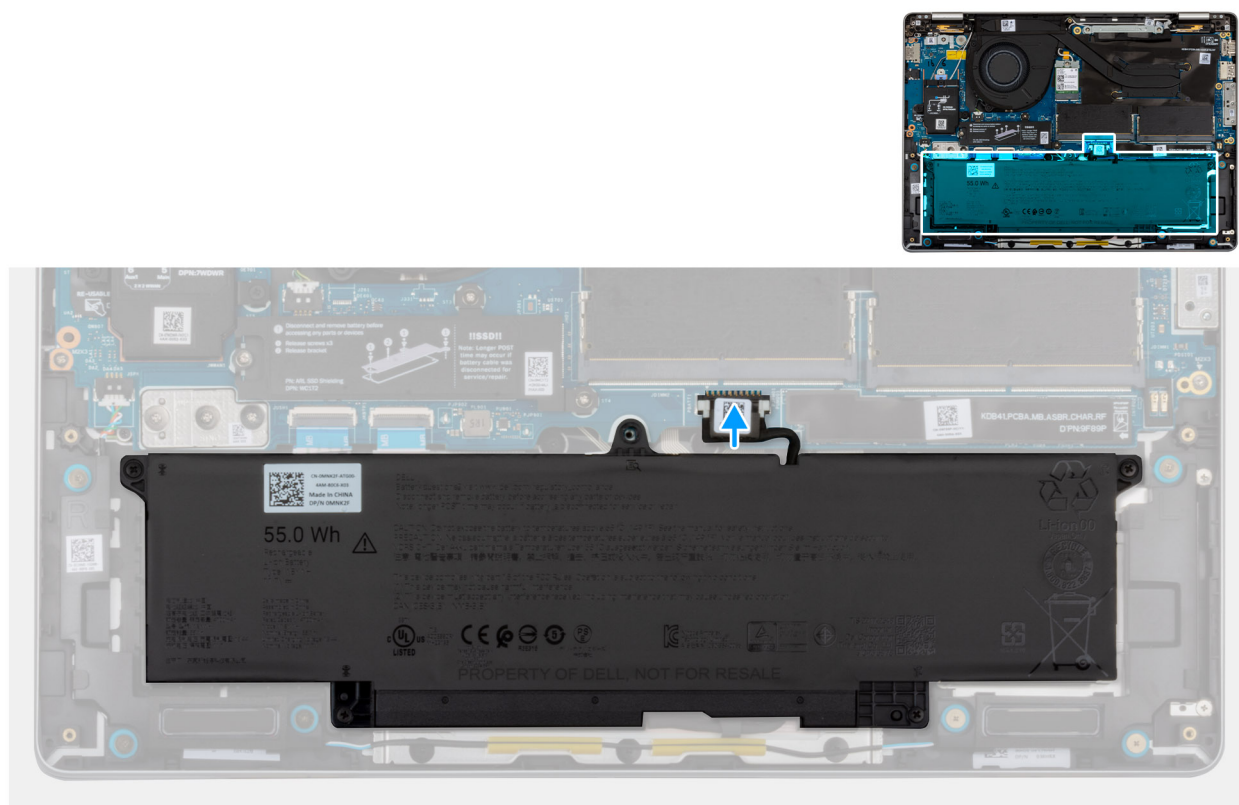
Figura 25. Collegamento del cavo della batteria
