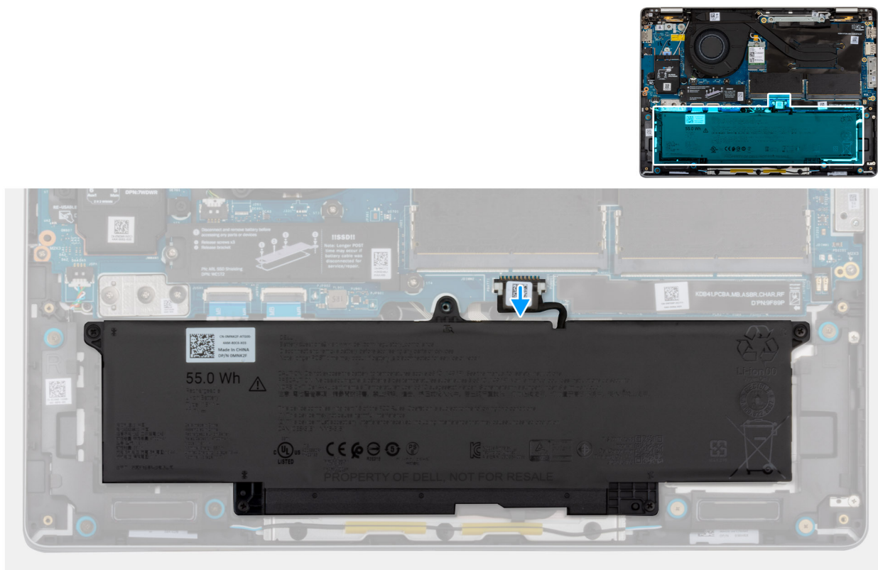
Figura 24. Scollegamento del cavo della batteria
