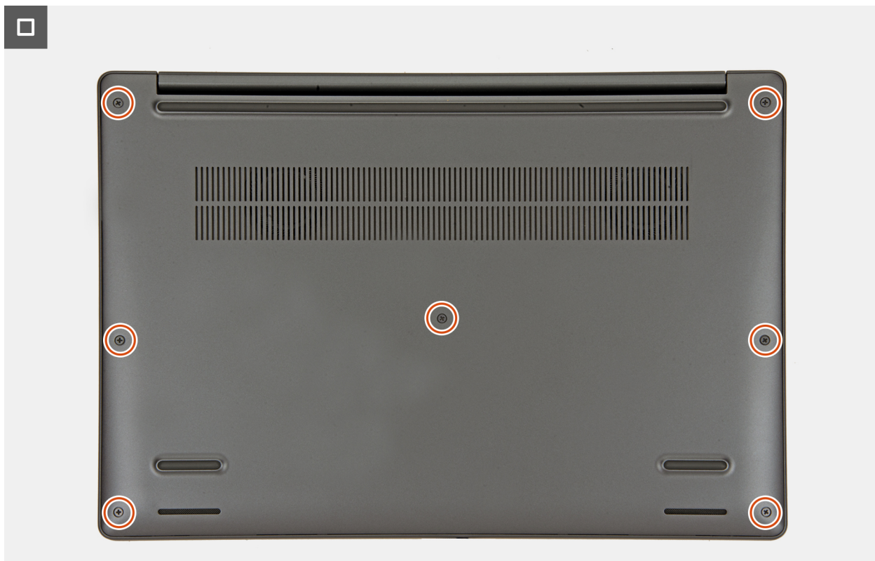
Figura 21. Serrare le viti di fissaggio
