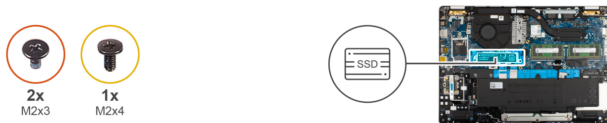
Figura 27. Installazione dell'SSD M.2 2280
