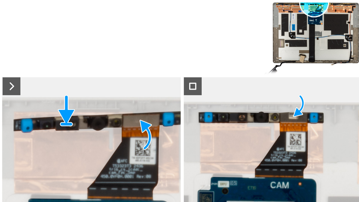
Figura 79. Installazione del modulo della fotocamera
