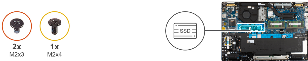
Figura 27. Installazione dell'SSD M.2 2280
