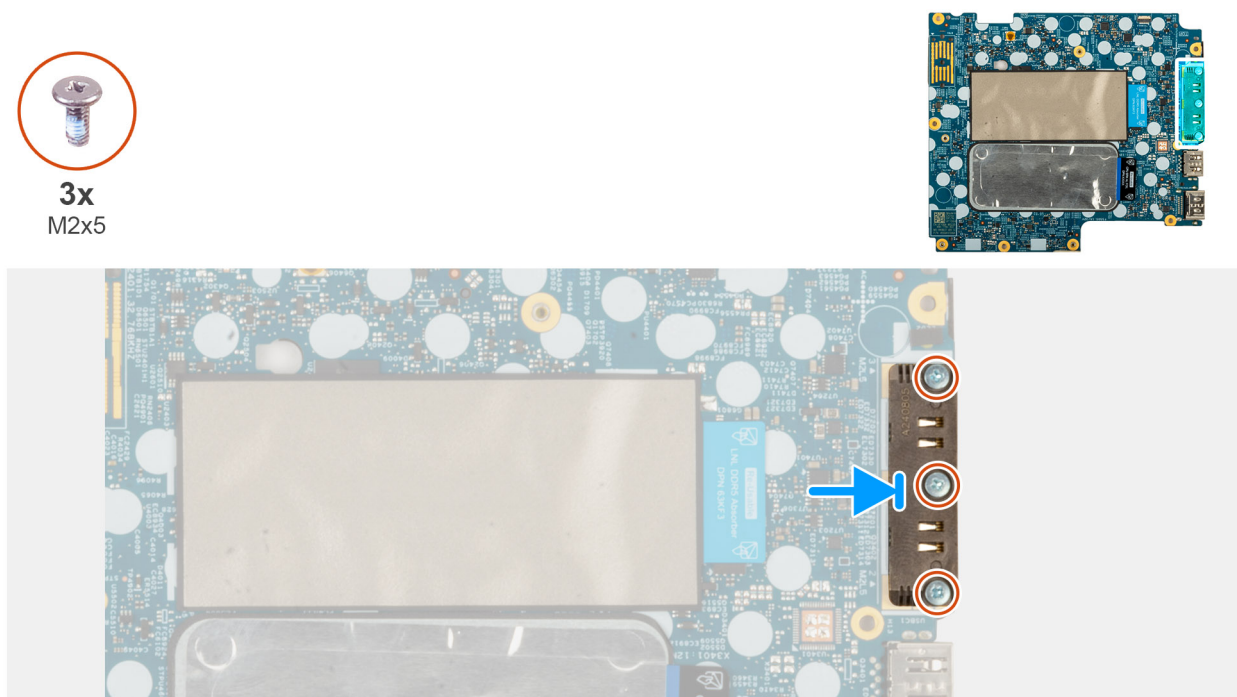
Figura 53. Installazione del modulo del connettore USB Type-C.
