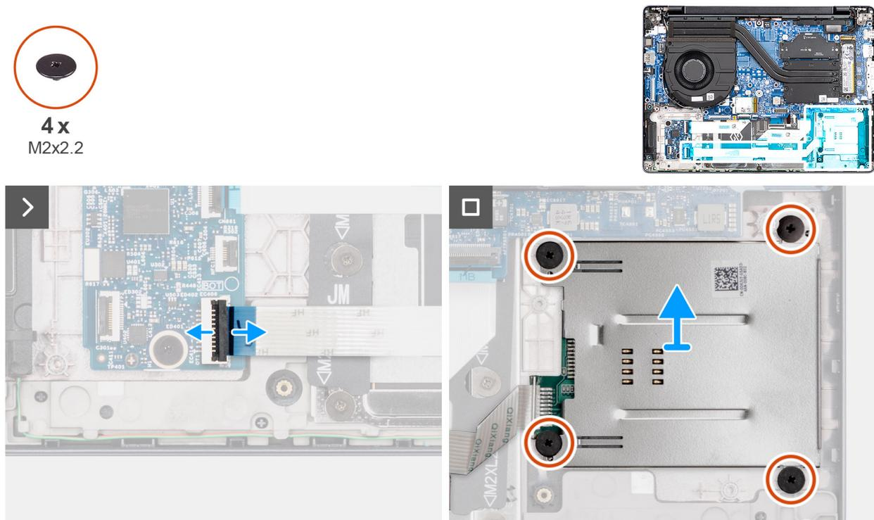
Figura 37. Rimozione del lettore di smart card
