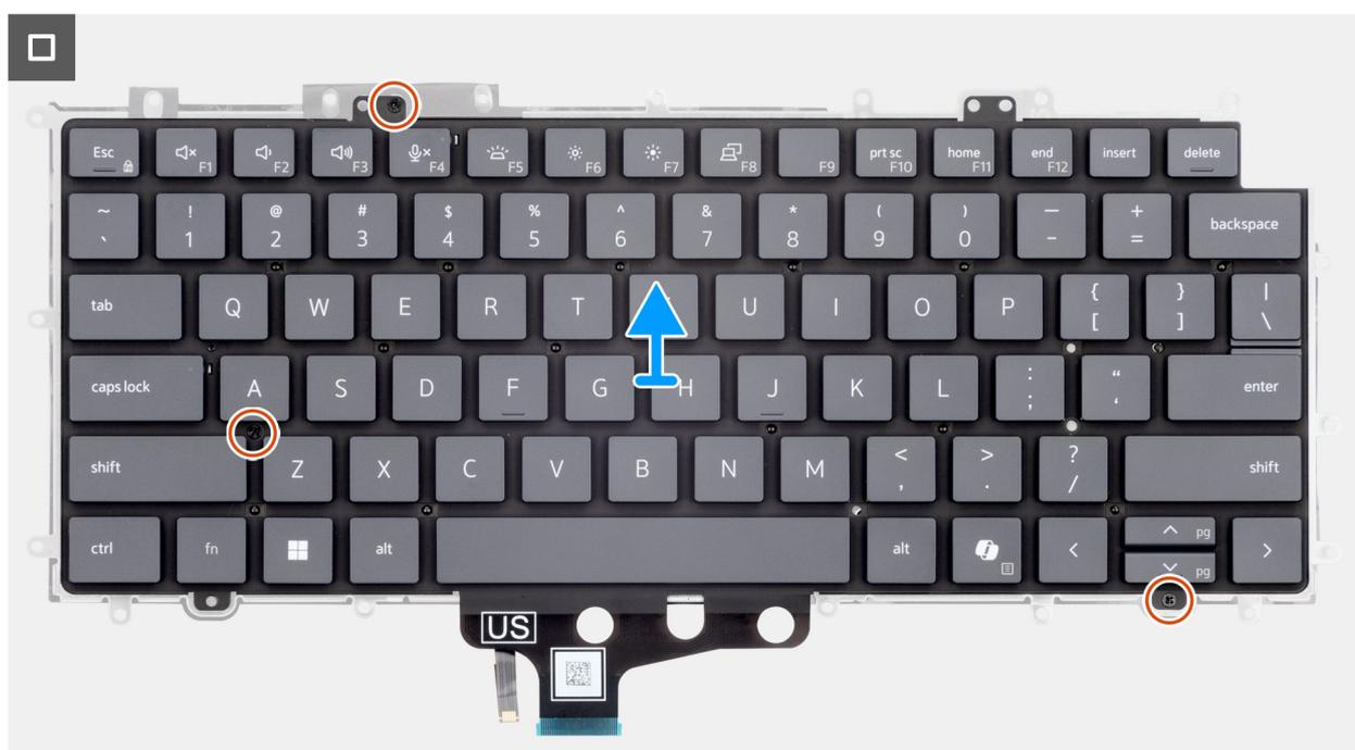
Figura 96. Rimozione della tastiera
