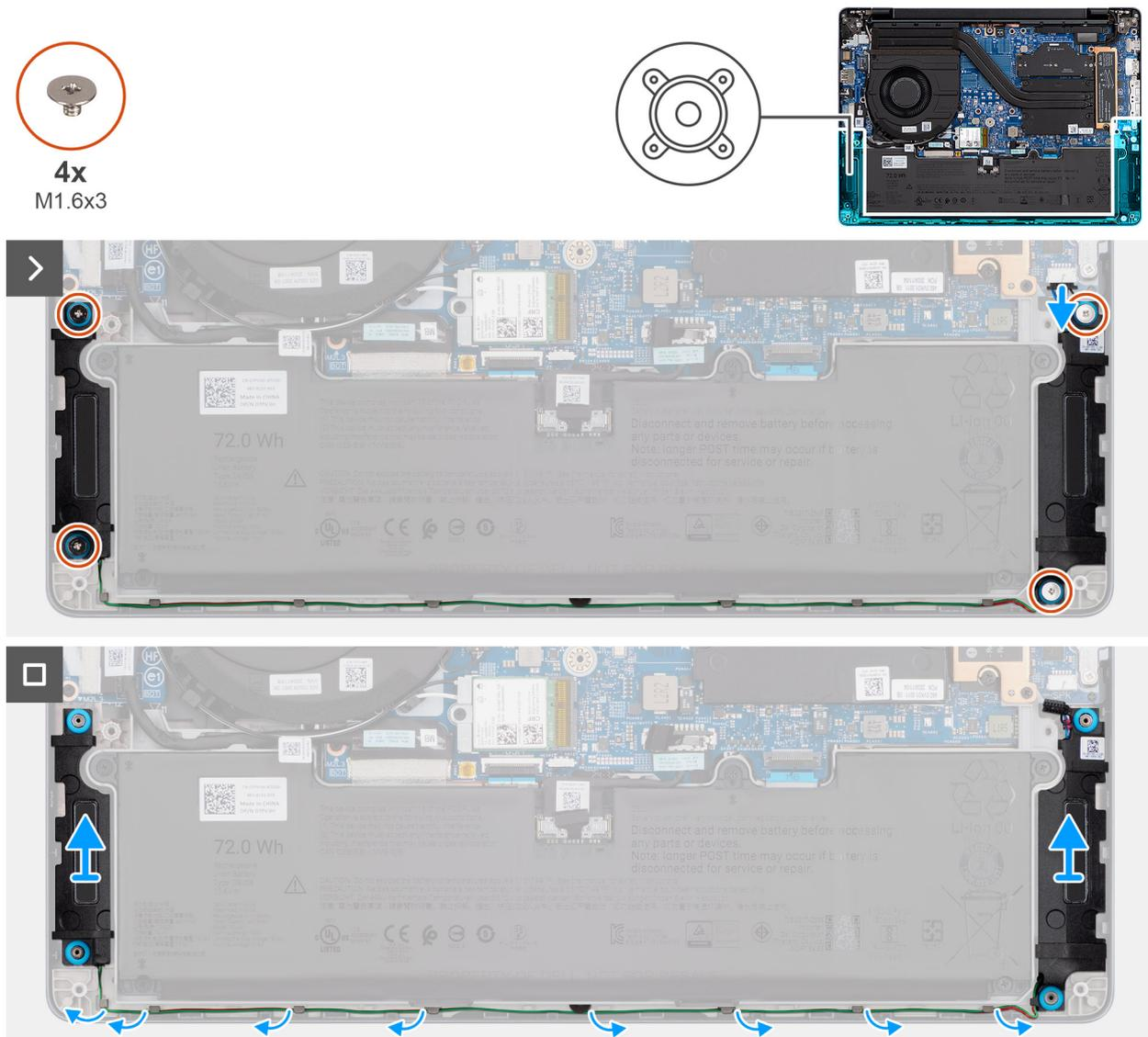
Figura 28. Rimozione degli altoparlanti
