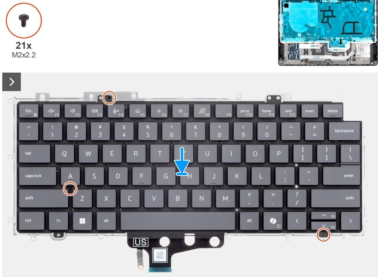
Figura 97. Installazione della tastiera
