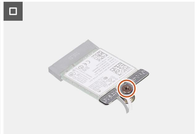
Figura 27. Installazione della scheda wireless
