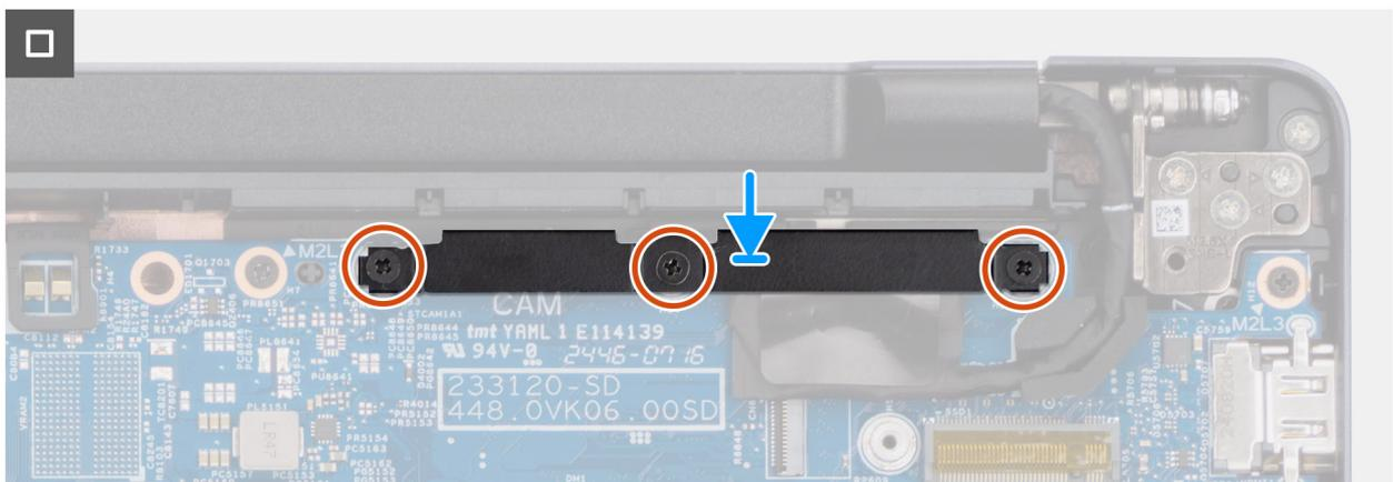
**Figura 85. Installazione della scheda di sistema**
