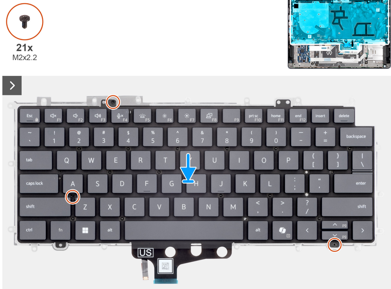
Figura 97. Installazione della tastiera
