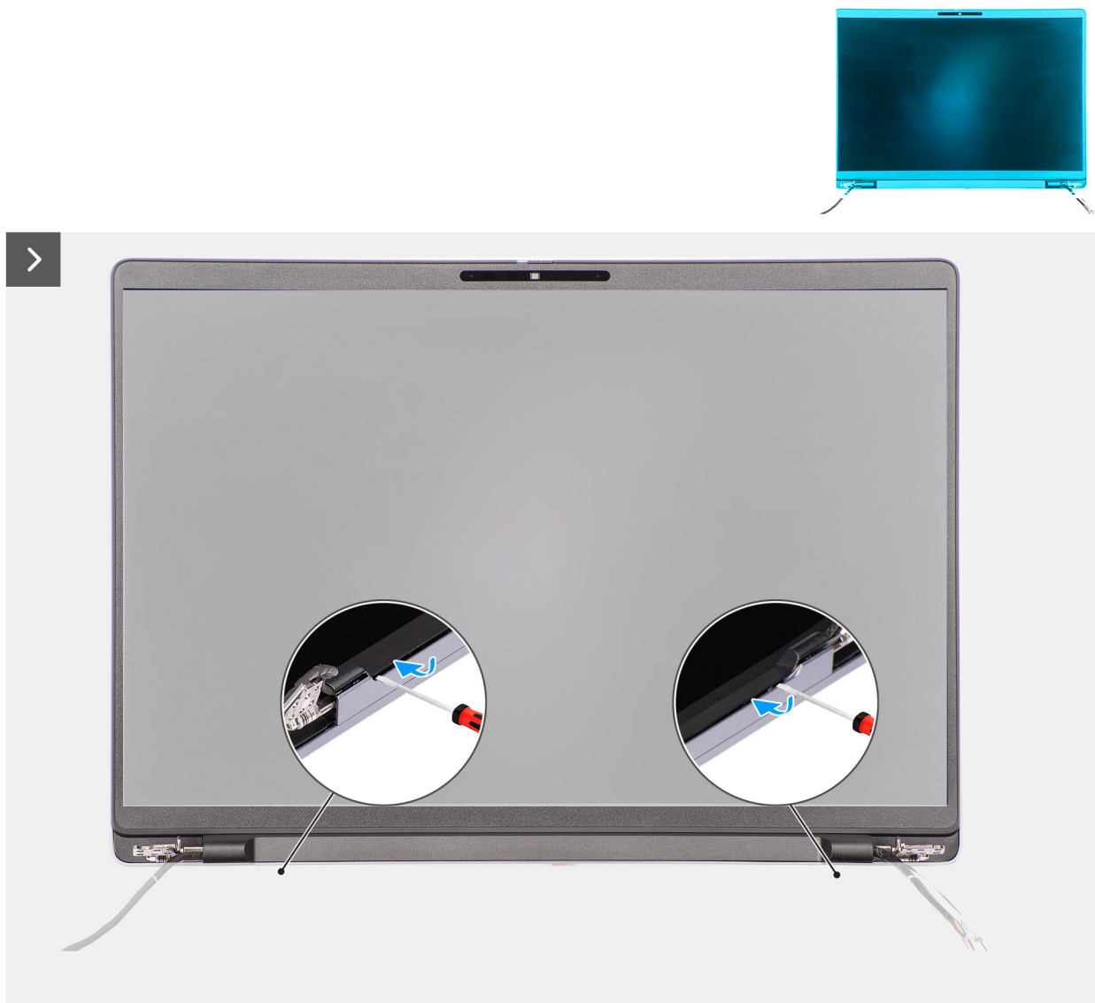
Figura 60. Rimozione della cornice del display
