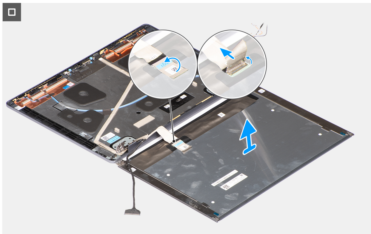
Figura 70. Rimozione del pannello del display
