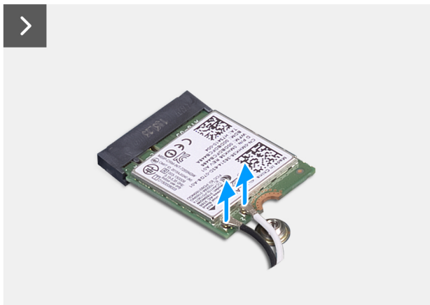
Figura 27. Rimozione della scheda wireless
