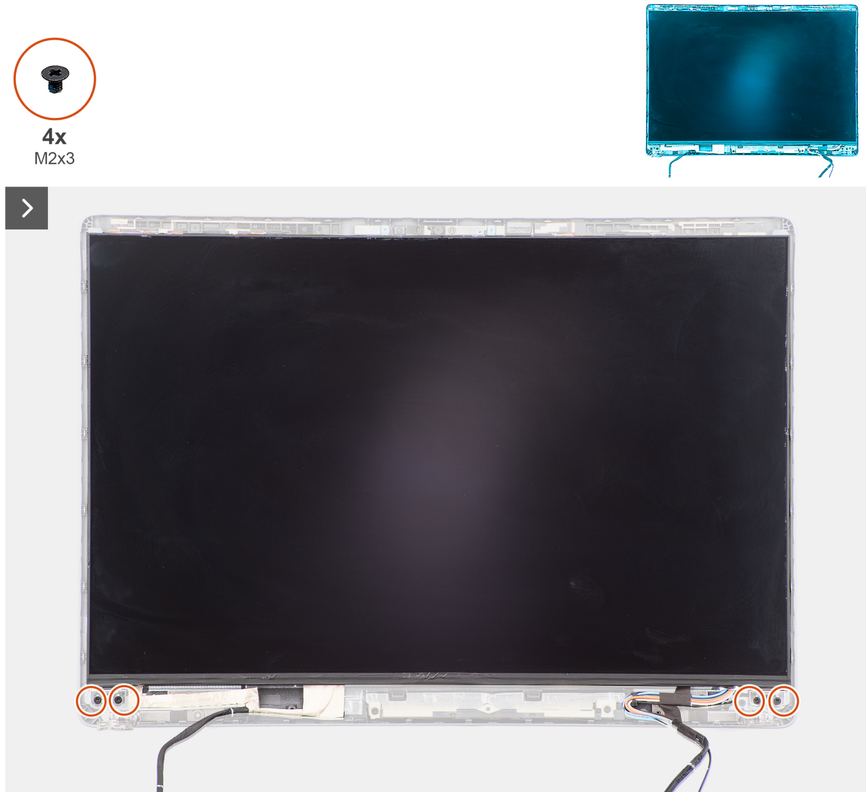
Figura 68. Rimozione del pannello del display
