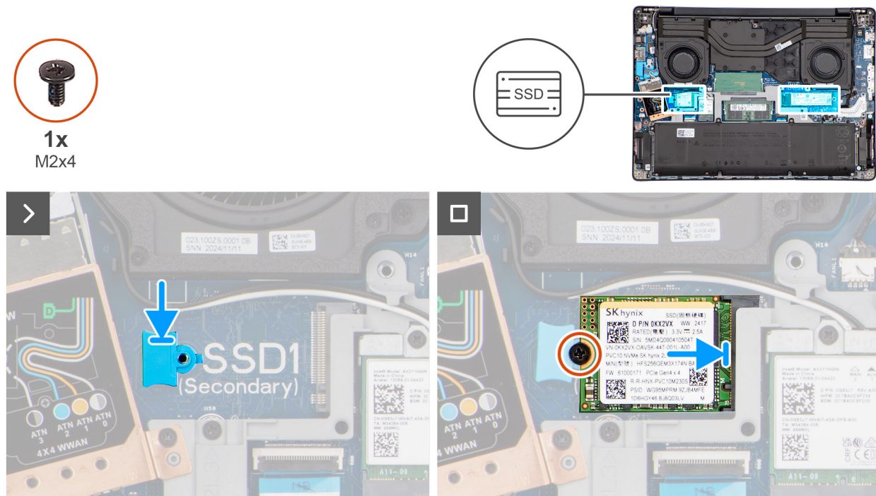
Figura 24. Installazione dell'unità SSD M.2 2230
