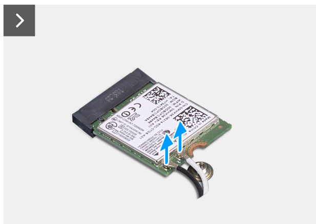
Figura 27. Rimozione della scheda wireless
