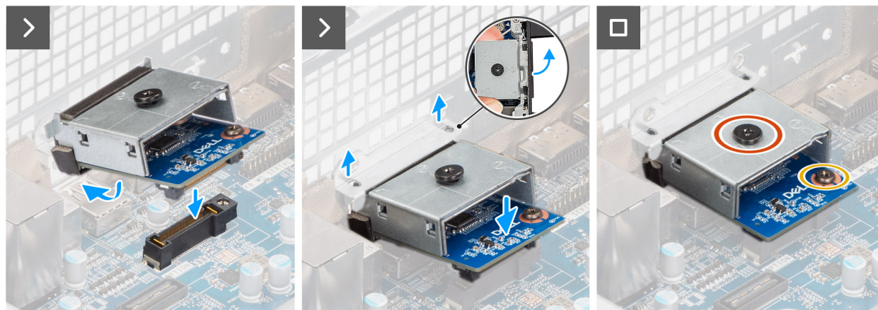
Figura 75. Installare il modulo HDMI opzionale.
