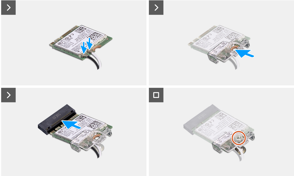
Figura 42. Installazione della scheda wireless
