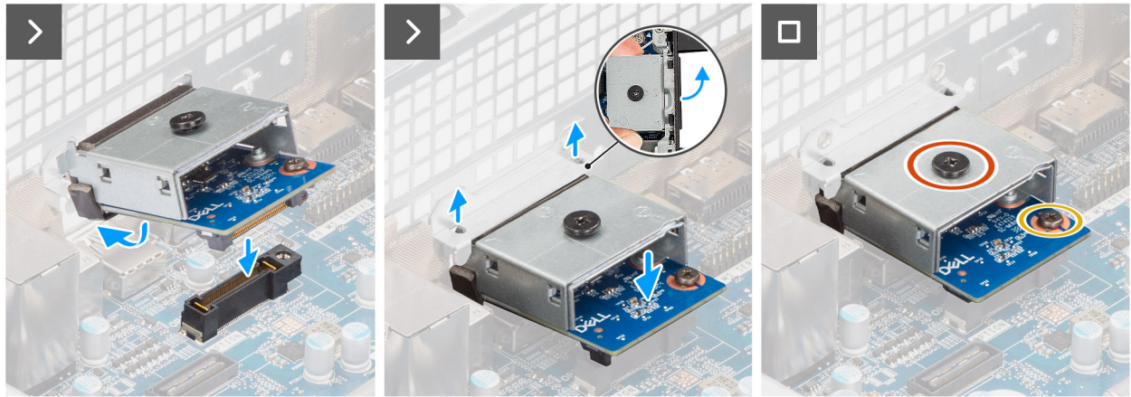
Figura 63. Installare il modulo VGA opzionale.
