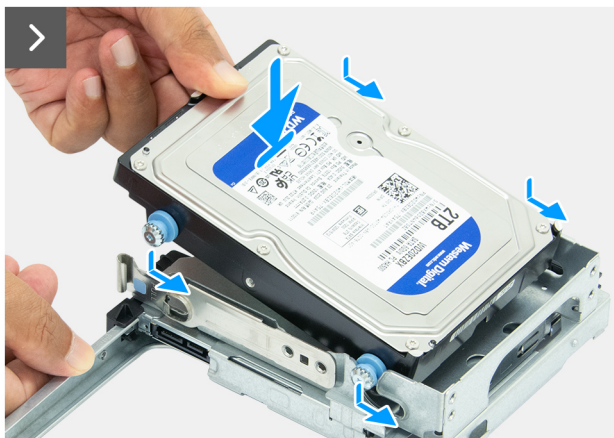
Figura 30. Installazione del disco rigido
