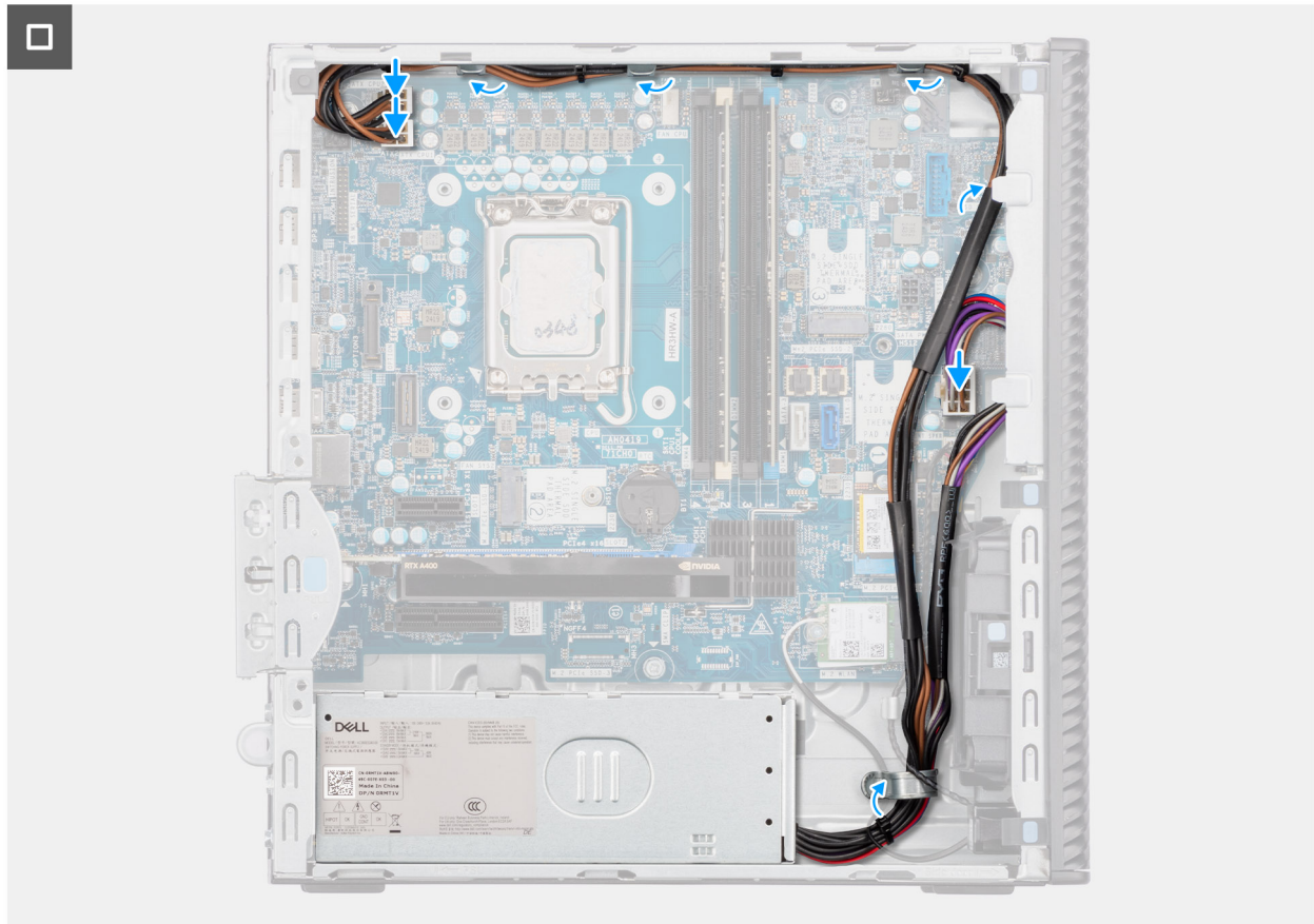
Figura 60. Installazione dell'unità di alimentazione
