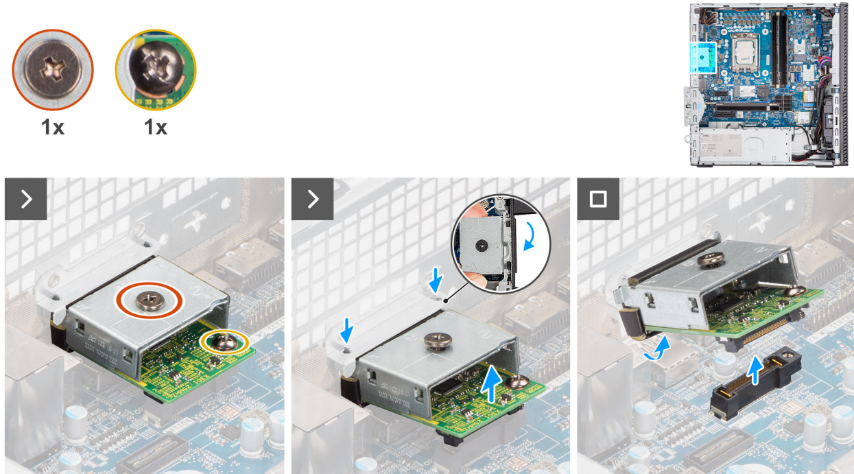
Figura 76. Rimozione del modulo DisplayPort opzionale
