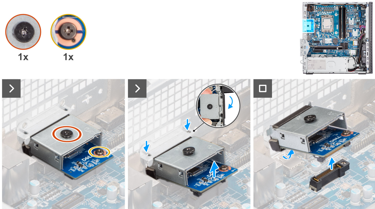
Figura 73. Rimozione del modulo HDMI opzionale
