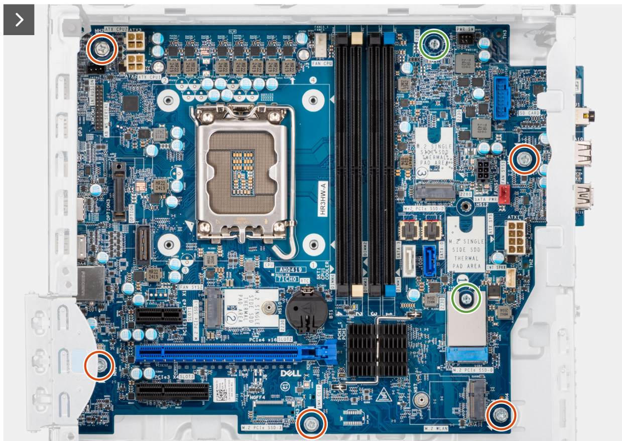
Figura 89. Installazione della scheda di sistema
