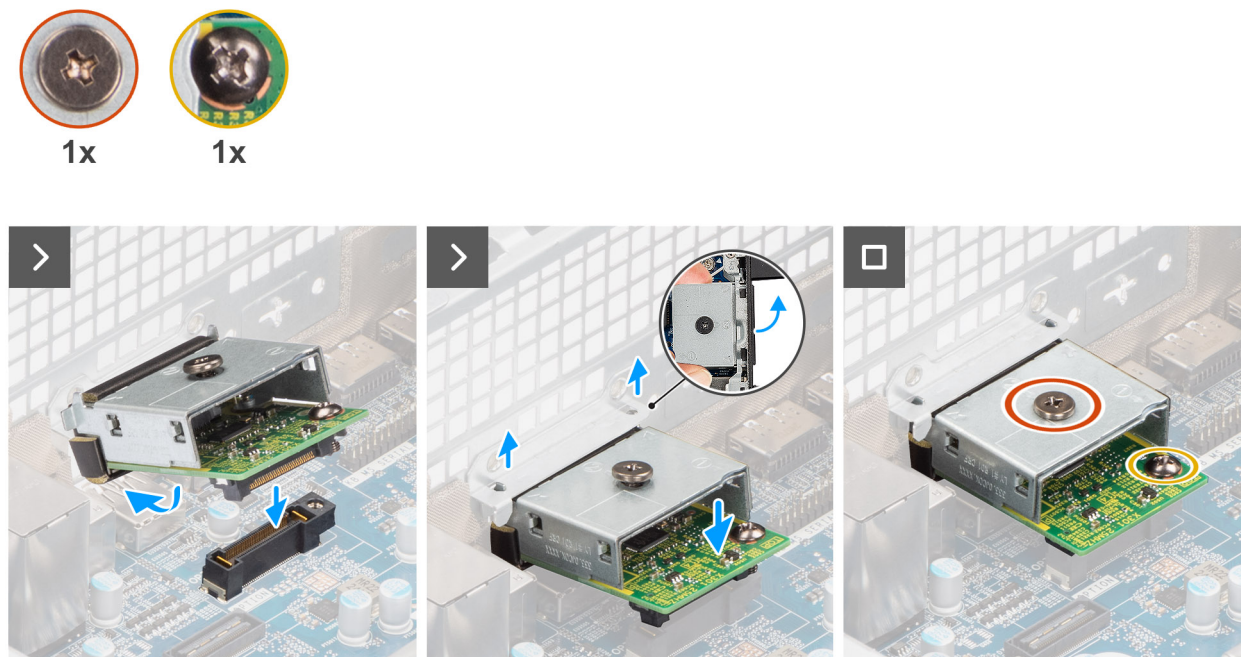
Figura 78. Installare il modulo DisplayPort opzionale.
