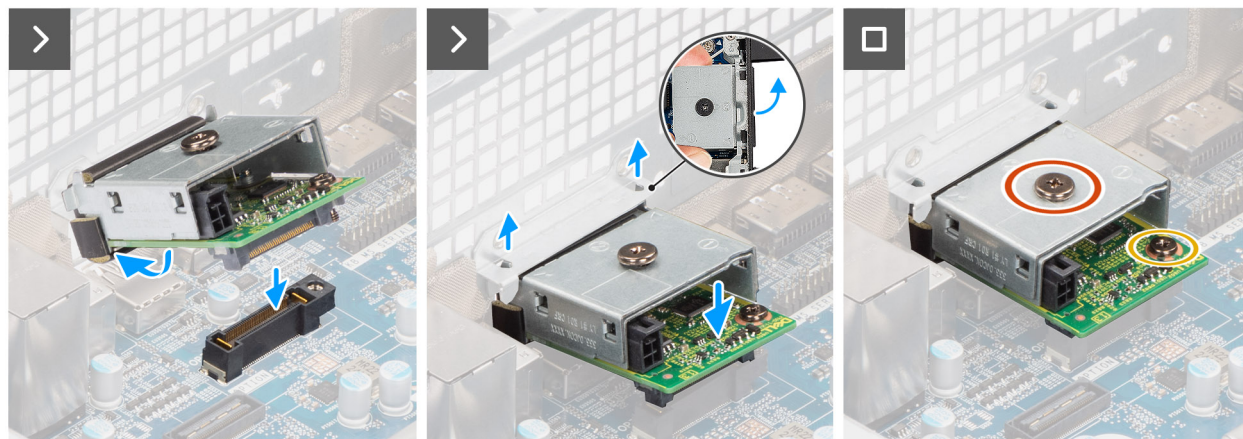
Figura 66. Installare il modulo USB opzionale.
