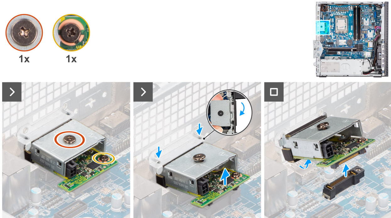
Figura 67. Rimozione del modulo Thunderbolt opzionale
