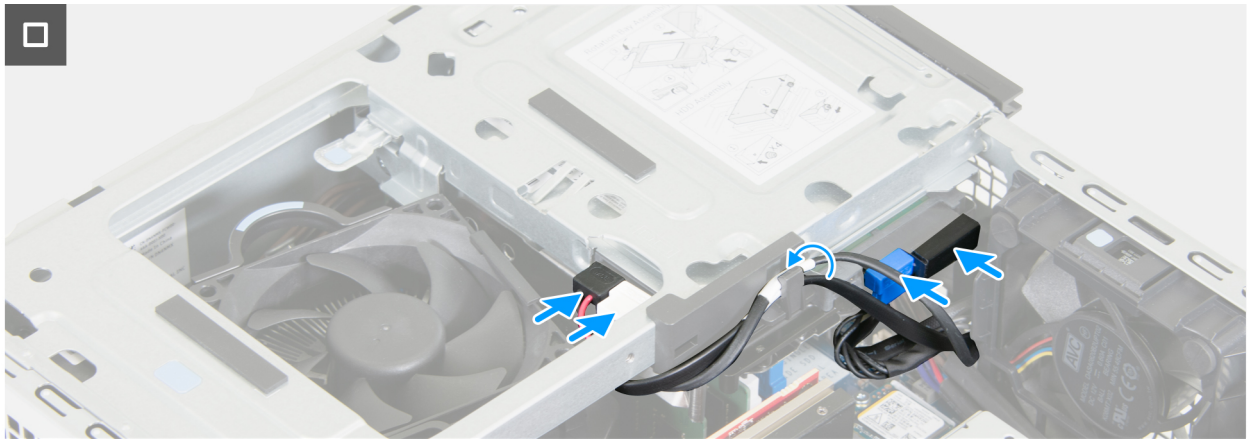
Figura 24. Installazione del drive bay
