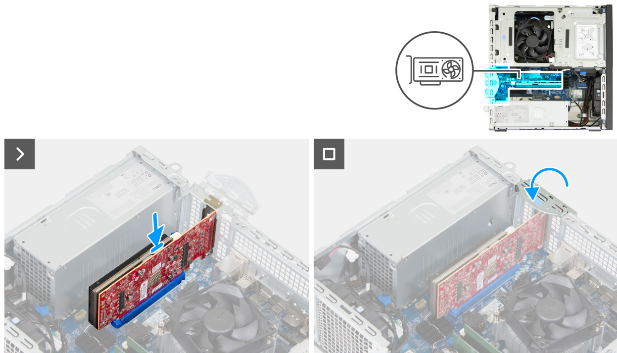
Figura 40. Installazione della scheda grafica
