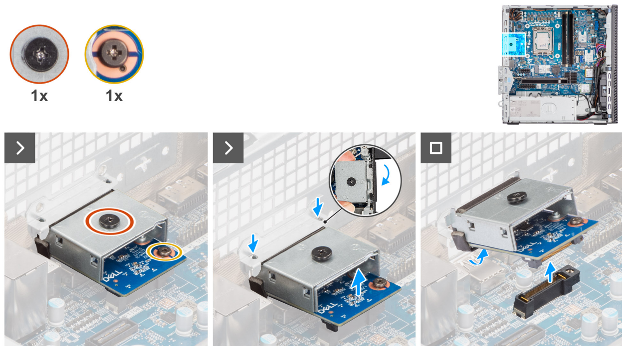
Figura 61. Rimozione del modulo VGA opzionale
