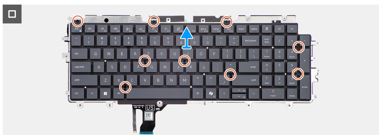
Figura 99. Rimozione della tastiera
