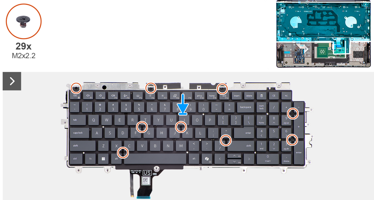
Figura 100. Installazione della tastiera
