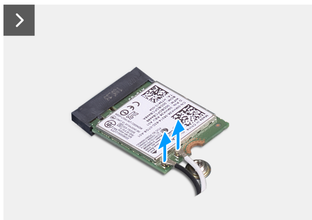
Figura 27. Rimozione della scheda wireless
