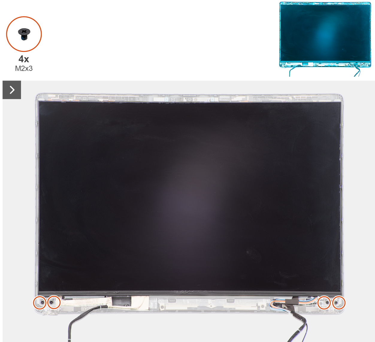
Figura 68. Rimozione del pannello del display
