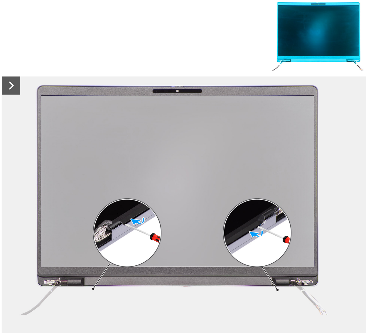
Figura 60. Rimozione della cornice del display
