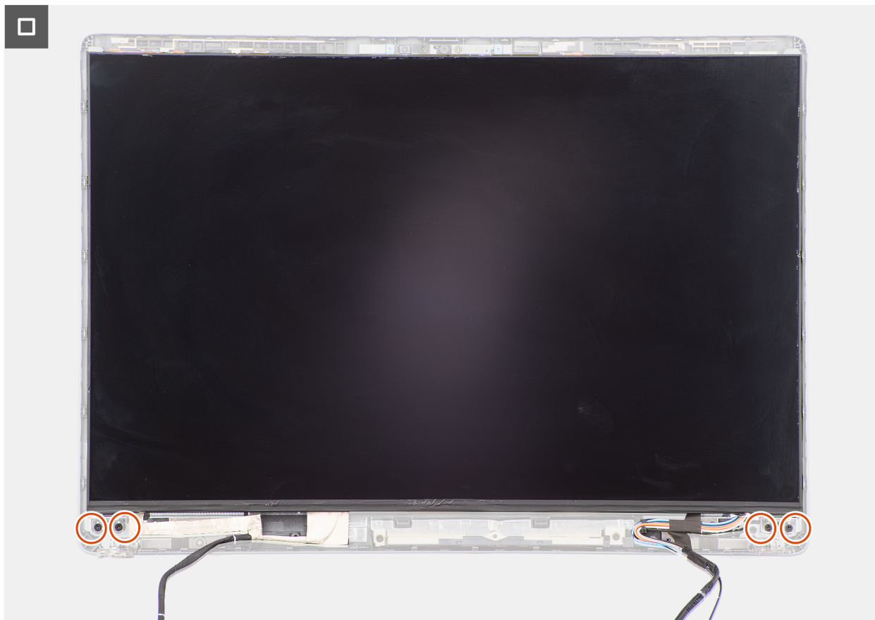
Figura 73. Installazione del pannello del display
