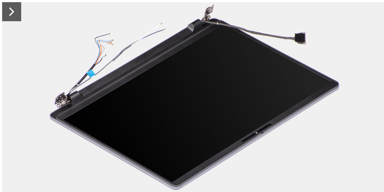
Figura 57. Installazione del gruppo del display
