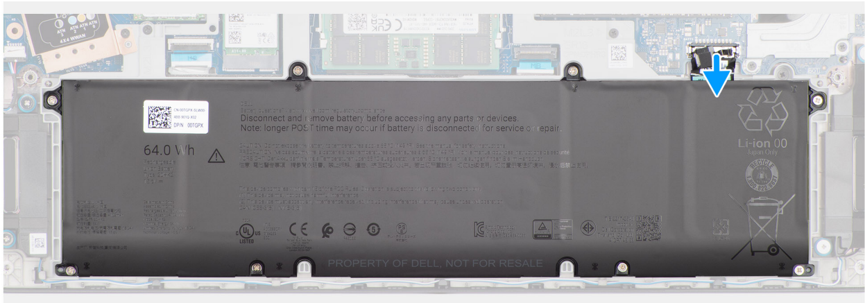
Figura 14. Rimozione del cavo della batteria
