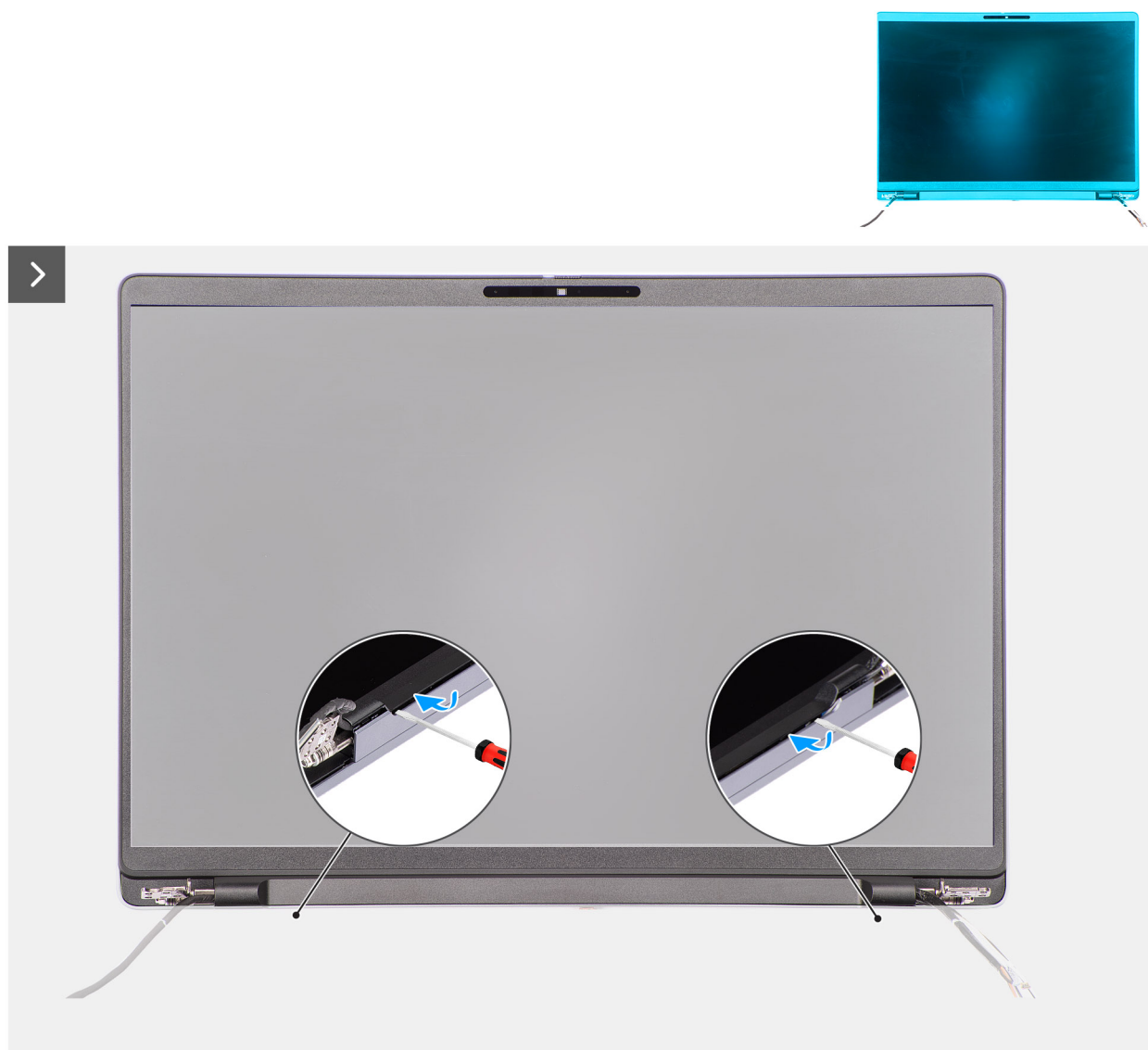
Figura 60. Rimozione della cornice del display
