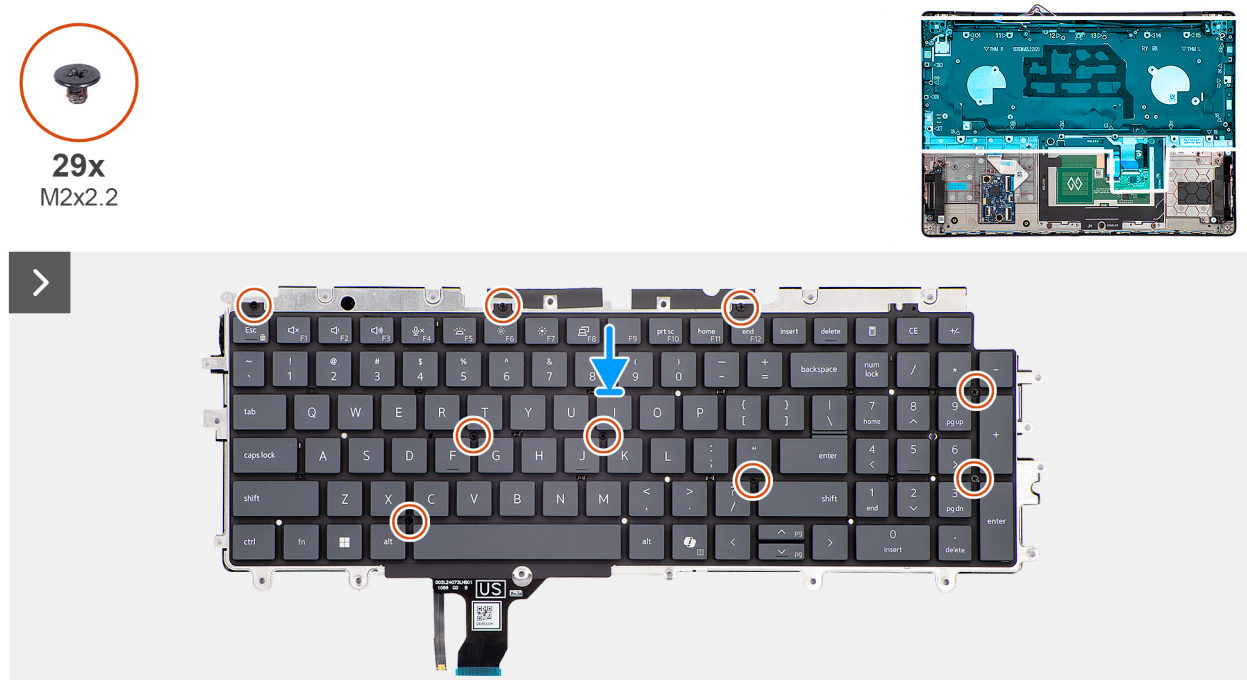
Figura 100. Installazione della tastiera
