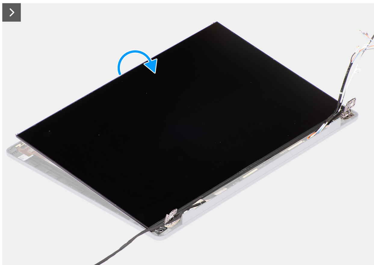
Figura 69. Rimozione del pannello del display
