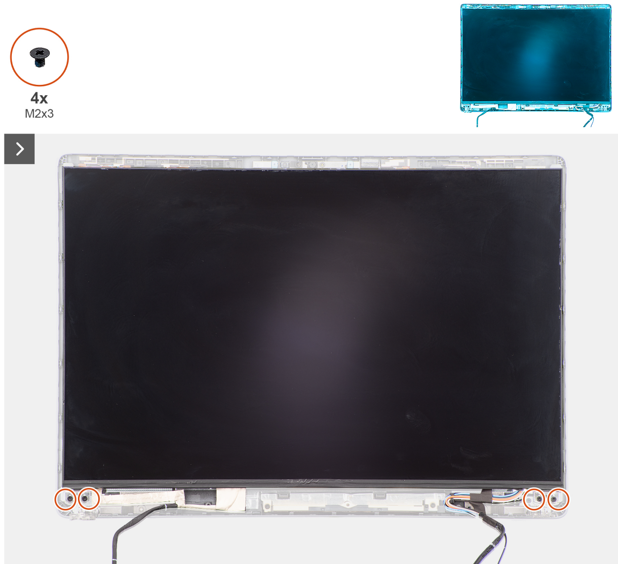
Figura 68. Rimozione del pannello del display
