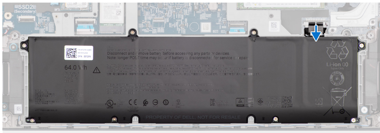
Figura 14. Rimozione del cavo della batteria
