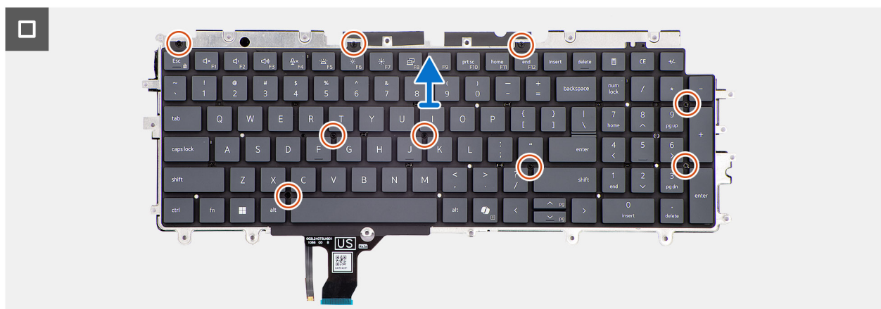
Figura 84. Rimozione della tastiera
