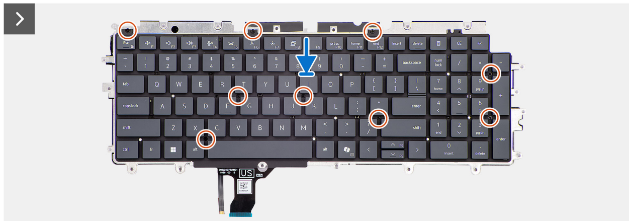
Figura 85. Installazione della tastiera
