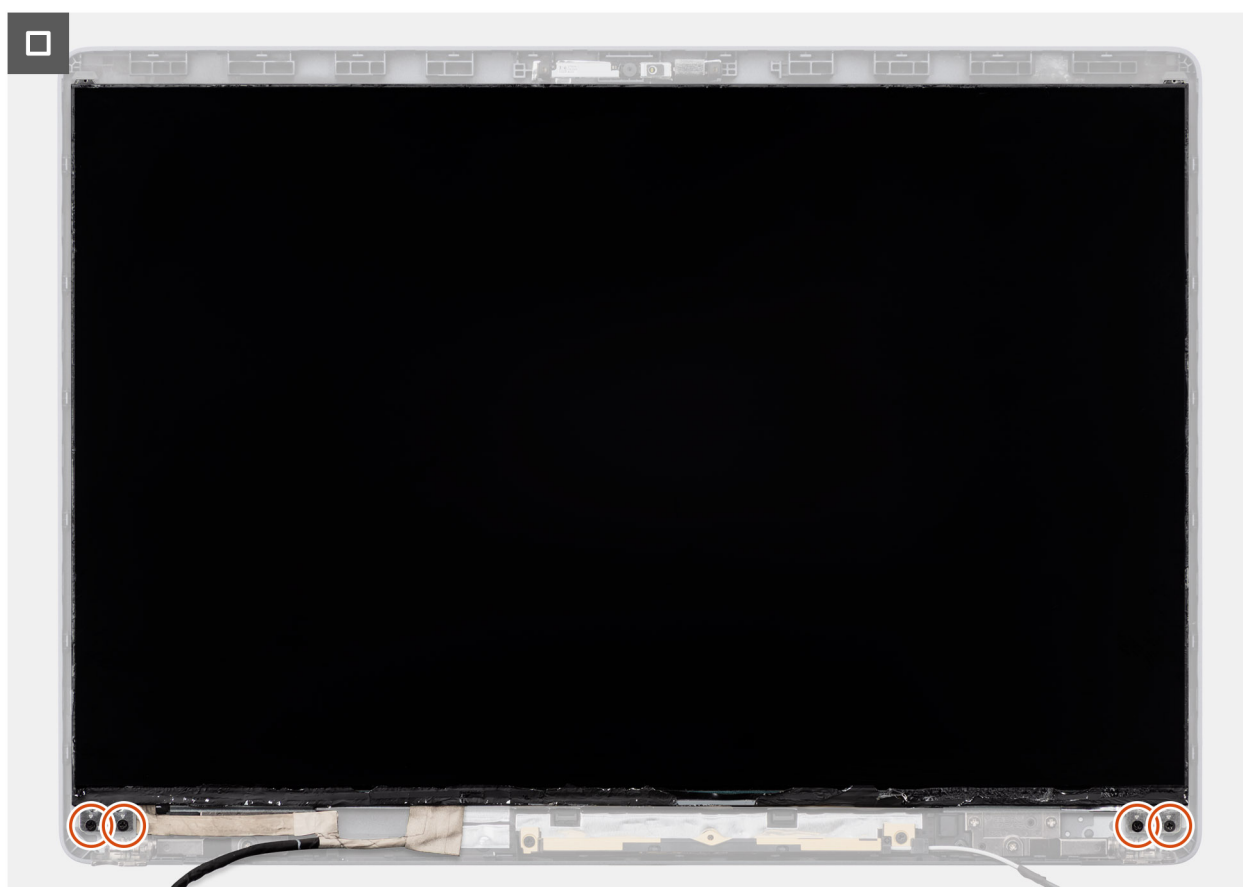
Figura 64. Installazione del pannello del display
