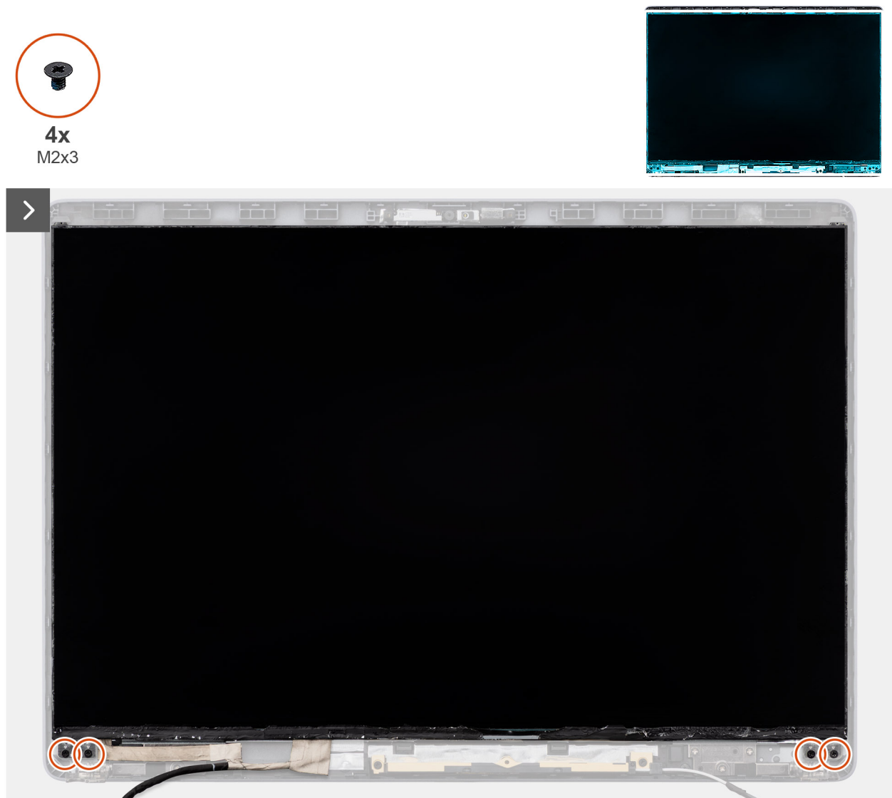
Figura 58. Rimozione del pannello del display
