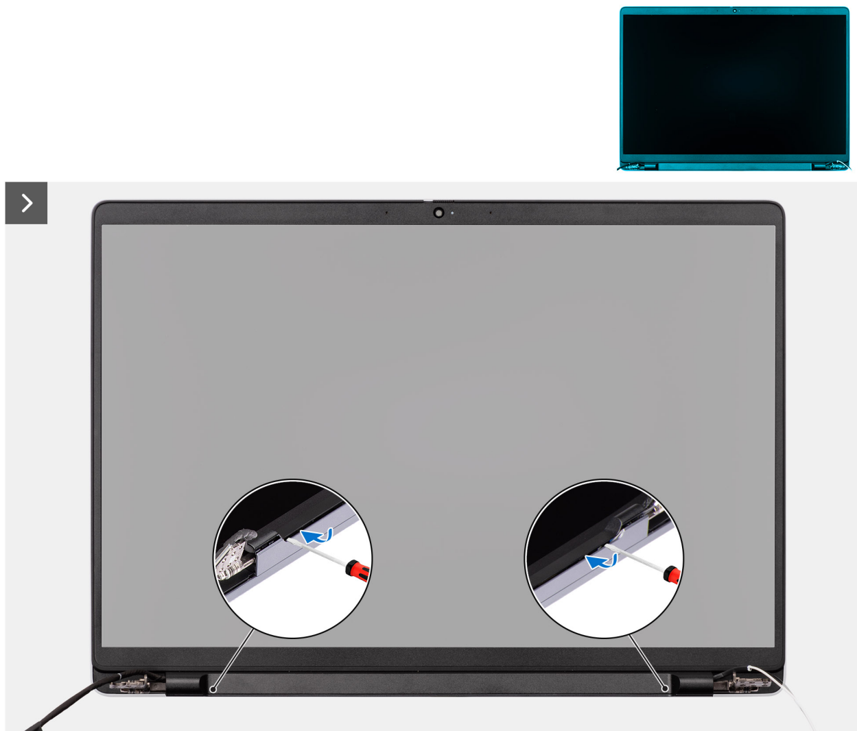
Figura 50. Rimozione della cornice del display
