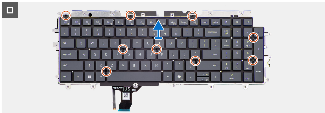
Figura 84. Rimozione della tastiera
