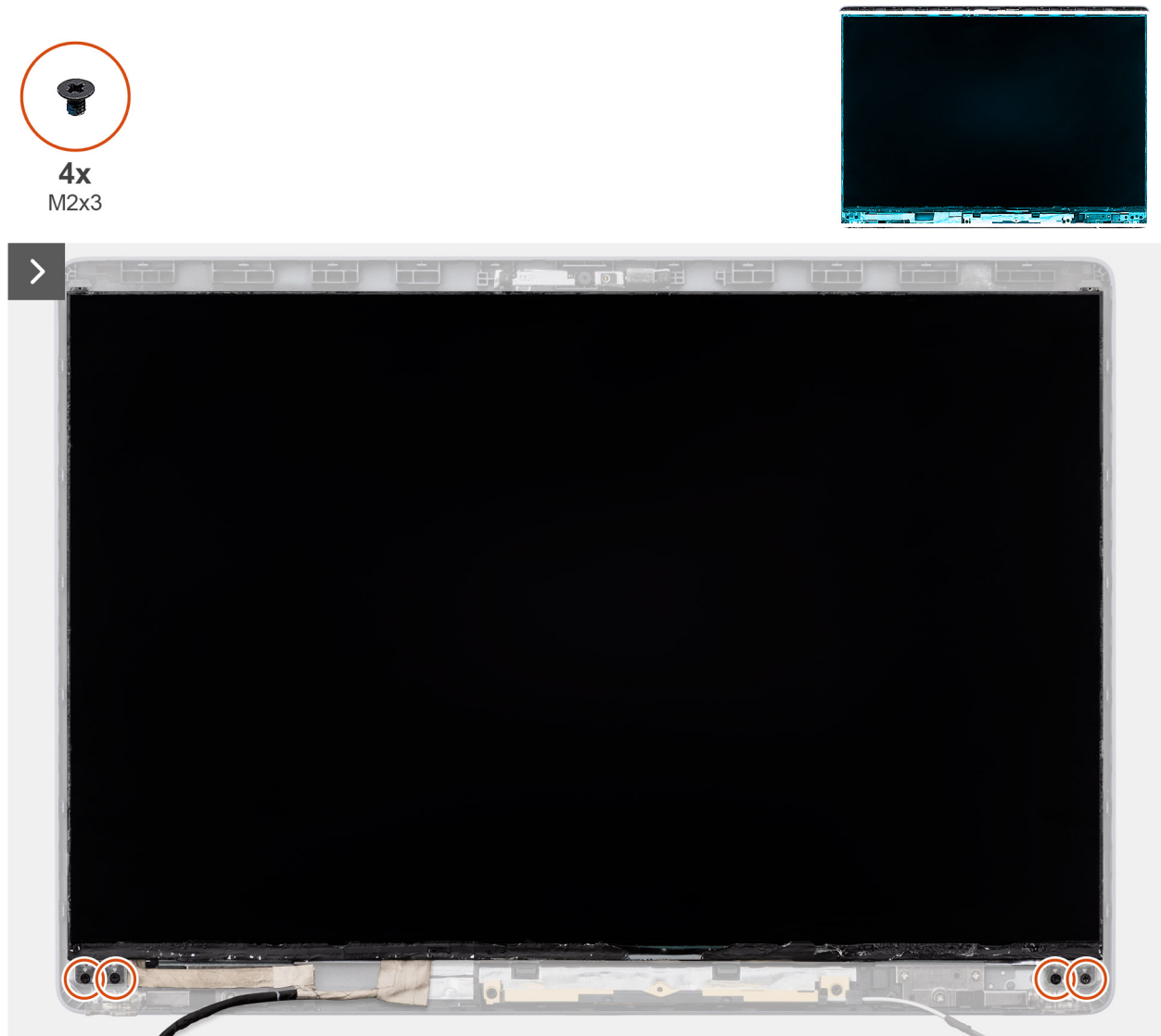
Figura 58. Rimozione del pannello del display
