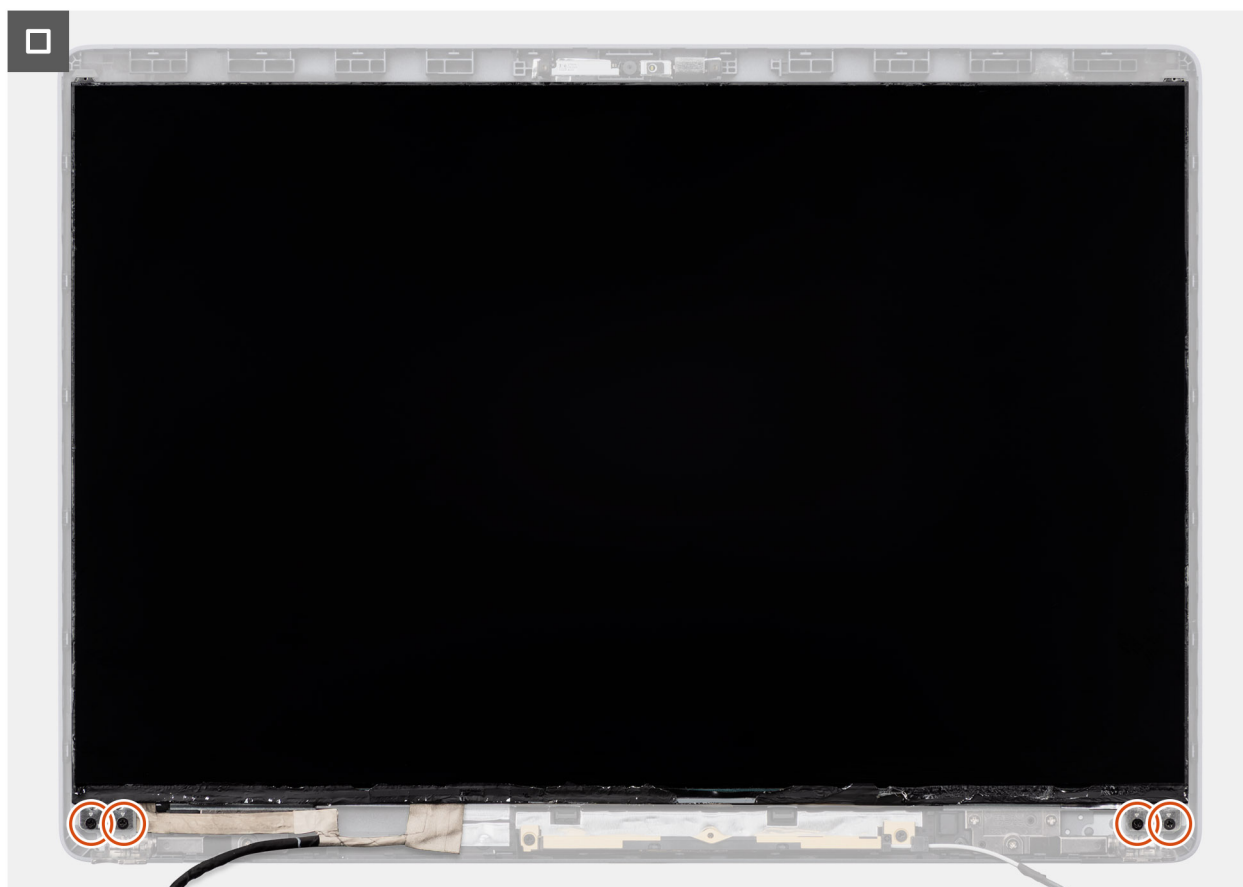
Figura 64. Installazione del pannello del display
