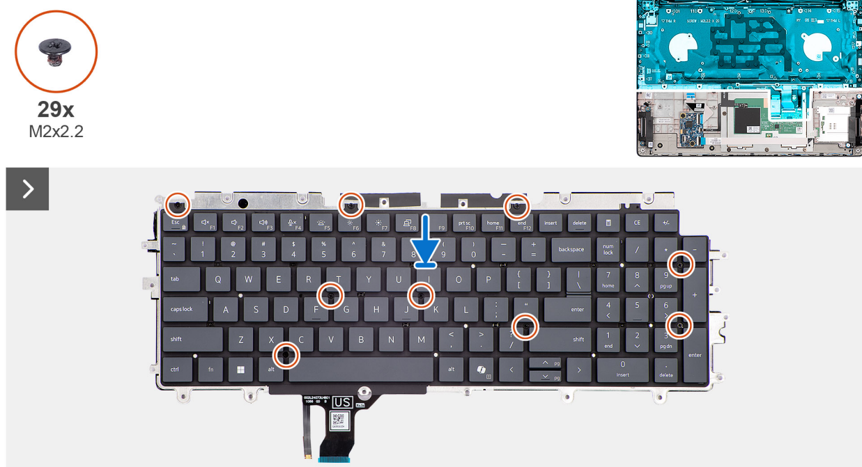
Figura 85. Installazione della tastiera
