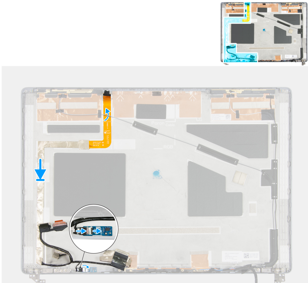
Figura 108. Installazione del cavo del display
