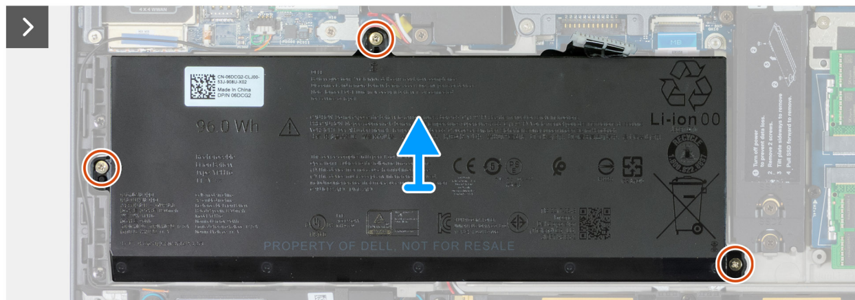
Figura 40. Rimozione della batteria
