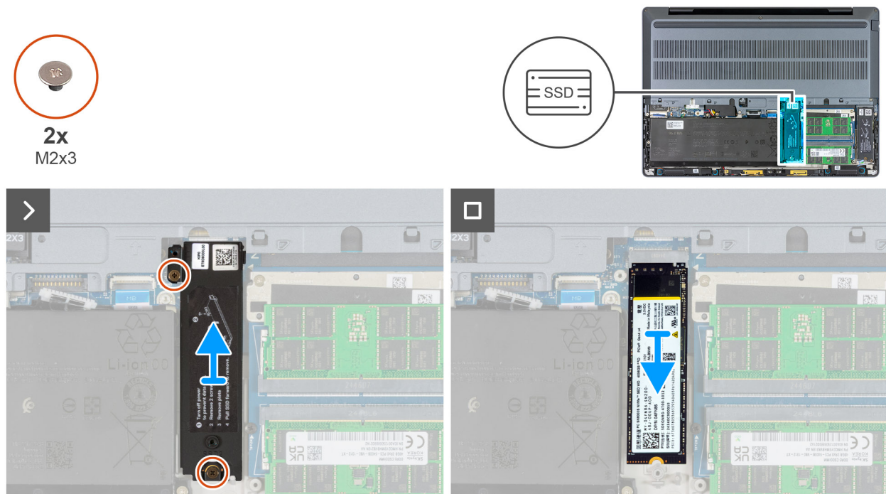
Figura 36. Rimozione dell'SSD M.2 2280 dallo slot 2 (SSD2)
