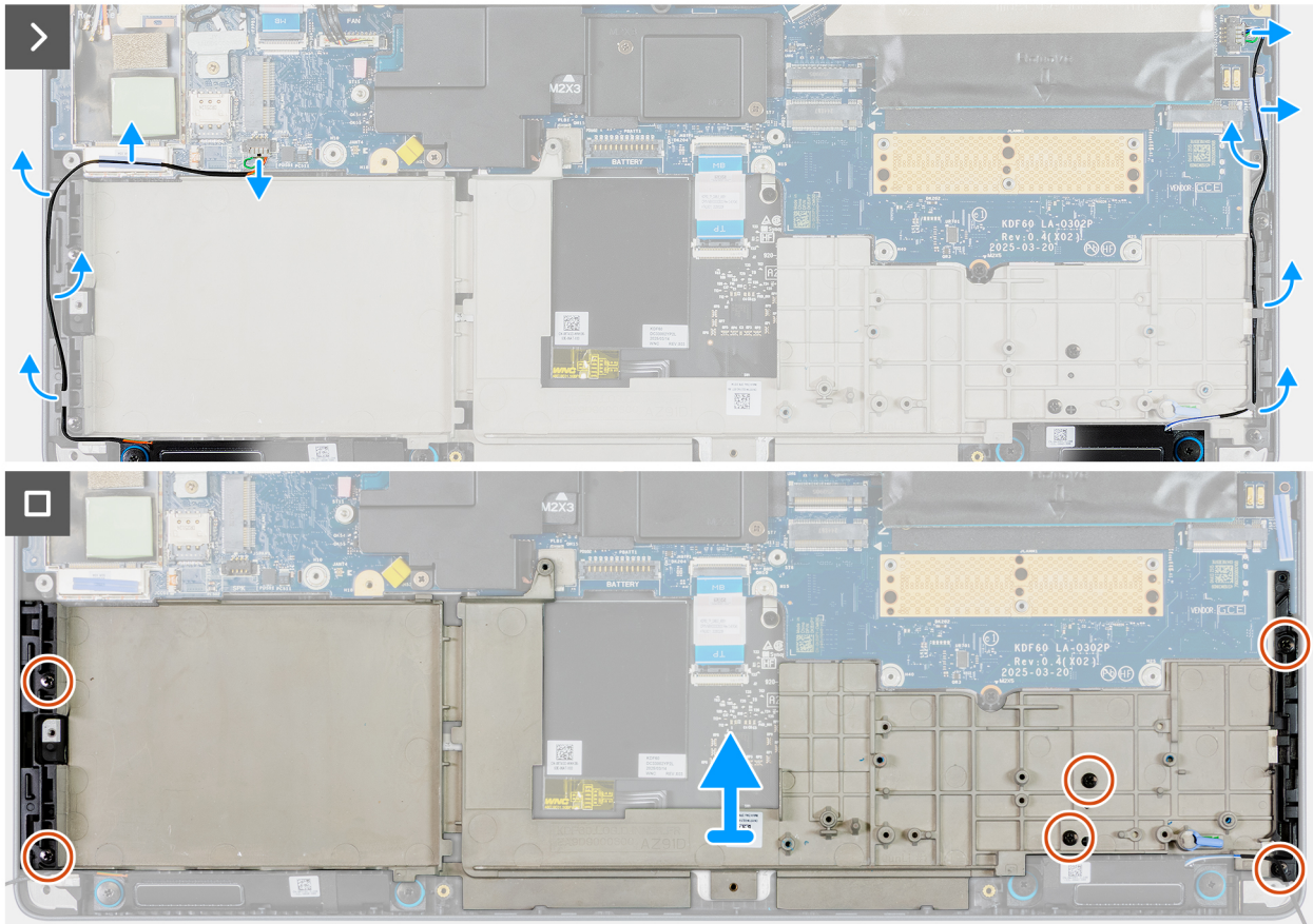
Figura 82. Rimozione dell'intelaiatura interna
