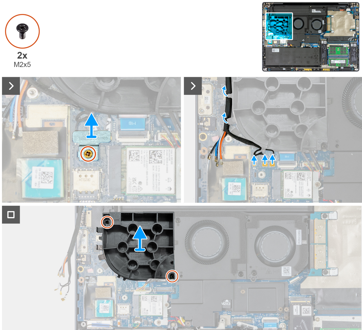
Figura 57. Rimozione della ventola fittizia
