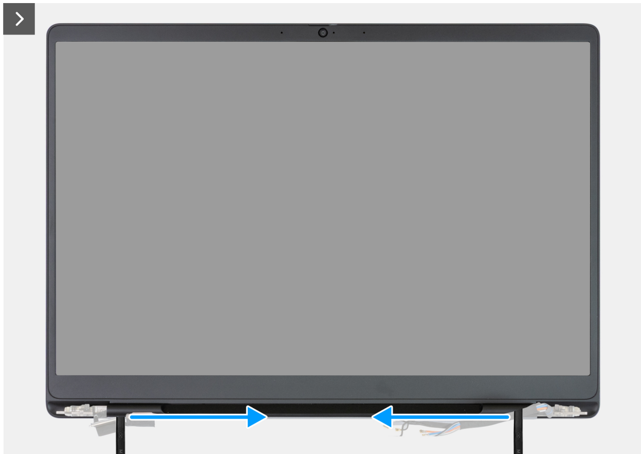
Figura 86. Rimozione della cornice del display
