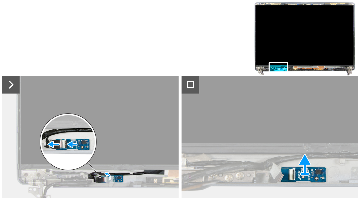
Figura 101. Rimozione della scheda sensore
