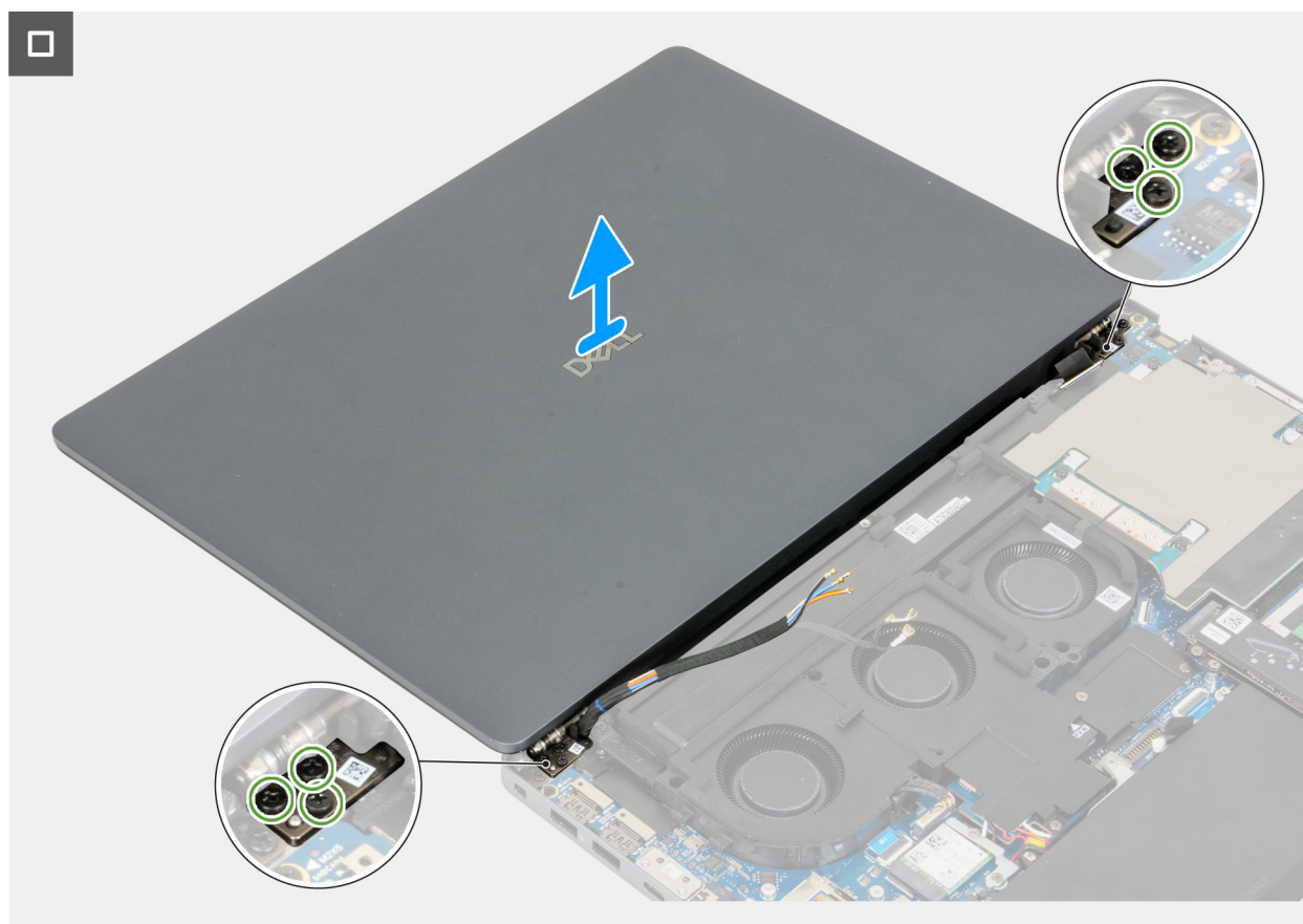
Figura 64. Rimozione del gruppo del display
