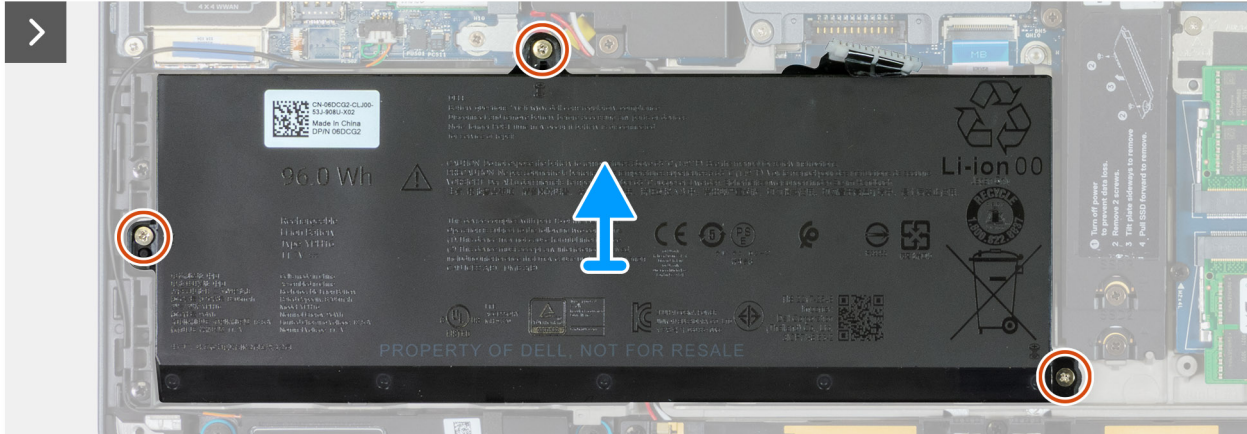
Figura 42. Rimozione della batteria
