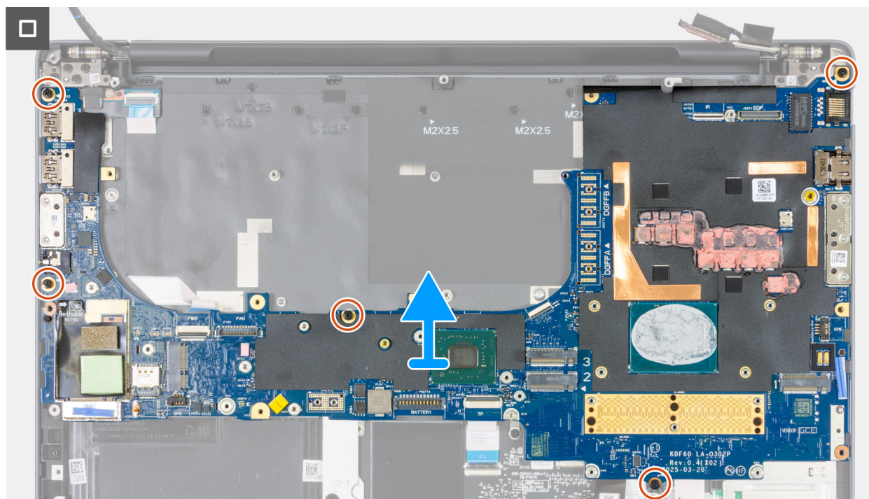
Figura 112. Rimozione della scheda di sistema
