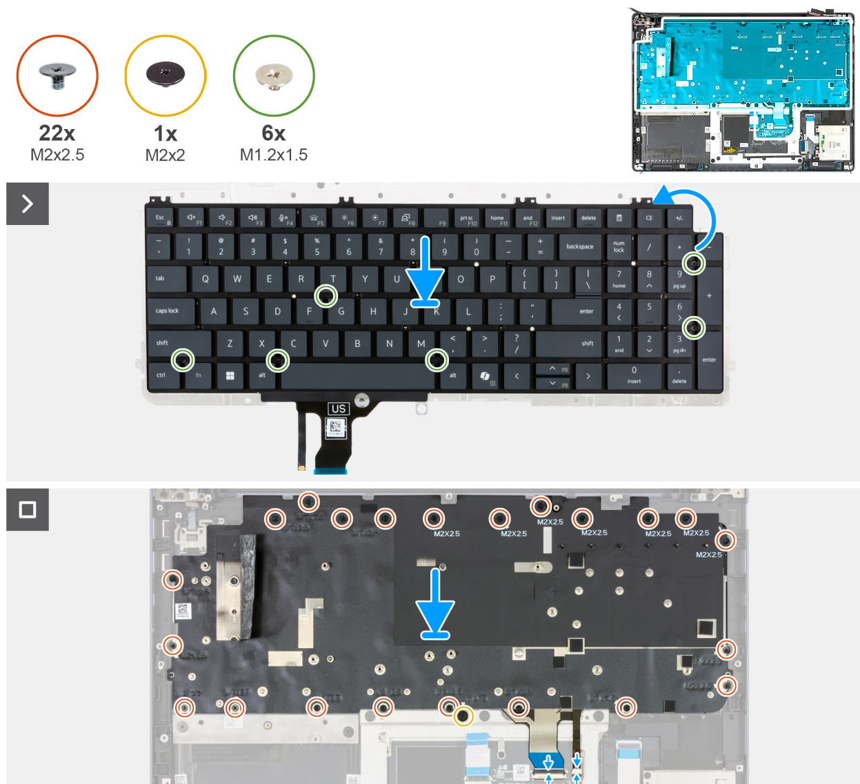
Figura 122. Installazione della tastiera
