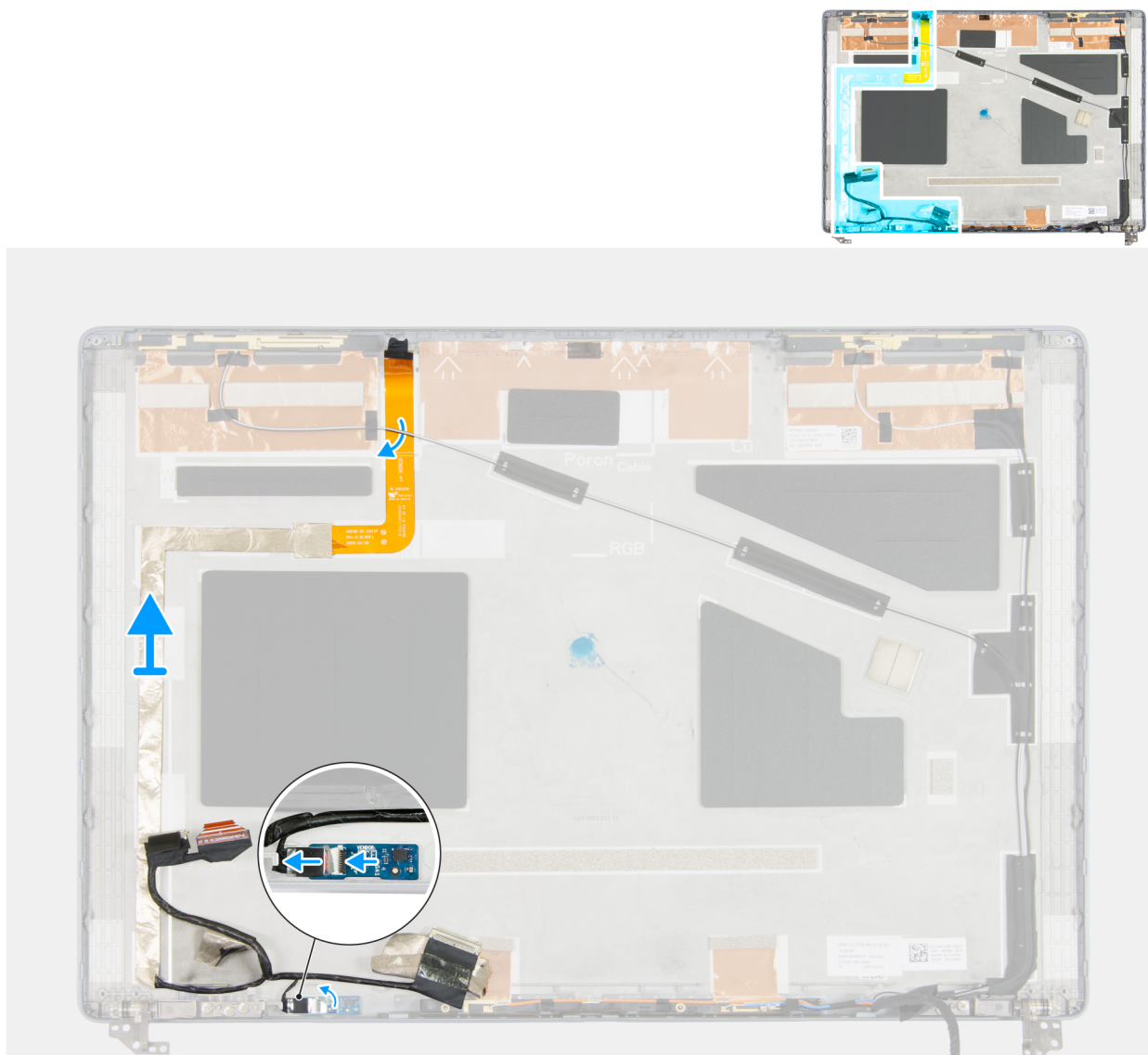
Figura 106. Rimozione del cavo del display
