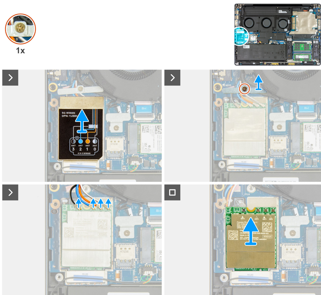
Figura 50. Rimozione della scheda WWAN
