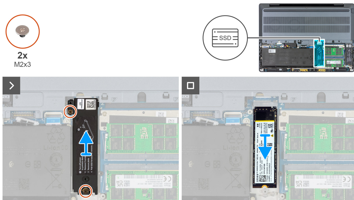
Figura 36. Rimozione dell'SSD M.2 2280 dallo slot 2 (SSD2)
