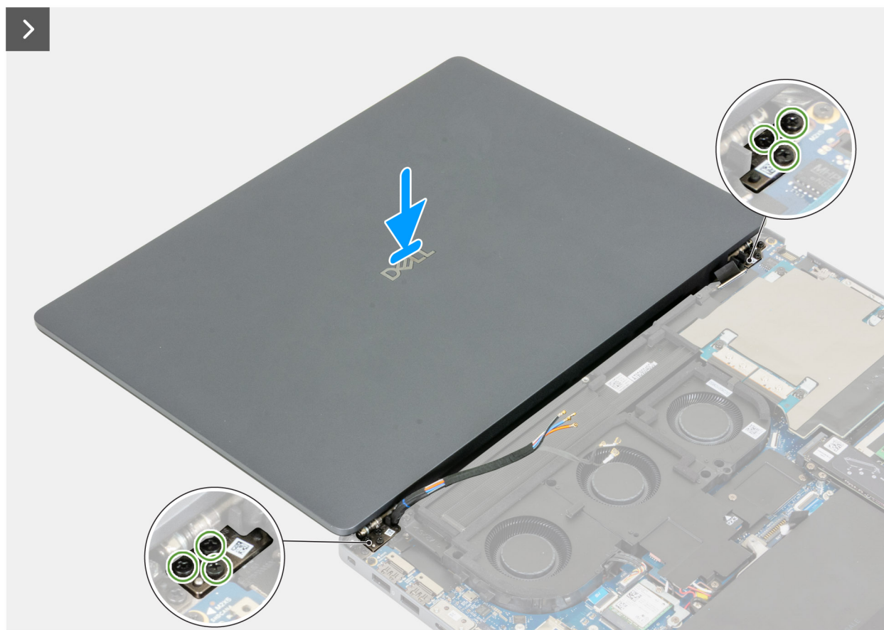
Figura 68. Installazione del gruppo del display
