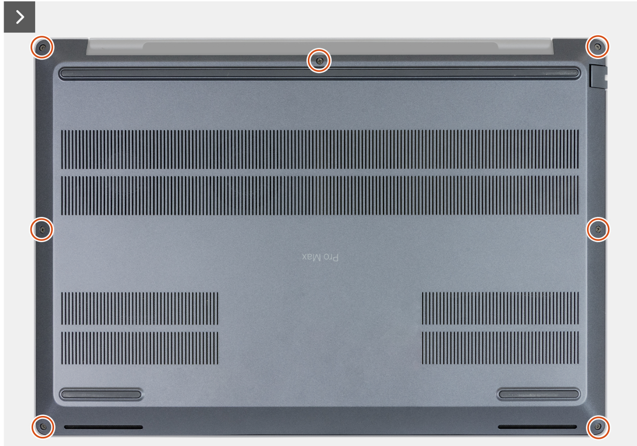
Figura 24. Allentamento delle viti di fissaggio
