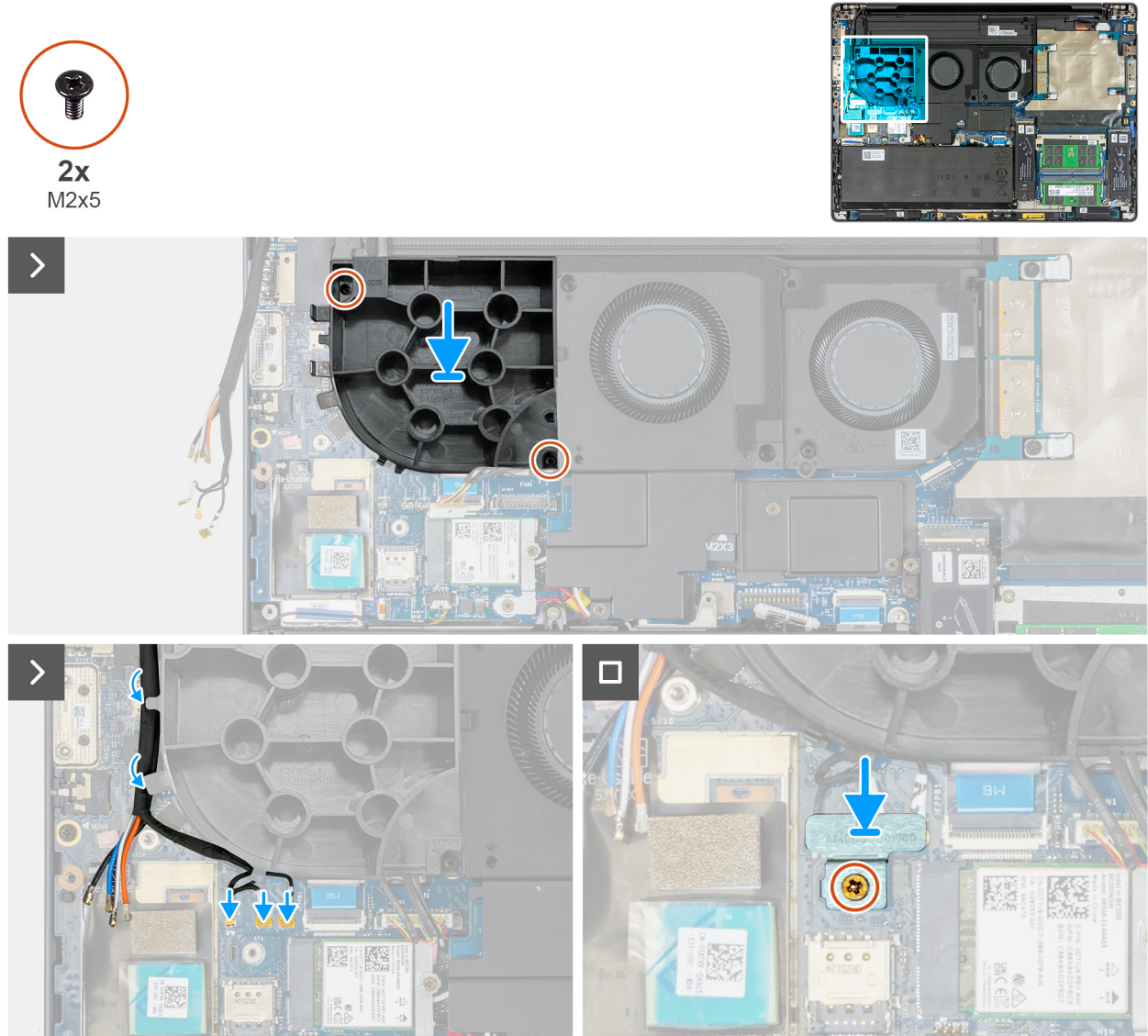
Figura 58. Installazione della ventola fittizia
