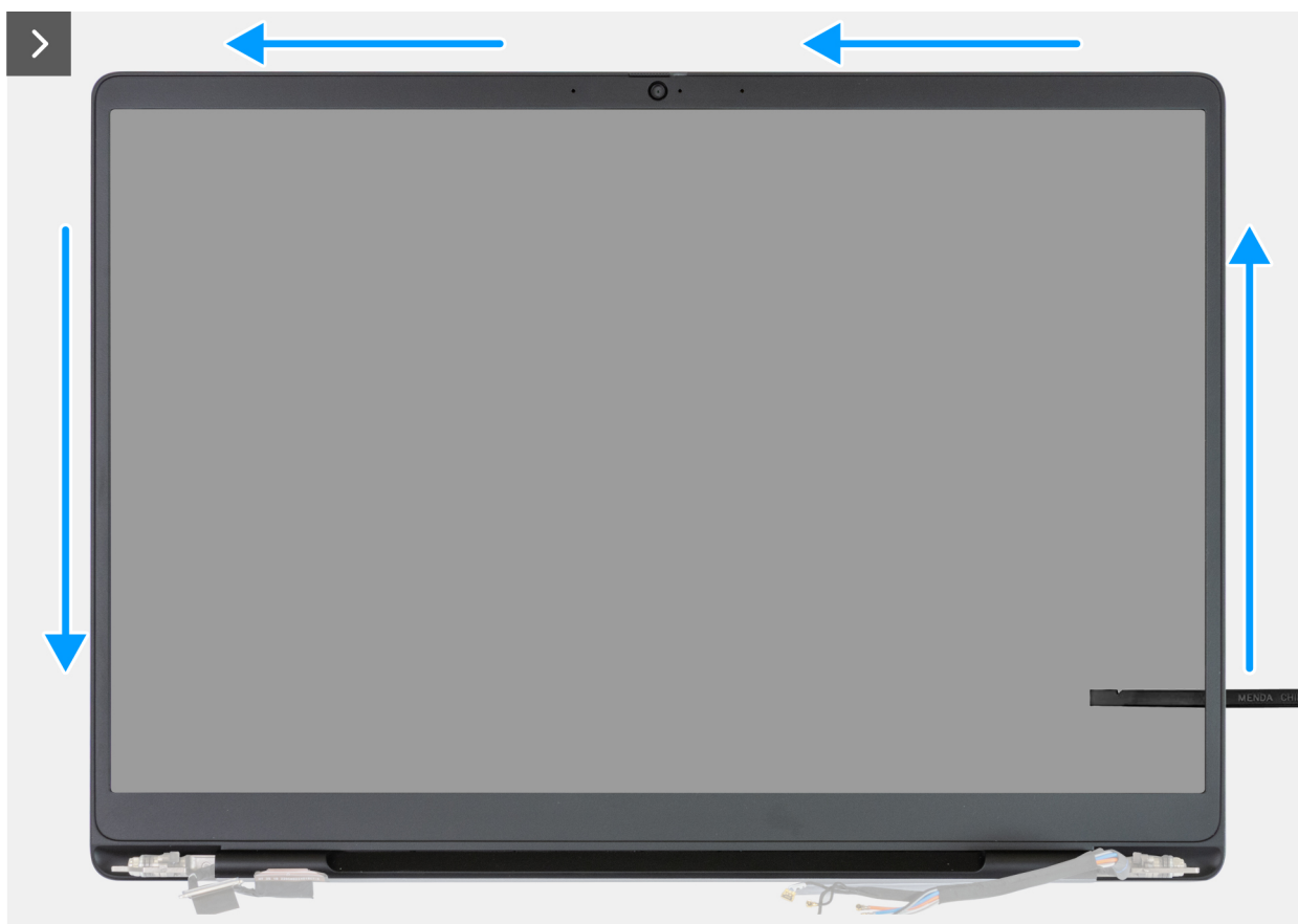
Figura 88. Rimozione della cornice del display
