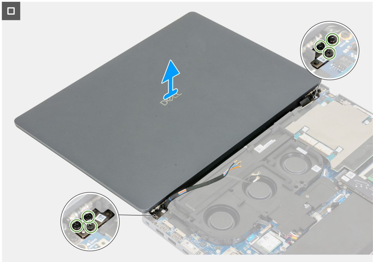
Figura 67. Rimozione del gruppo del display
