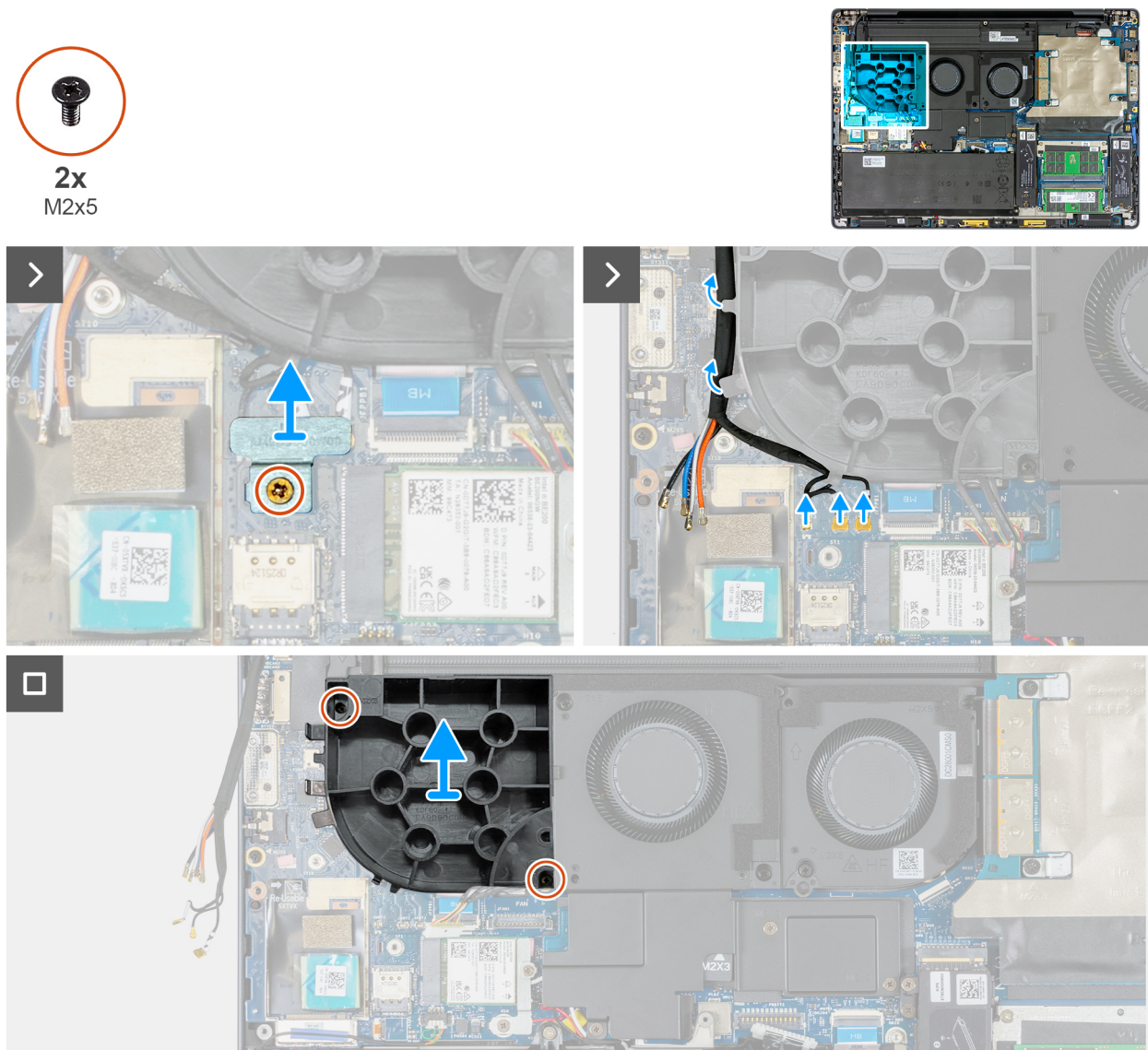
Figura 57. Rimozione della ventola fittizia
