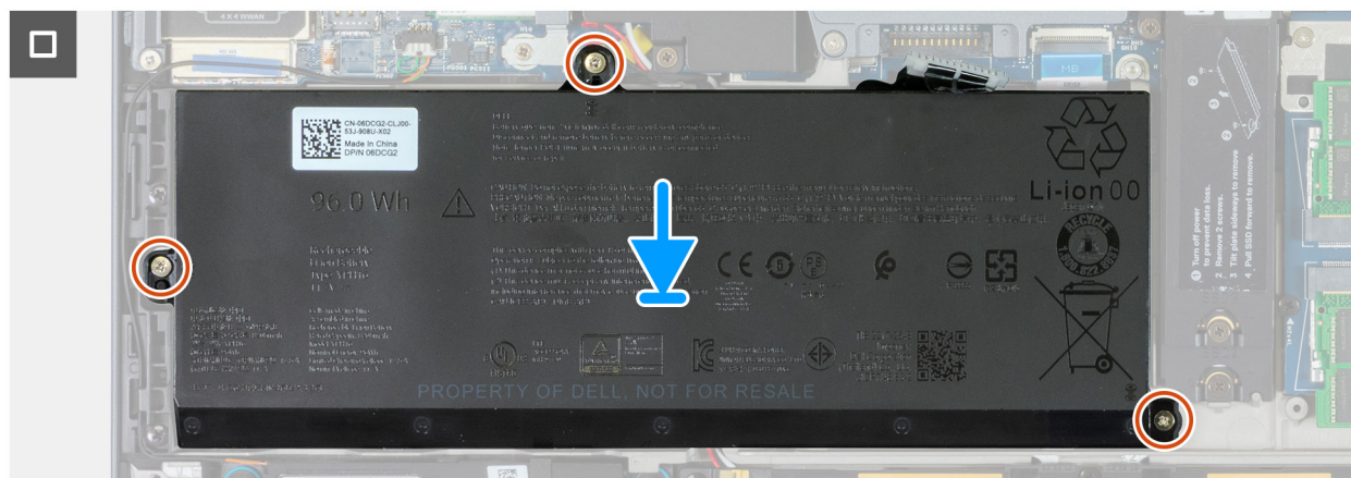
Figura 45. Ricollocamento della batteria
