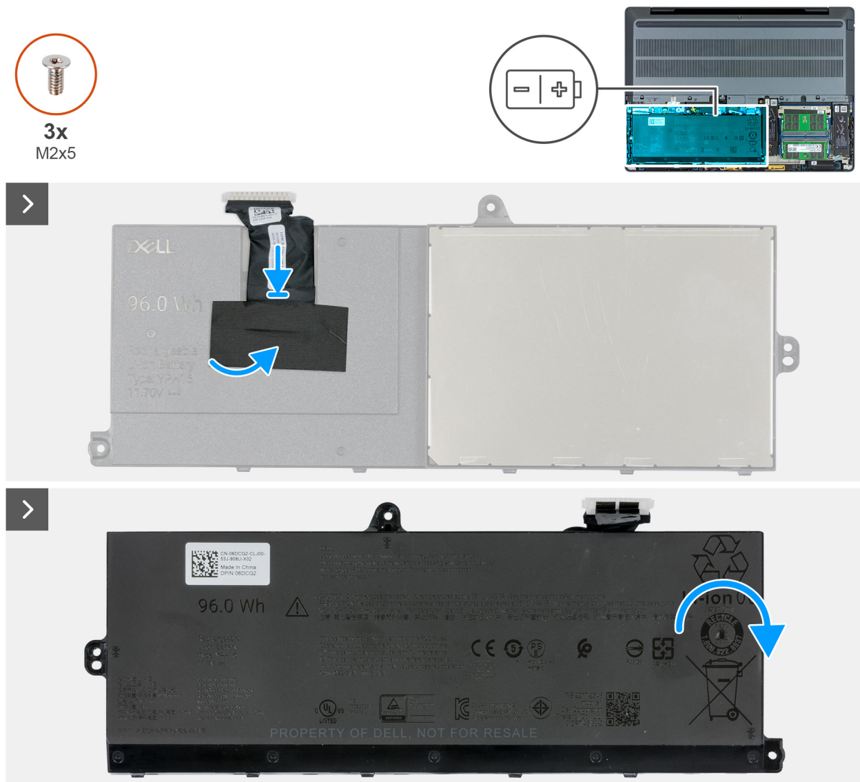
Figura 44. Ricollocamento del cavo della batteria
