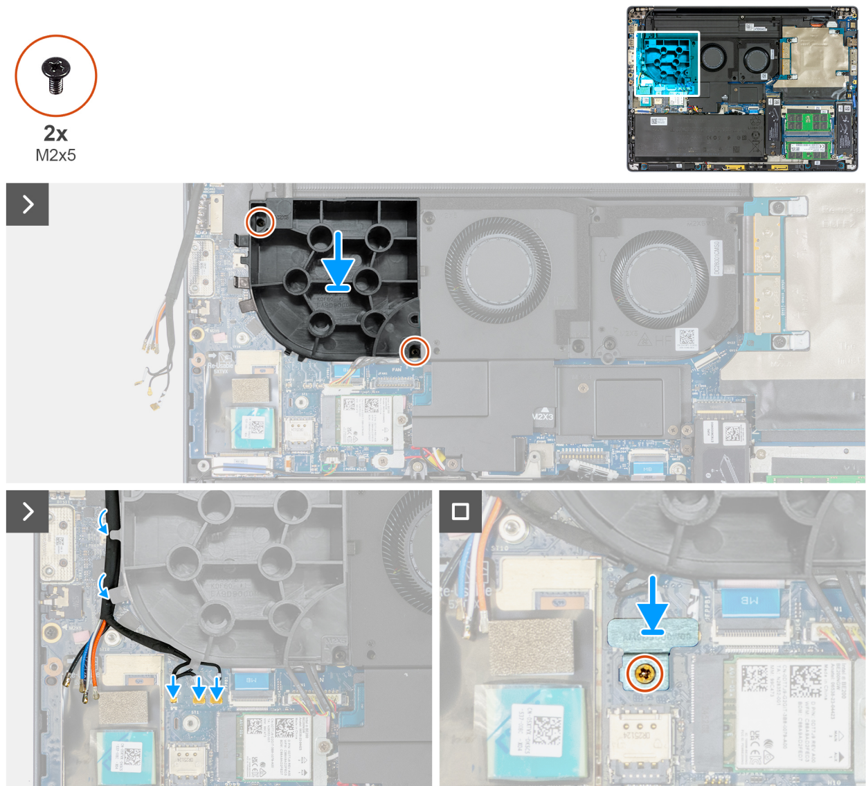
Figura 60. Installazione della ventola fittizia
