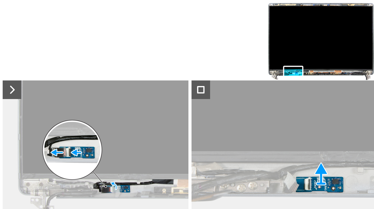
Figura 101. Rimozione della scheda sensore
