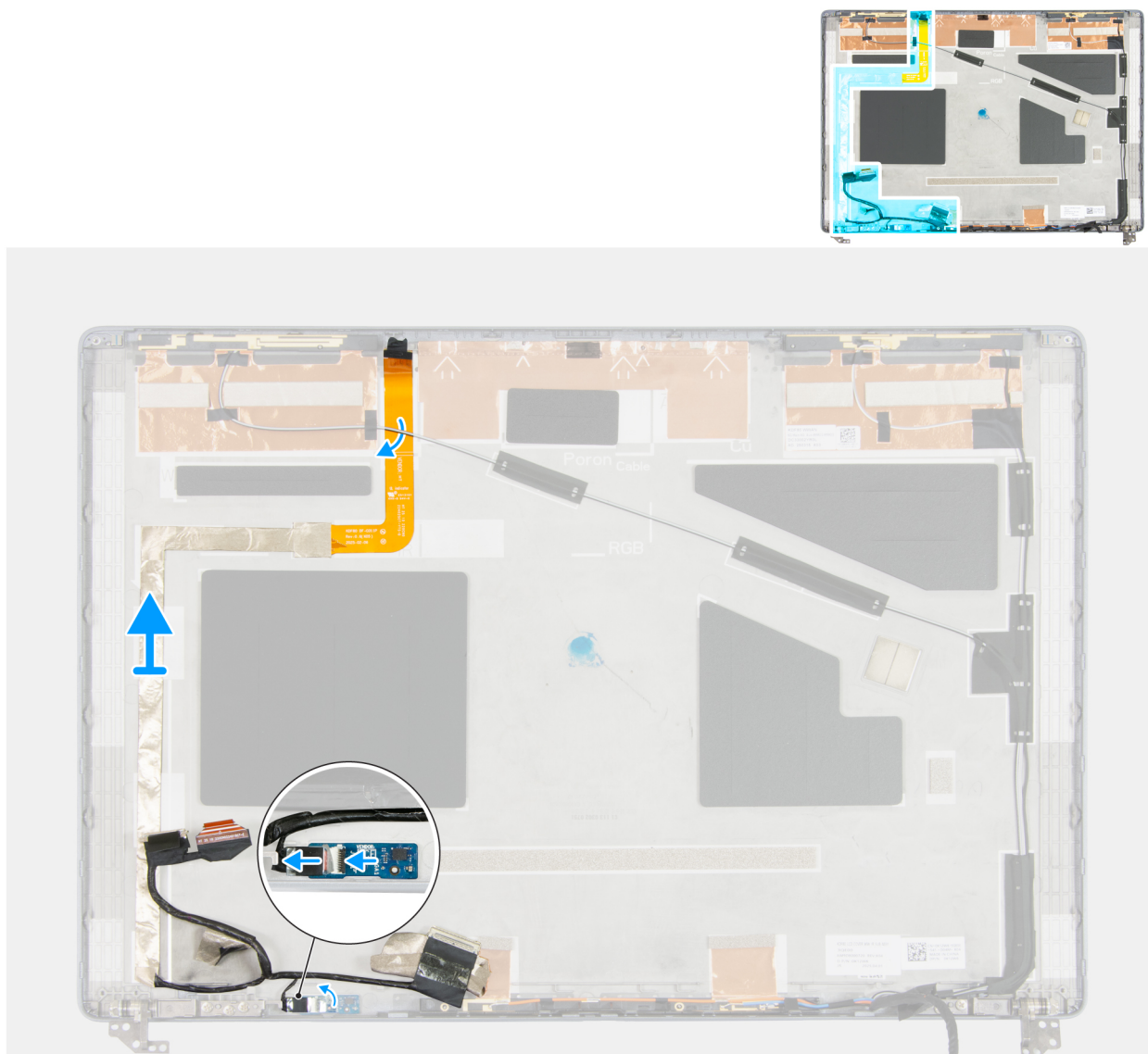
Figura 106. Rimozione del cavo del display
