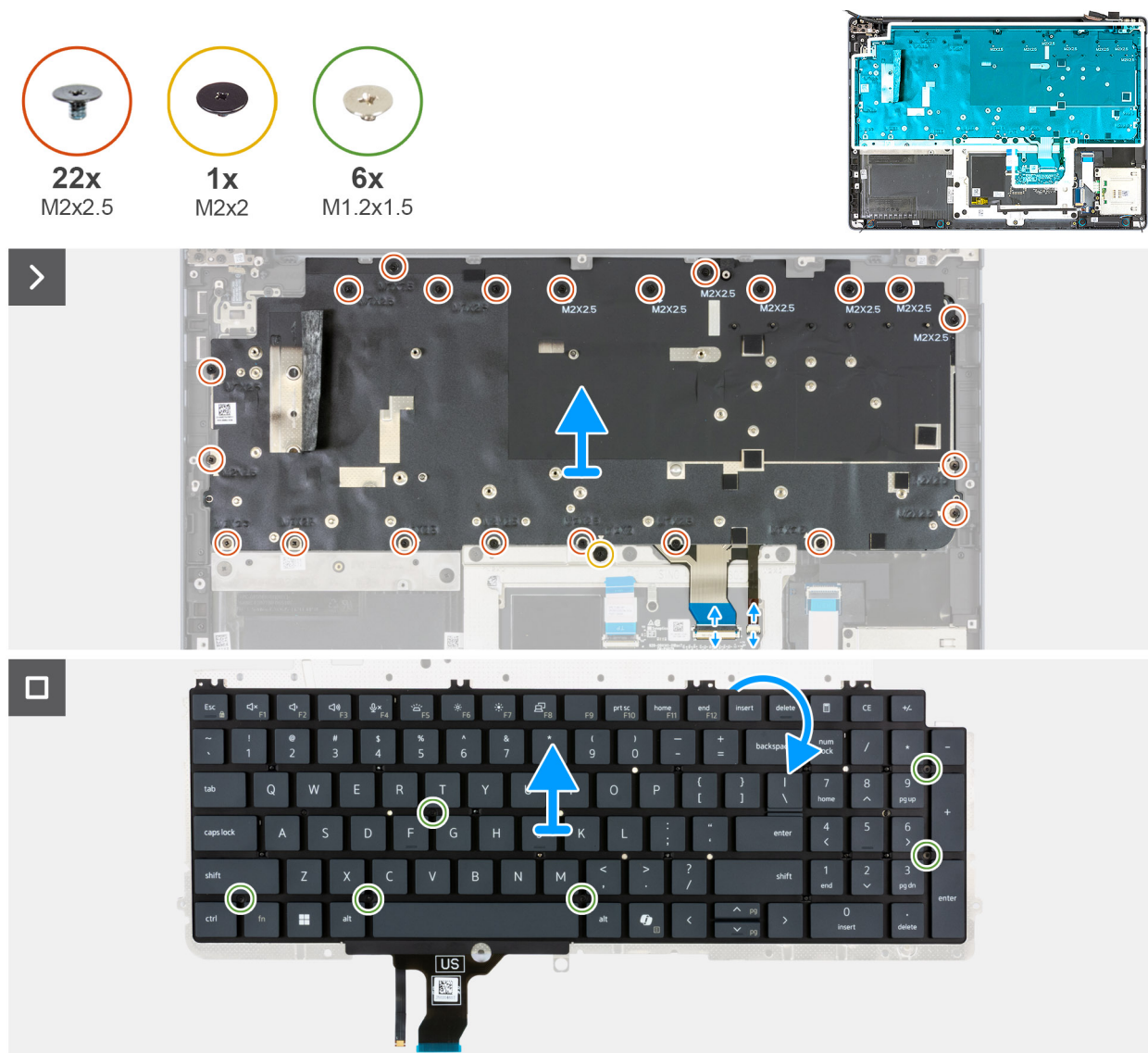
Figura 121. Rimozione della tastiera
