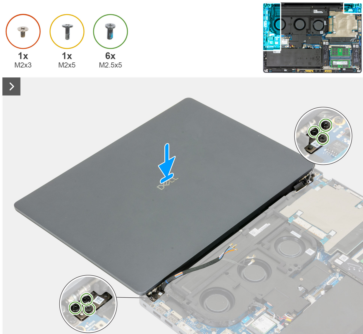
Figura 65. Installazione del gruppo del display
