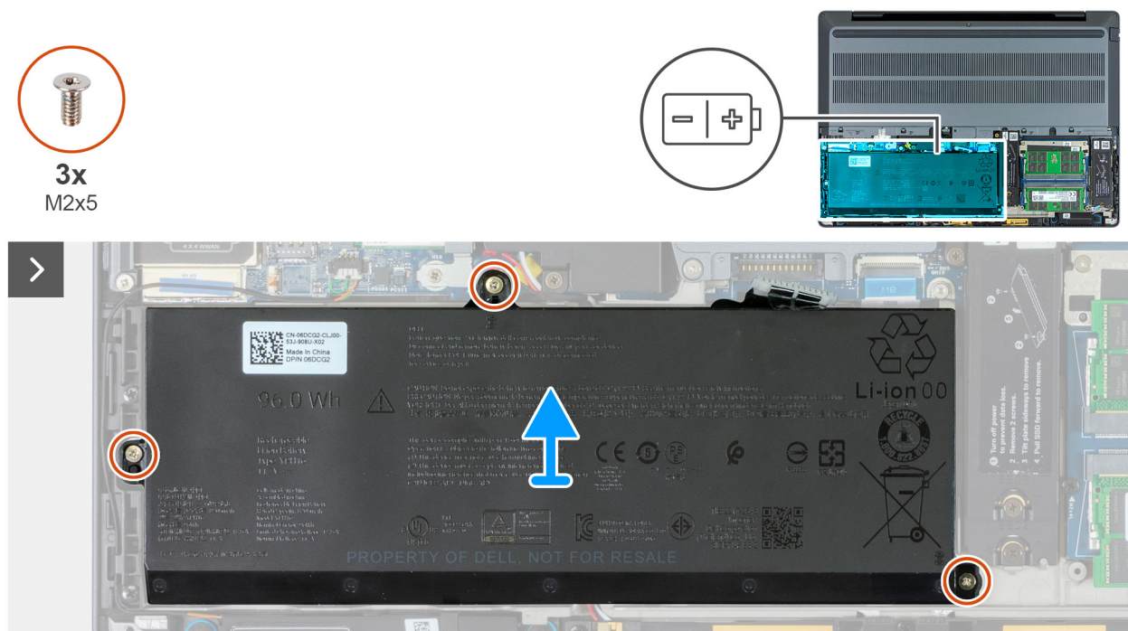
Figura 42. Rimozione della batteria
