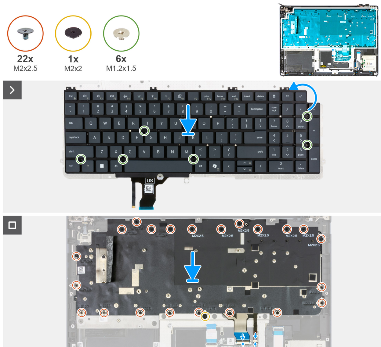
Figura 122. Installazione della tastiera
