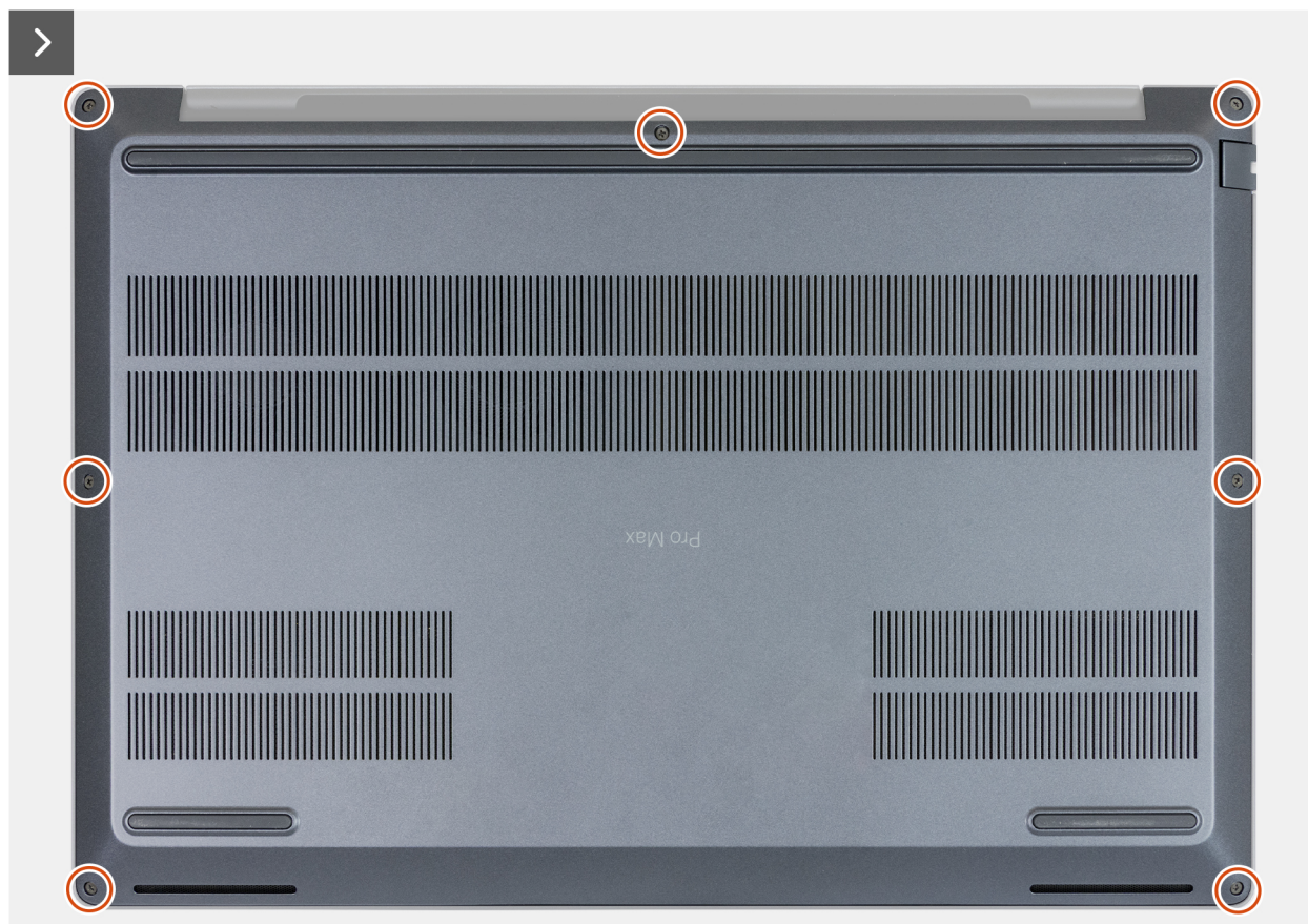
Figura 24. Allentamento delle viti di fissaggio
