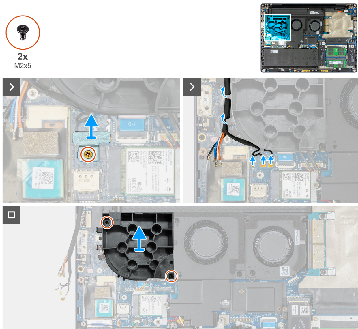
Figura 59. Rimozione della ventola fittizia
