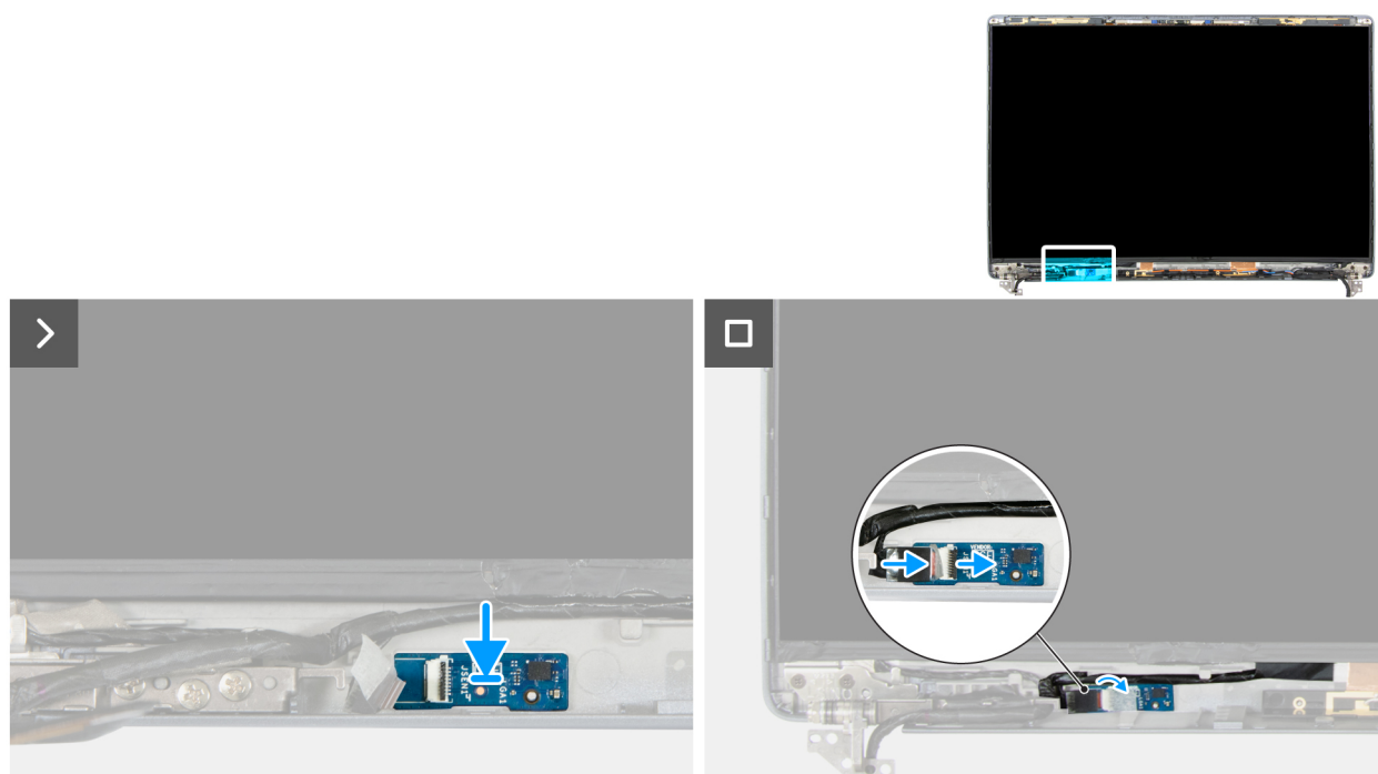
Figura 102. Installazione della scheda sensore
