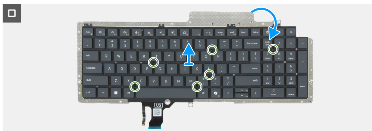
Figura 120. Rimozione della tastiera
