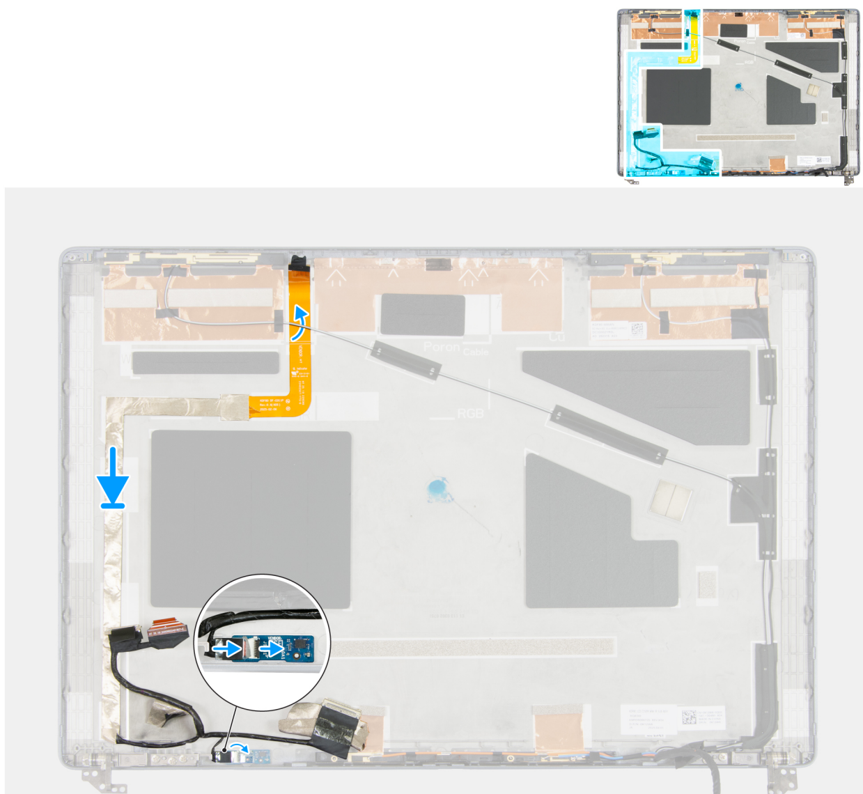
Figura 105. Installazione del cavo del display
