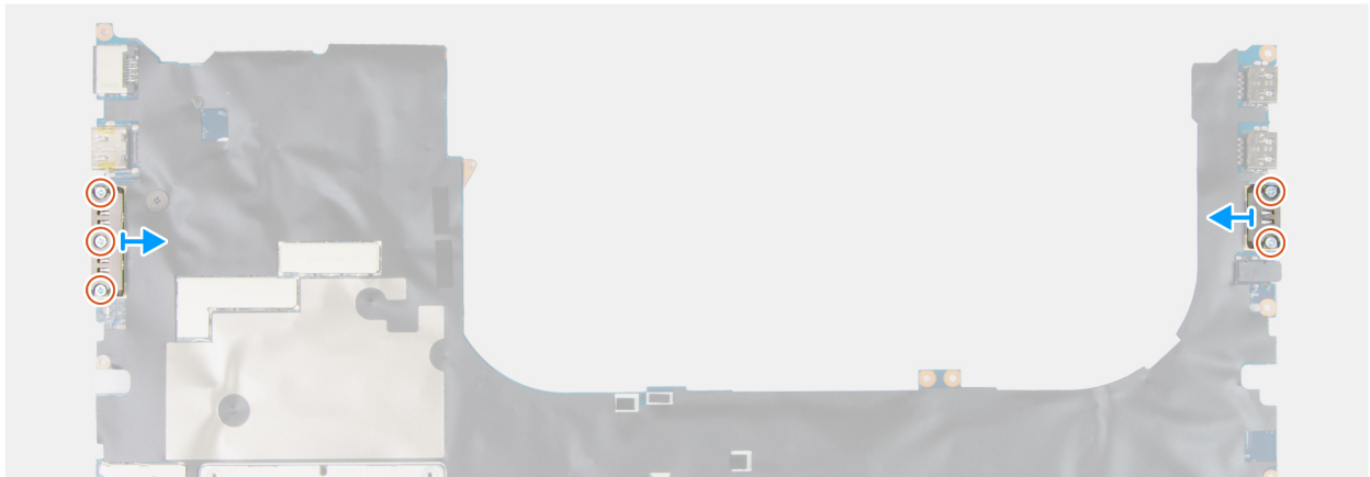
Figura 115. Rimozione del modulo del connettore USB Type-C
