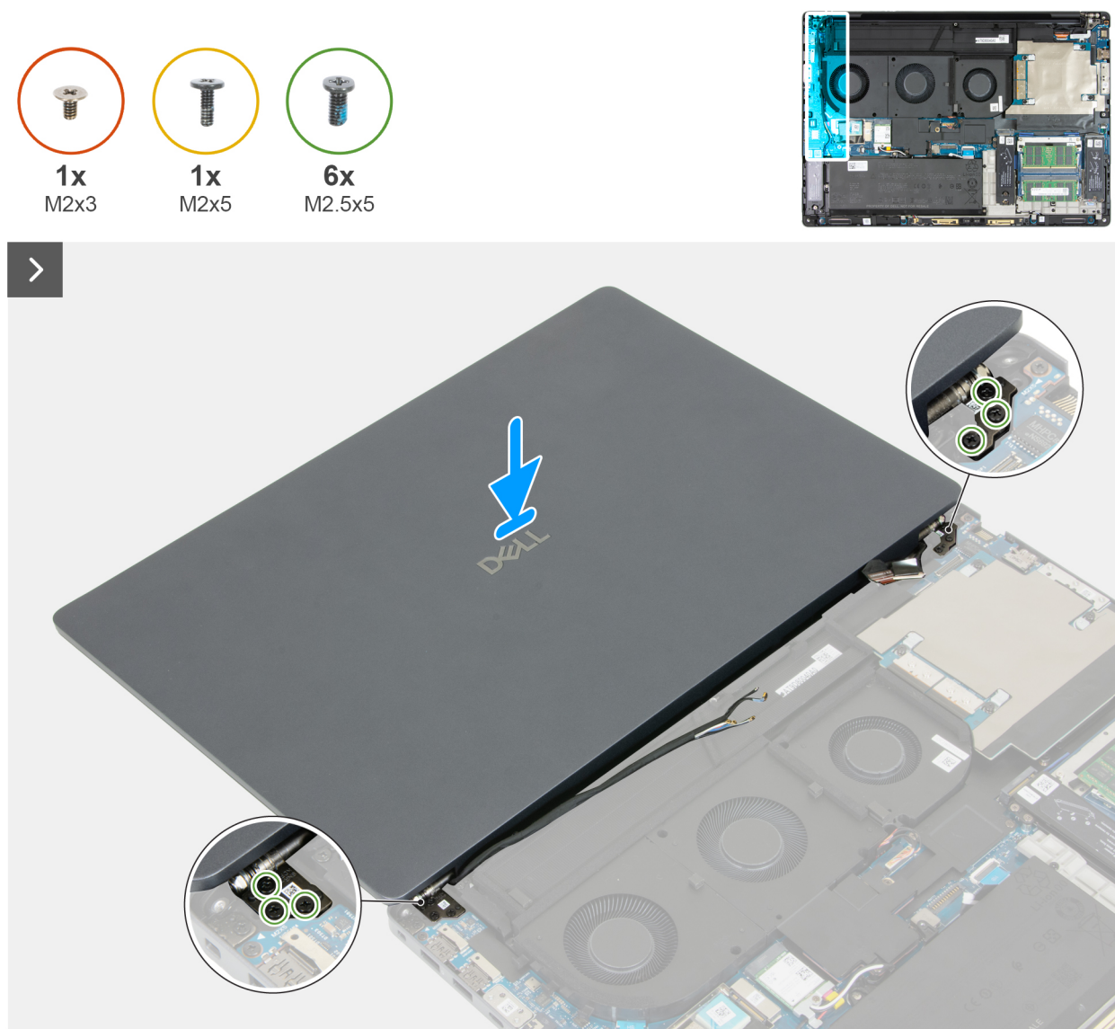
Figura 65. Installazione del gruppo del display
