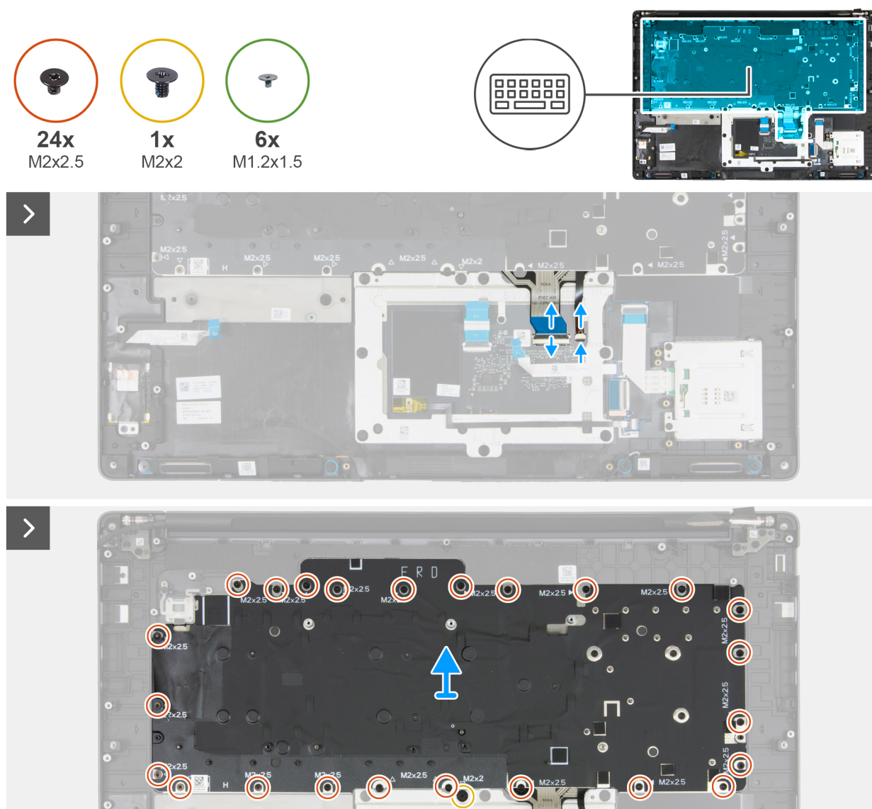
Figura 119. Rimozione della tastiera
