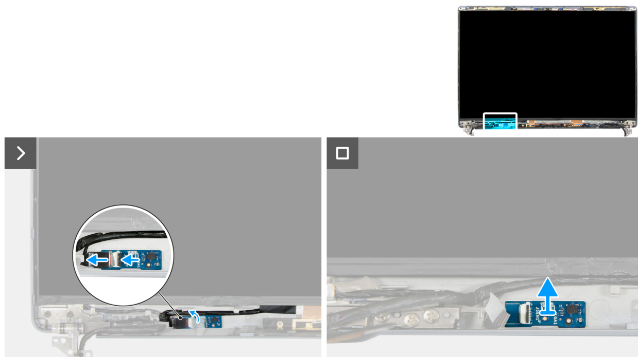
Figura 101. Rimozione della scheda sensore
