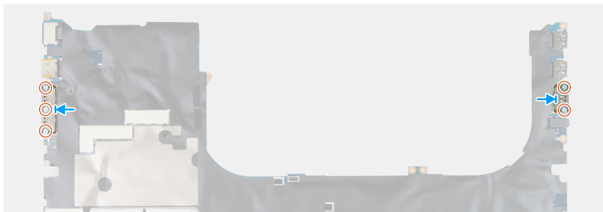
Figura 116. Installazione del modulo del connettore USB Type-C
