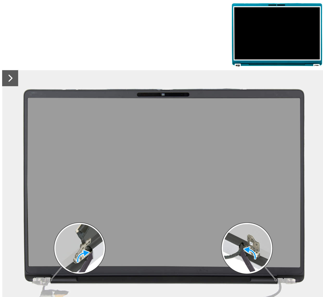
Figura 83. Rimozione della cornice del display
