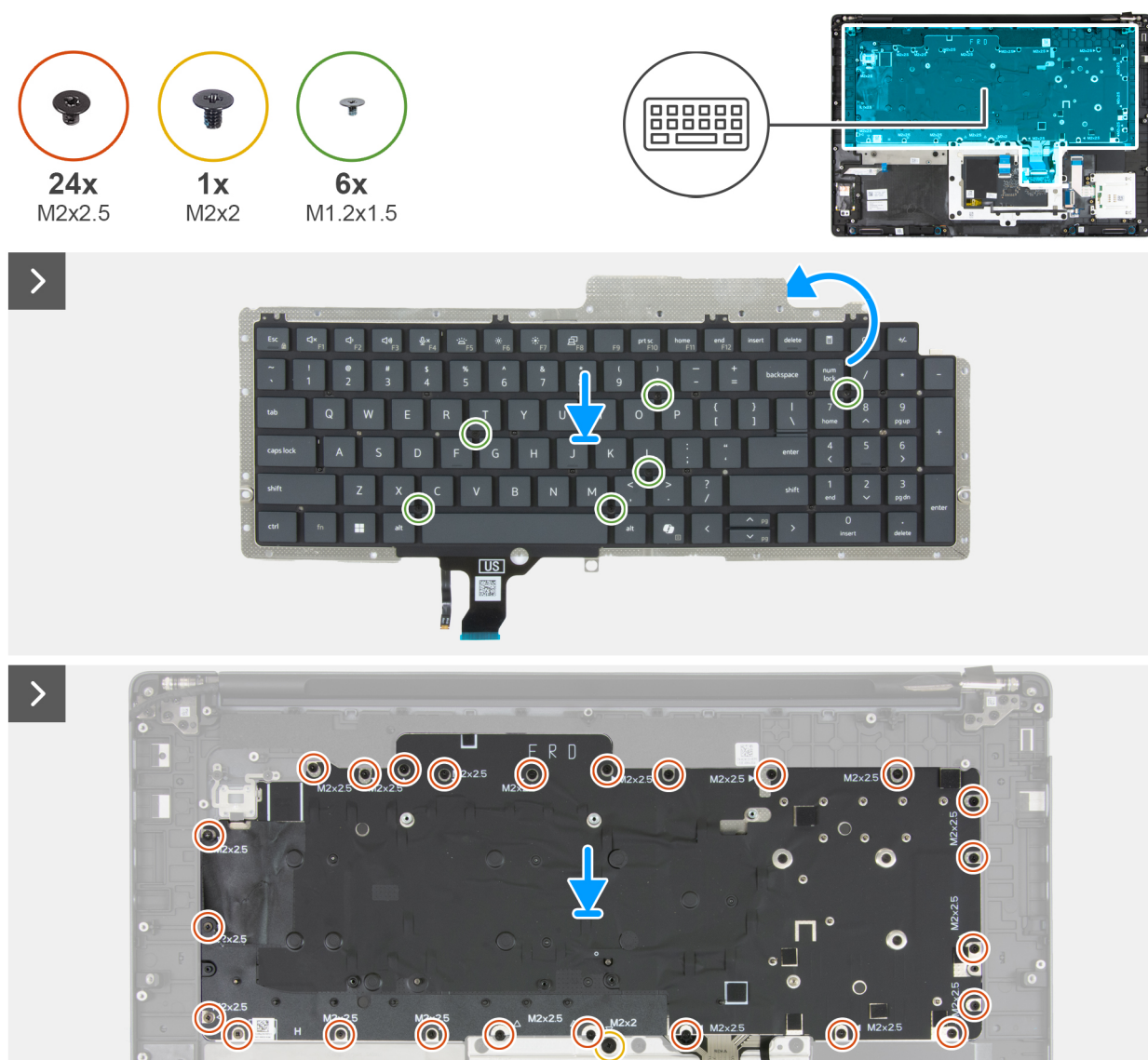
Figura 121. Installazione della tastiera
