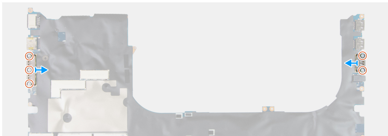
Figura 115. Rimozione del modulo del connettore USB Type-C
