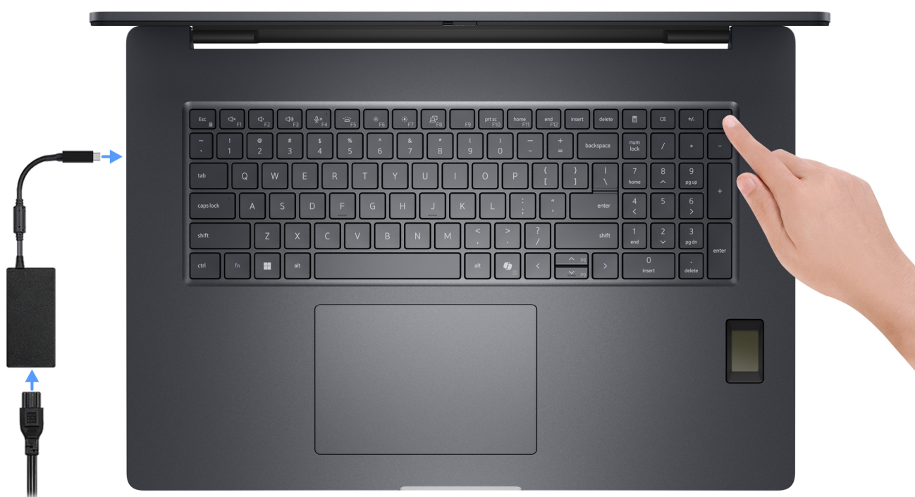
Figura 7. Collegare l'adattatore per l'alimentazione e premere il pulsante di accensione.
