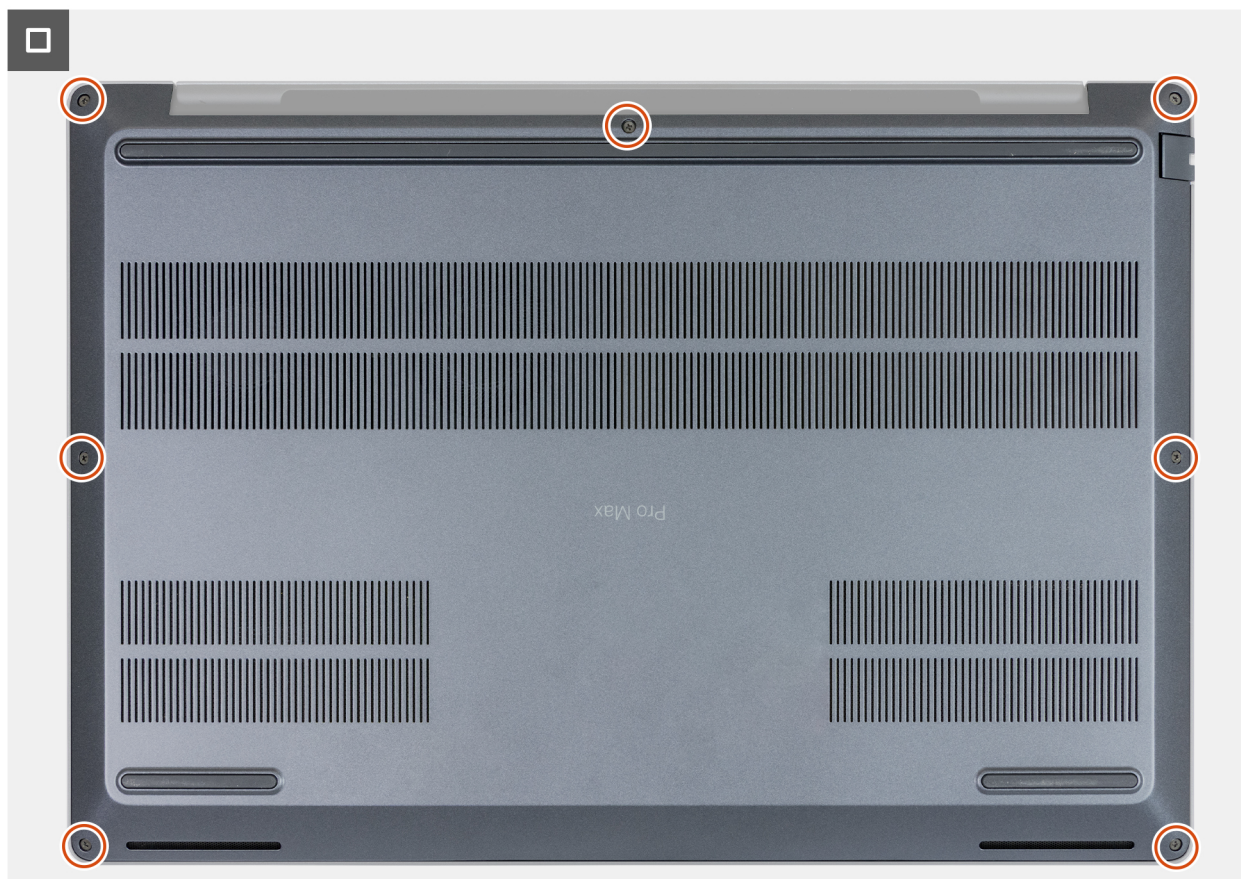
Figura 29. Serraggio delle viti di fissaggio
