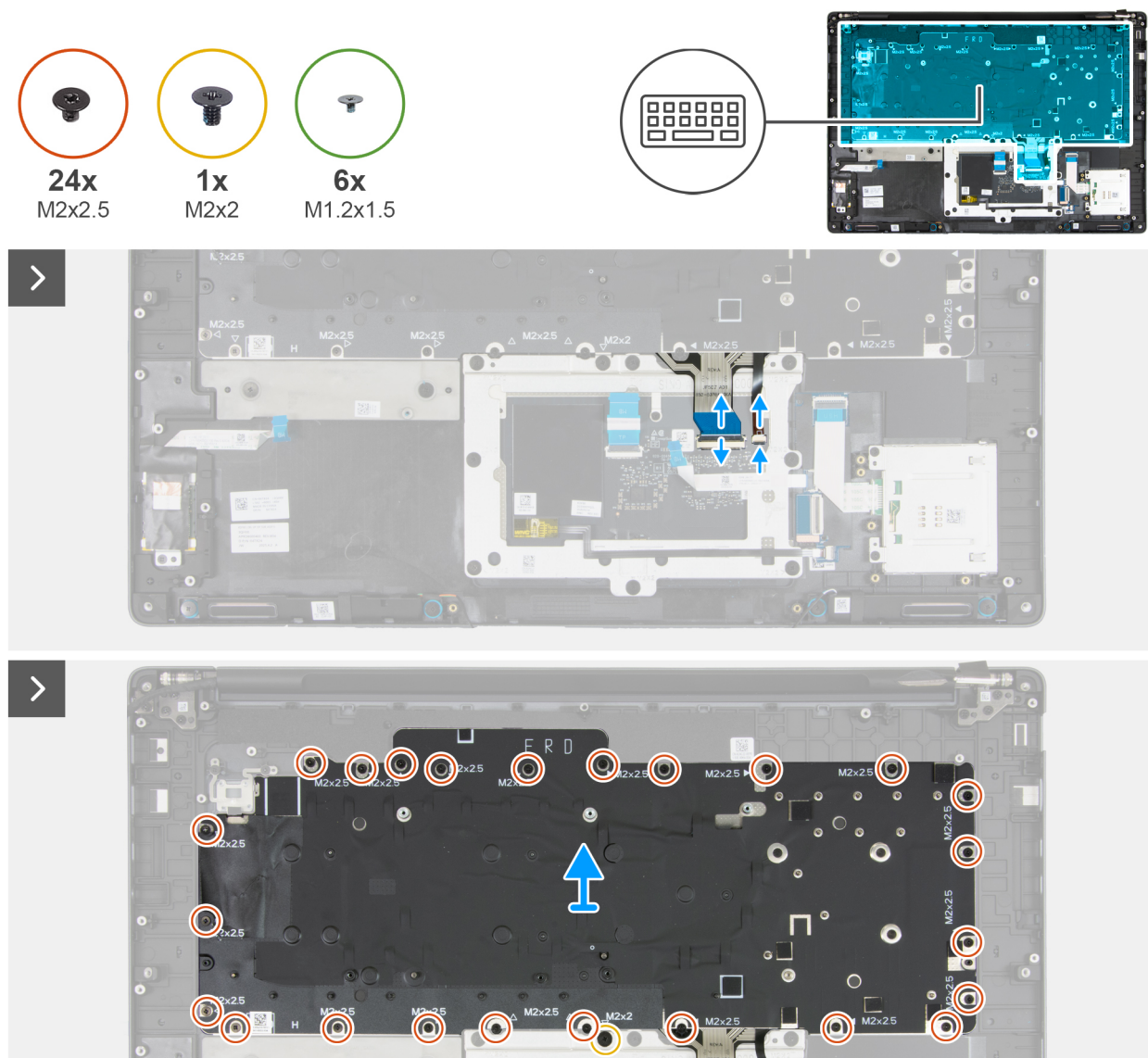
Figura 119. Rimozione della tastiera
