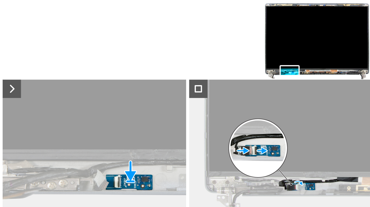
Figura 102. Installazione della scheda sensore
