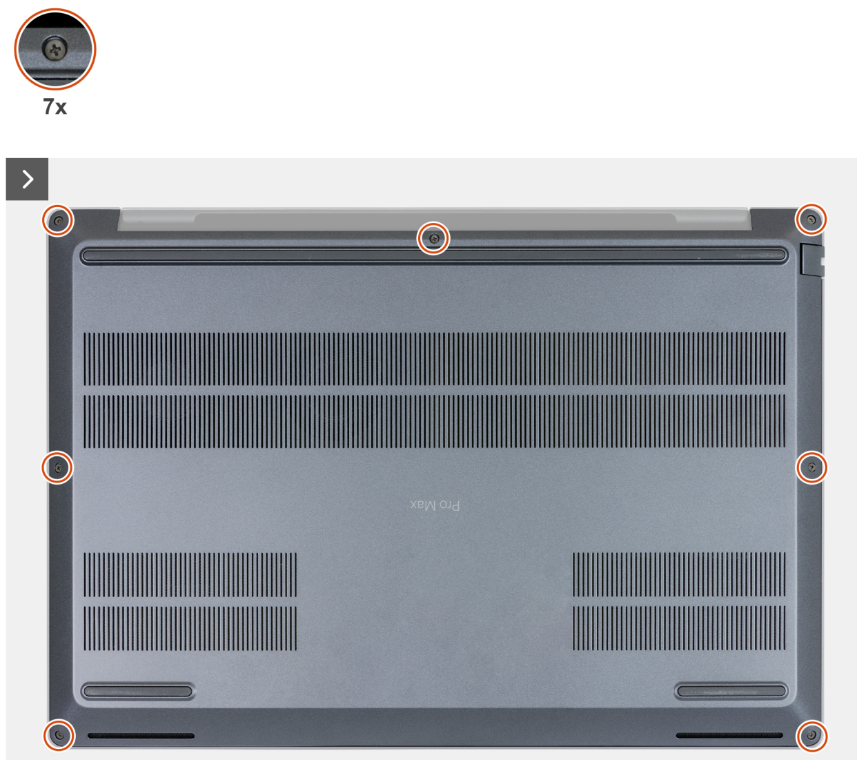
Figura 24. Allentamento delle viti di fissaggio
