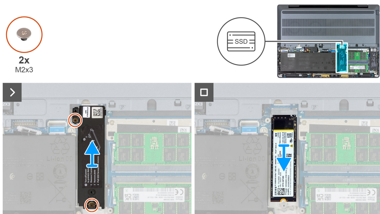
Figura 38. Rimozione dell'SSD M.2 2280 dallo slot 2 (SSD2)
