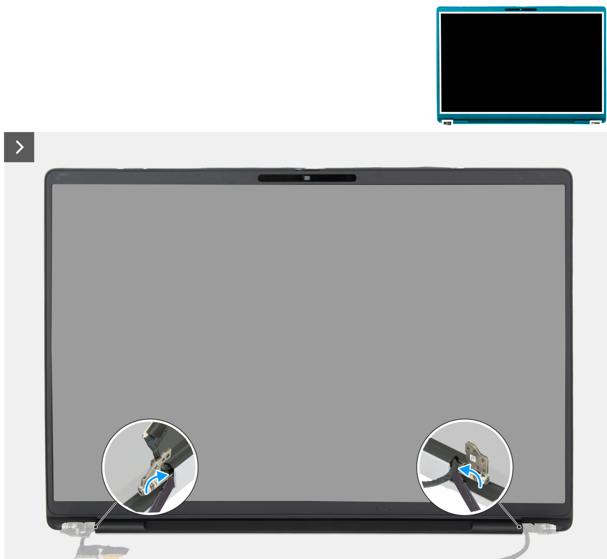
Figura 83. Rimozione della cornice del display
