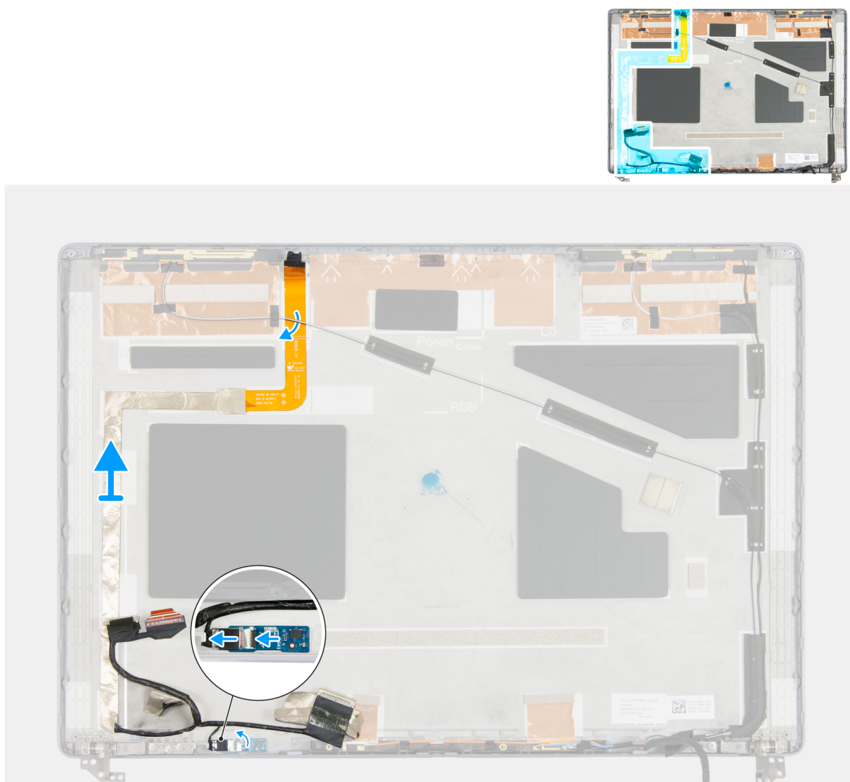
Figura 102. Rimozione del cavo del display
