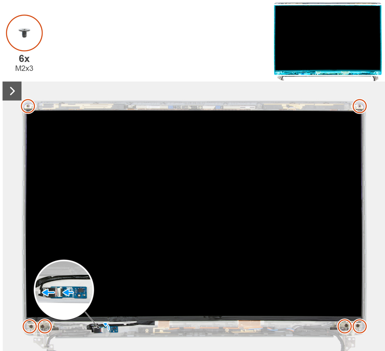
Figura 95. Rimozione del pannello del display
