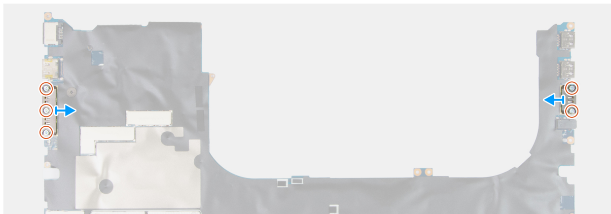
Figura 113. Rimozione del modulo del connettore USB Type-C
