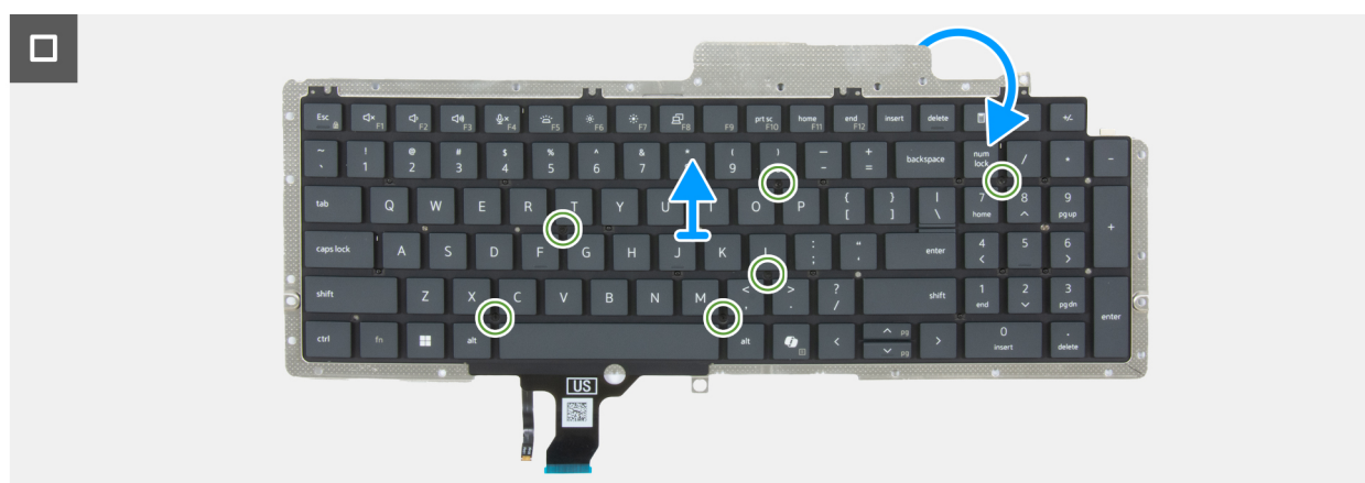
Figura 118. Rimozione della tastiera
