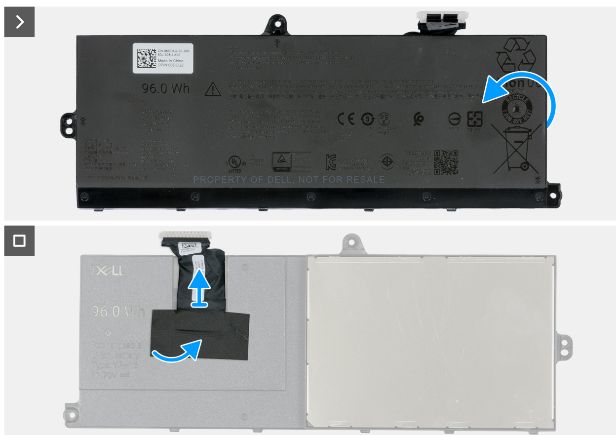
Figura 45. Rimozione del cavo della batteria dalla batteria
