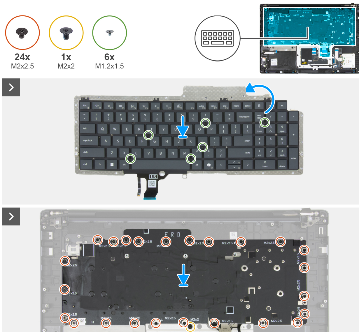
Figura 119. Installazione della tastiera
