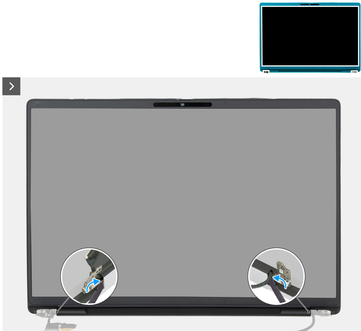
Figura 83. Rimozione della cornice del display
