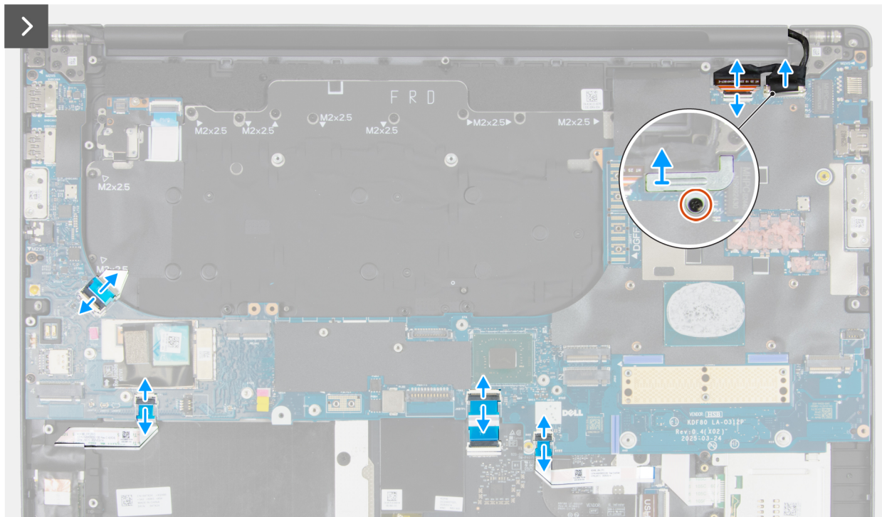
Figura 107. Rimozione della scheda di sistema
