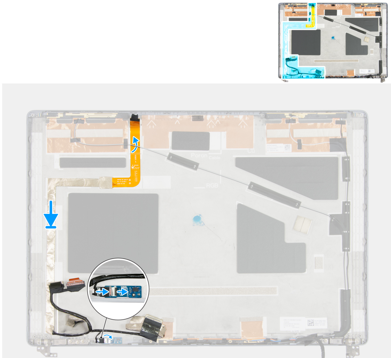
Figura 103. Installazione del cavo del display
