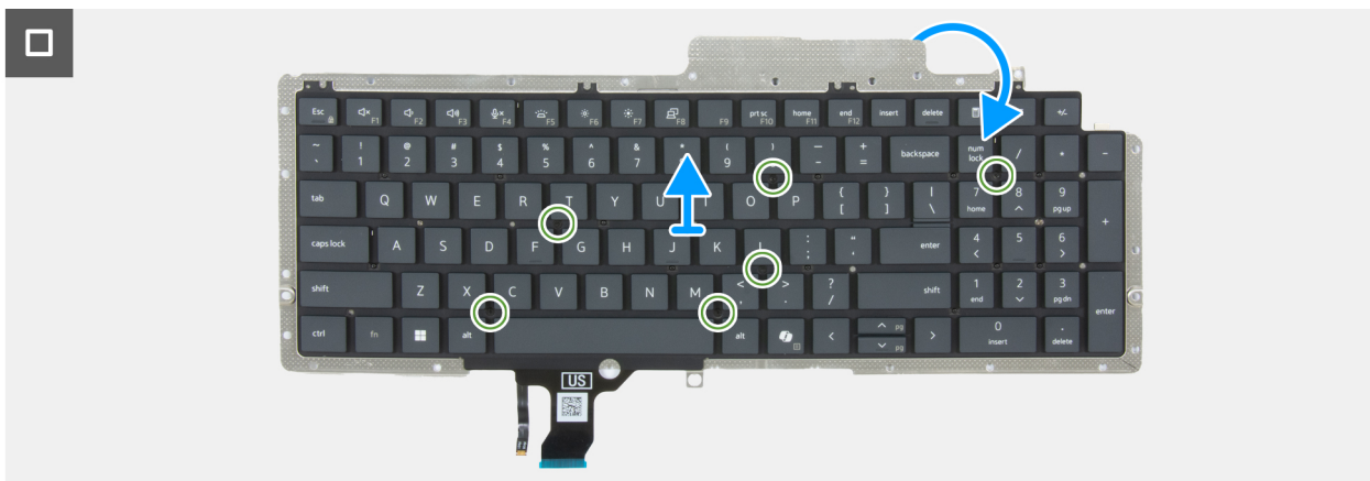
Figura 118. Rimozione della tastiera
