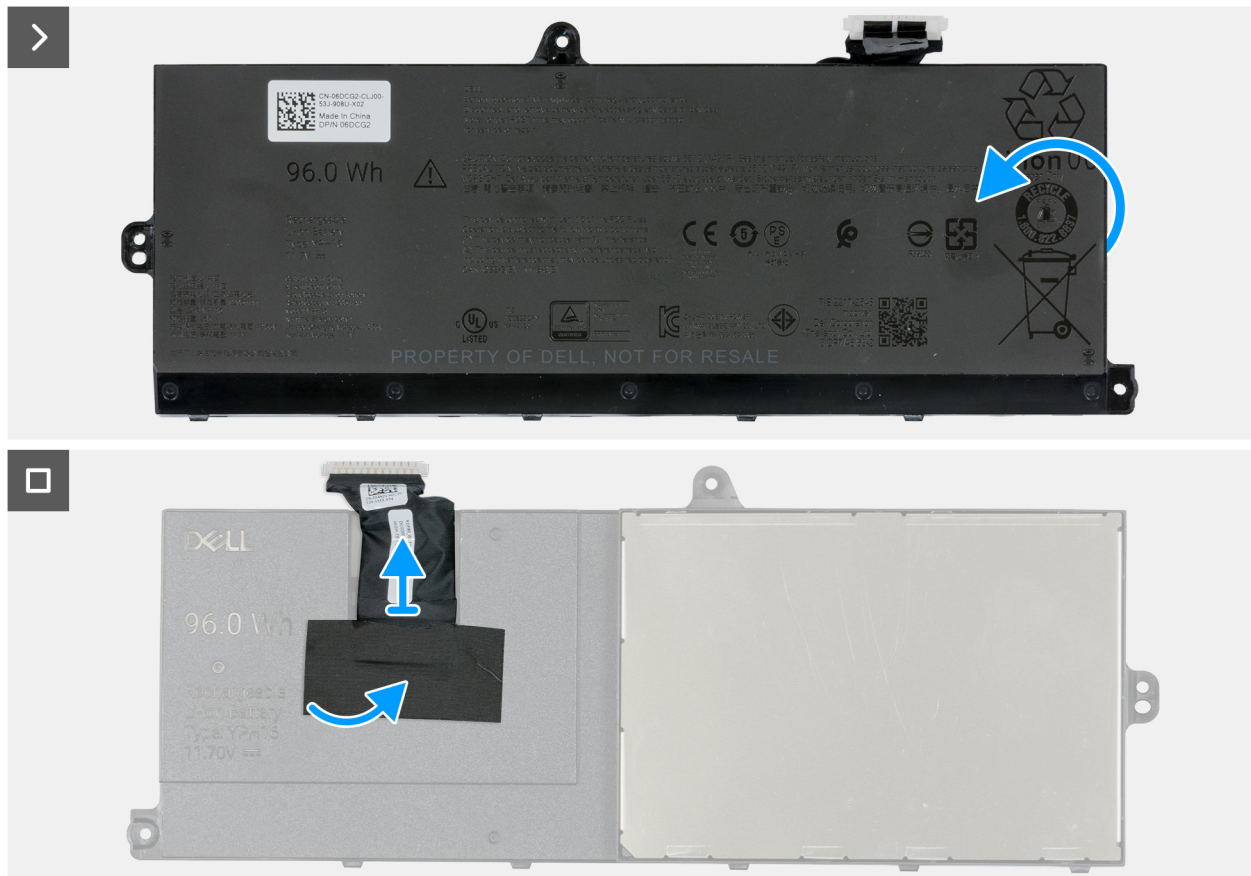
Figura 45. Rimozione del cavo della batteria dalla batteria
