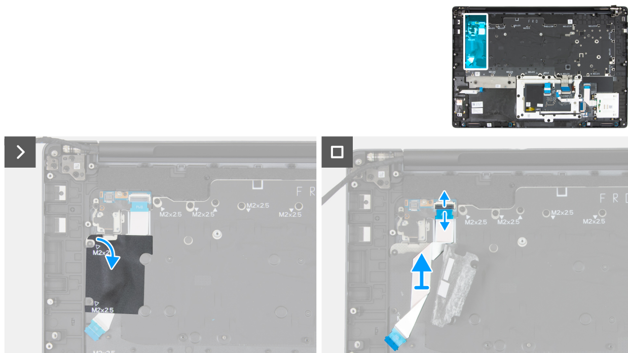
Figura 123. Rimozione del cavo della scheda del pulsante di alimentazione
