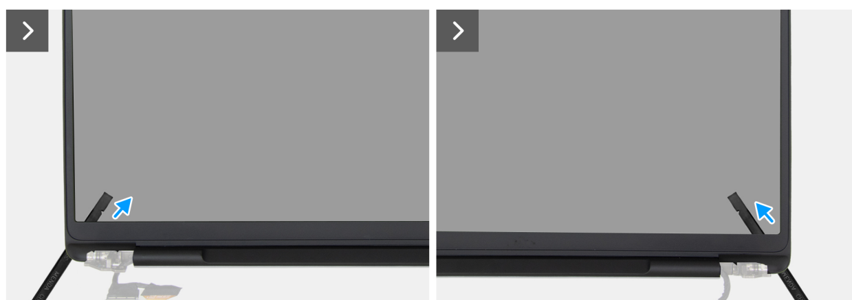
Figura 84. Rimozione della cornice del display
