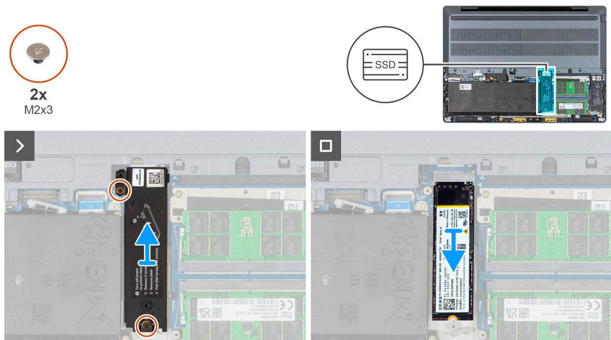
Figura 38. Rimozione dell'SSD M.2 2280 dallo slot 2 (SSD2)
