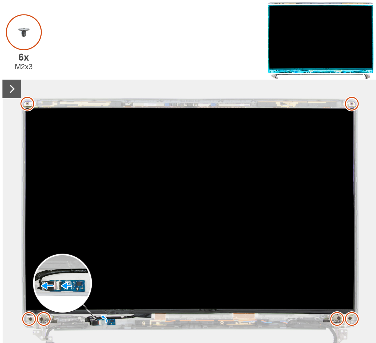
Figura 95. Rimozione del pannello del display
