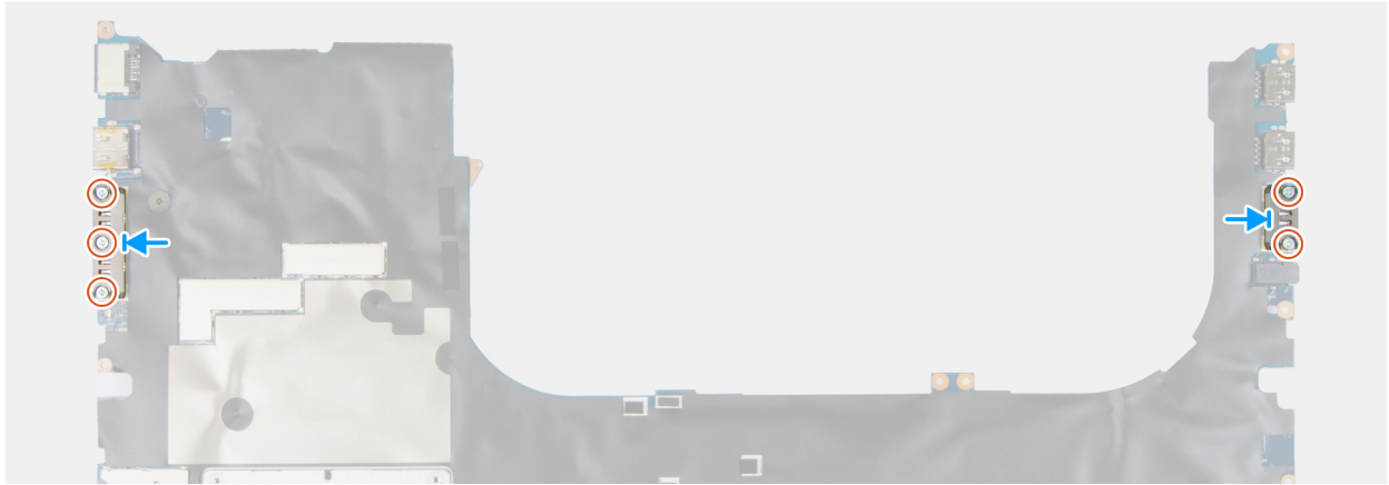
Figura 114. Installazione del modulo del connettore USB Type-C
