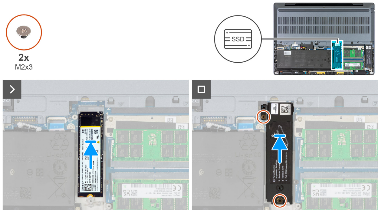
Figura 39. Installazione dell'SSD M.2 2280 nello slot 2 (SSD2)
