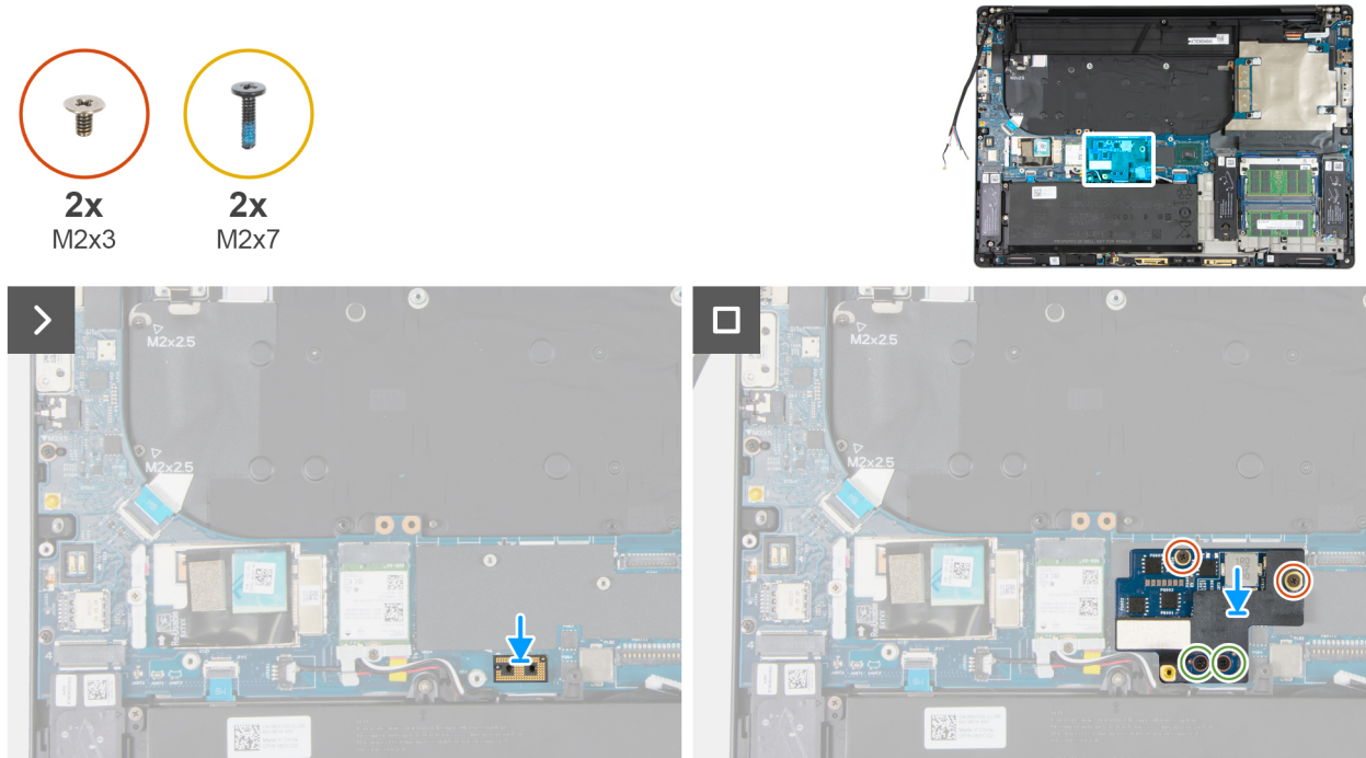
Figura 72. Installazione della scheda di alimentazione
