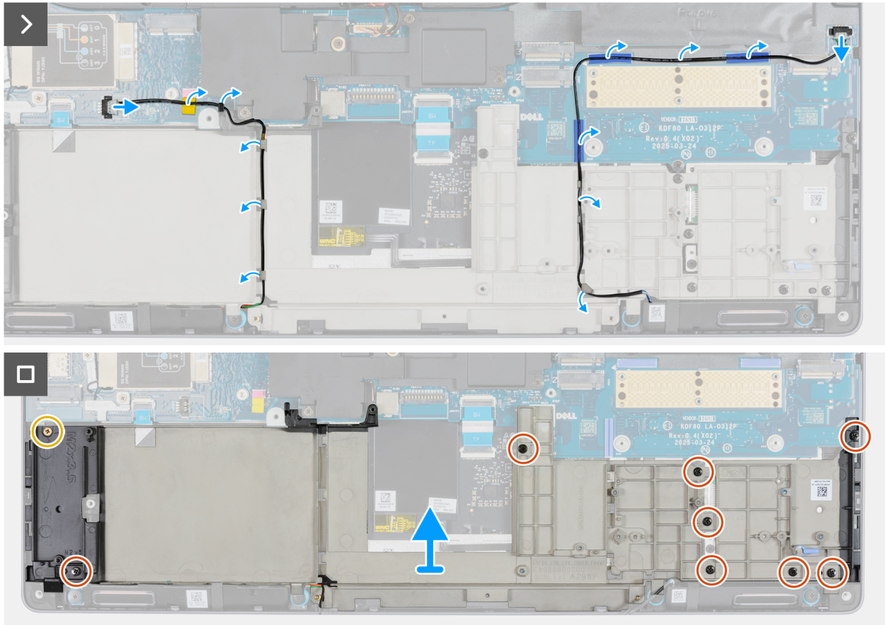
Figura 79. Rimozione dell'intelaiatura interna
