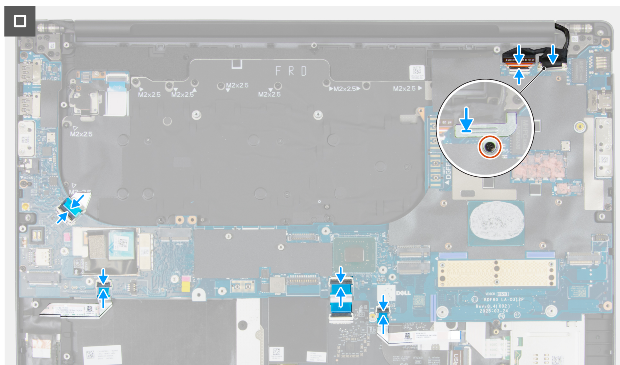
Figura 112. Installazione della scheda di sistema
