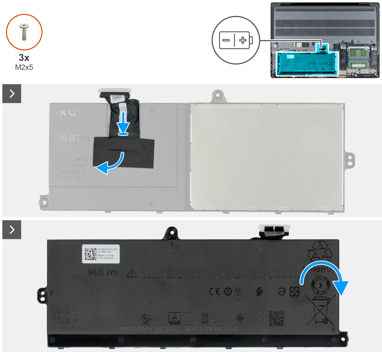
Figura 46. Ricollocamento del cavo della batteria
