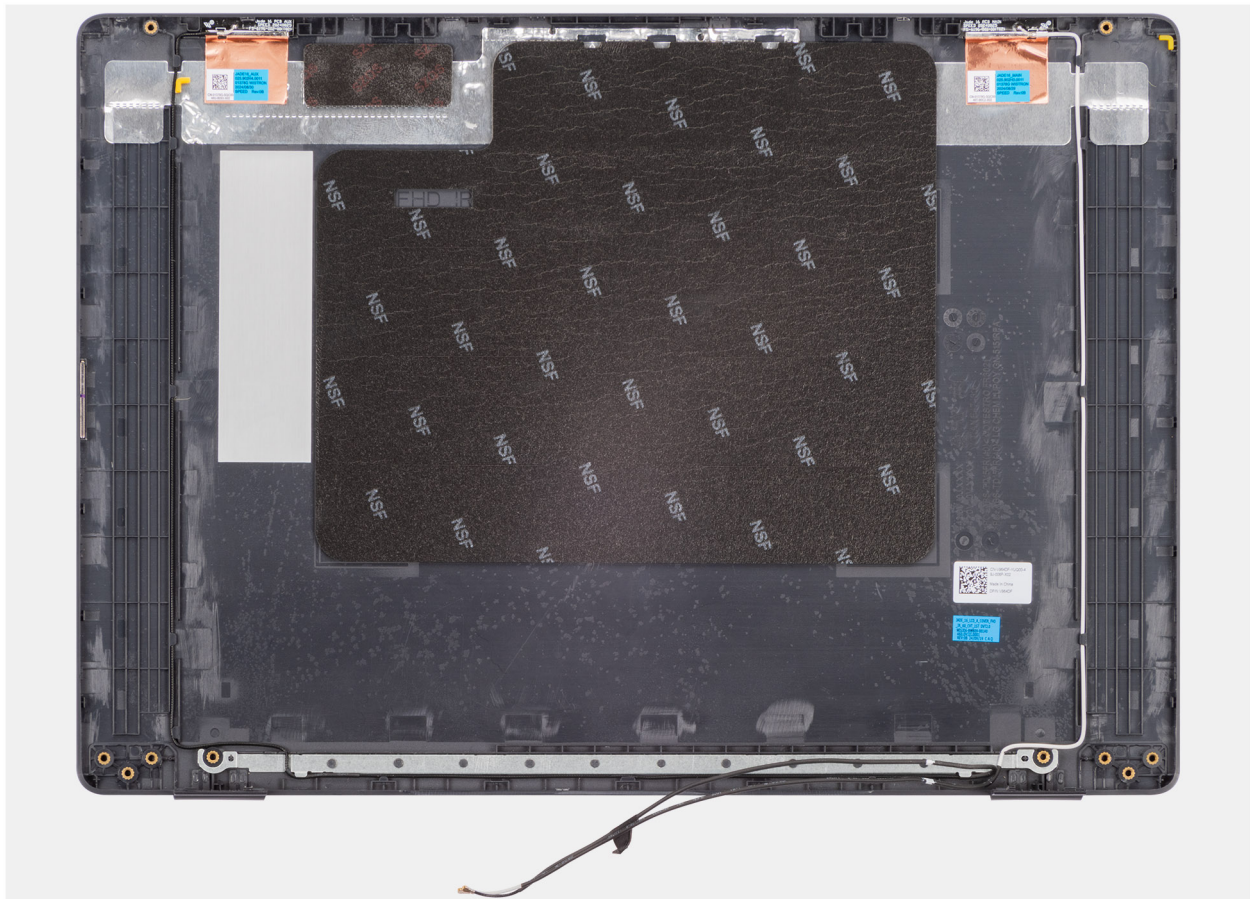
Figura 117. Rimozione del gruppo coperchio posteriore del display
