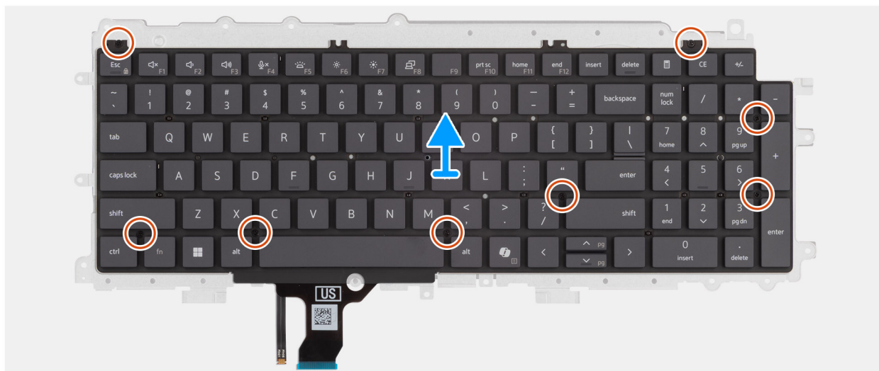
Figura 85. Rimozione della piastra di supporto della tastiera
