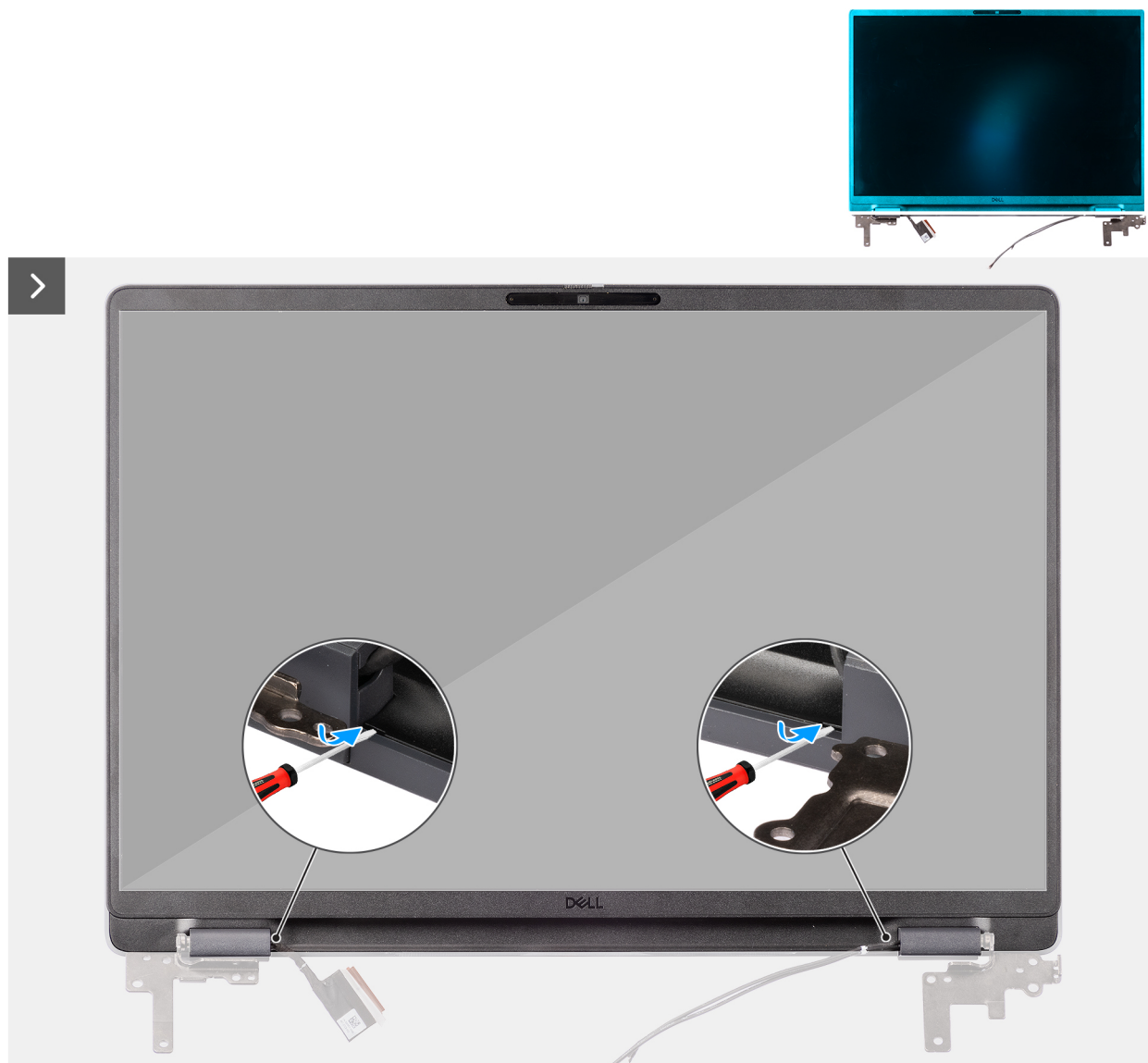
Figura 98. Rimozione della cornice del display
