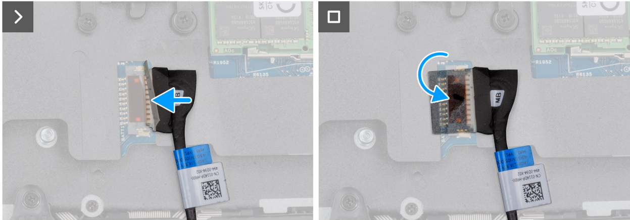
Figura 14. Collegamento del cavo della batteria
