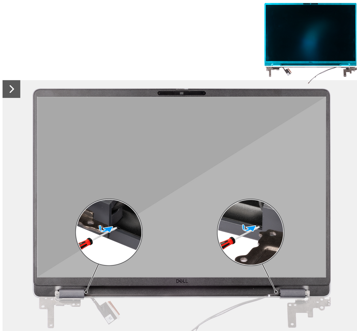
Figura 98. Rimozione della cornice del display
