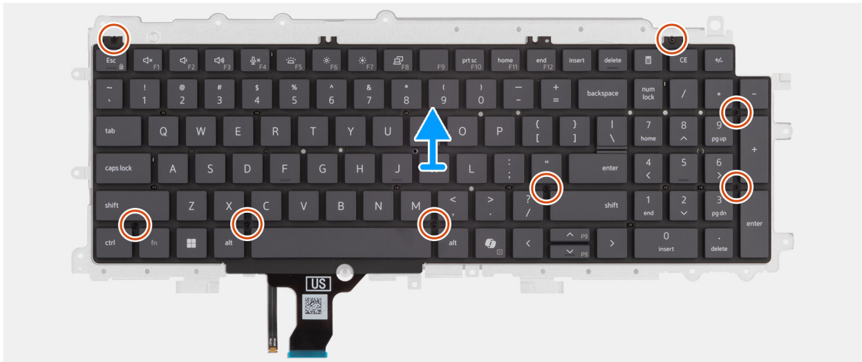
Figura 85. Rimozione della piastra di supporto della tastiera
