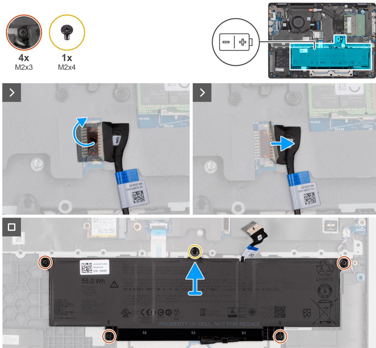
Figura 17. Rimozione della batteria
