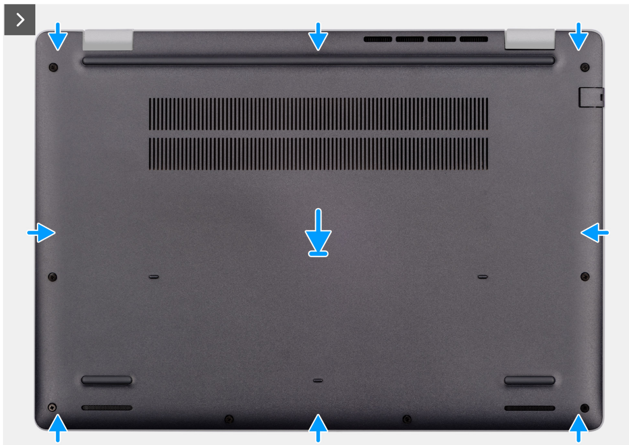
Figura 15. Installazione del coperchio della base
