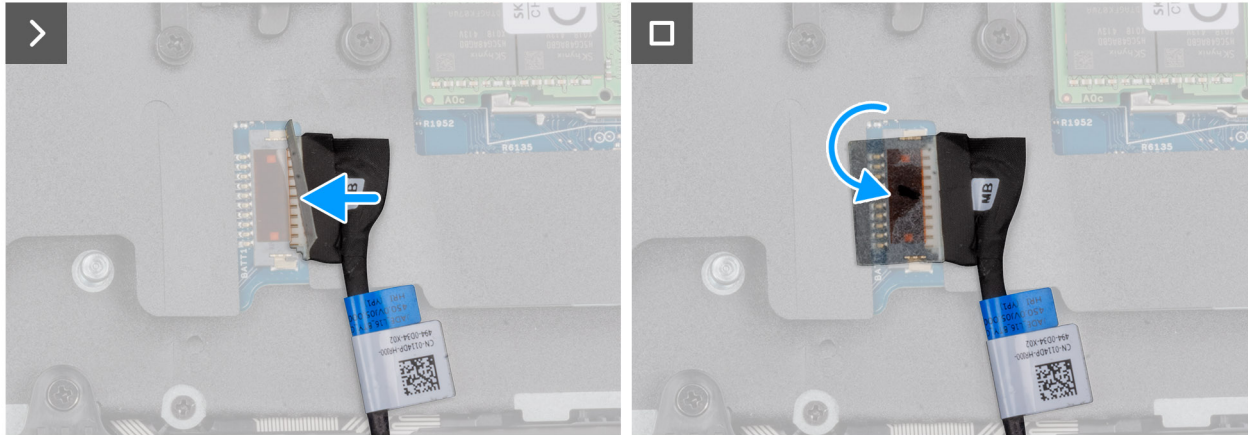
Figura 14. Collegamento del cavo della batteria
