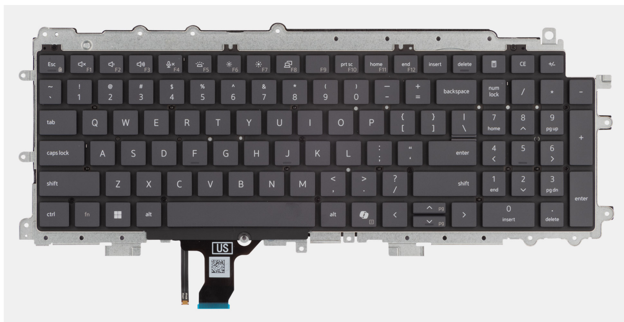
Figura 81. Rimozione della tastiera
