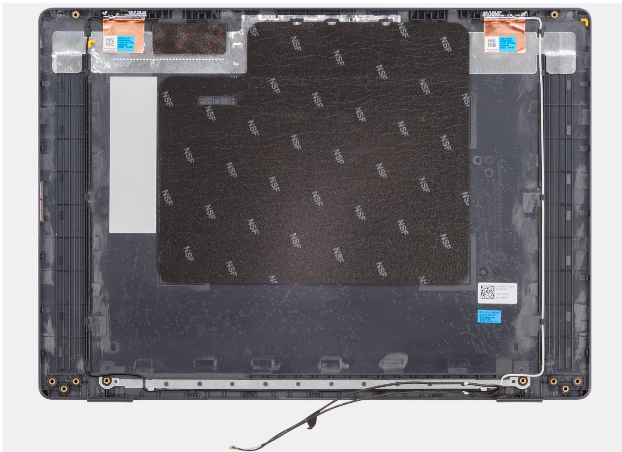
Figura 117. Rimozione del gruppo coperchio posteriore del display
