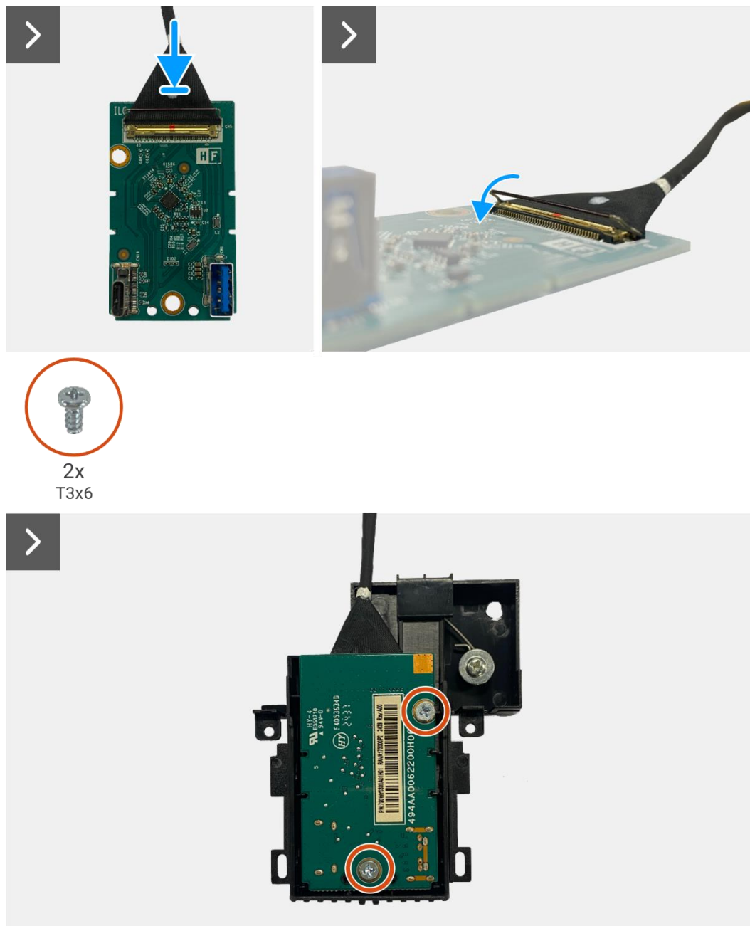
Figura 90. Installazione della scheda QAP
