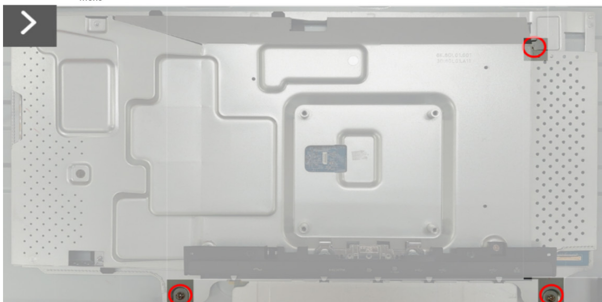
Immagine 21. Installazione del telaio
