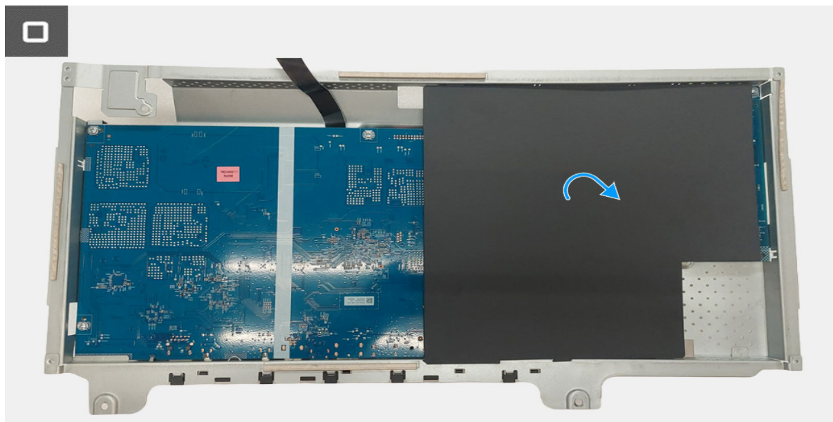
Immagine 20. Rimozione del telaio
