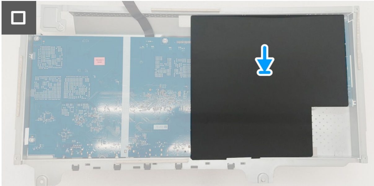
Immagine 26. Installazione della scheda driver LED
