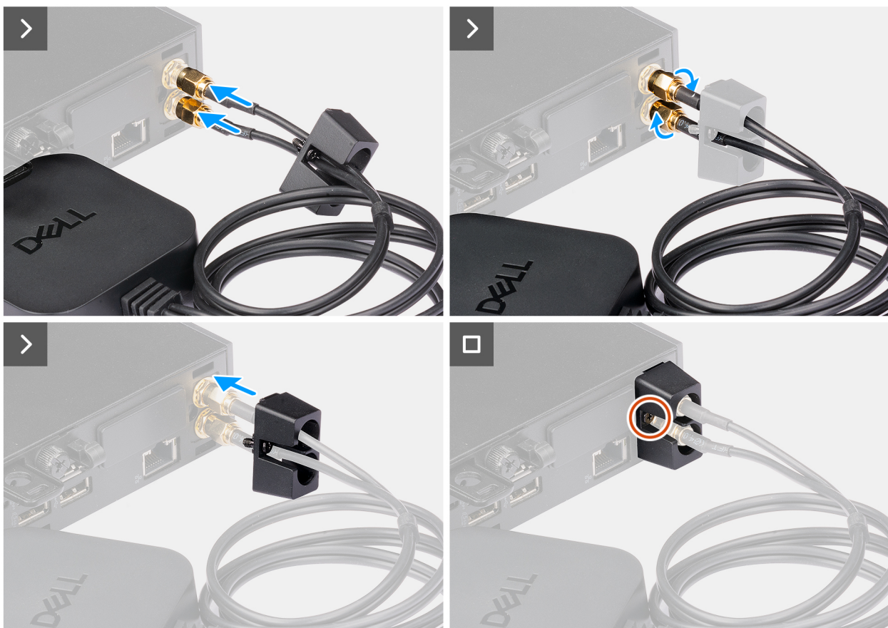
Figura 35. Installazione dell'antenna a disco esterna
