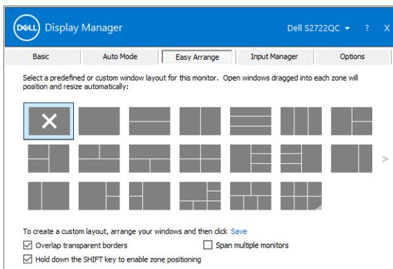
Se si stanno utilizzando più monitor in un'array o matrice, il layout **Easy Arrange (Organizzazione semplice)** può essere applicato a tutti i monitor come un desktop. Selezionare **Span multiple monitors (Aggancia più monitor)** per attivare la funzione. Per renderlo effettivo, è necessario assicurarsi che i monitor raggruppati abbiano la stessa risoluzione e che la posizione fisica dei monitor sia organizzata in modo corretto.
