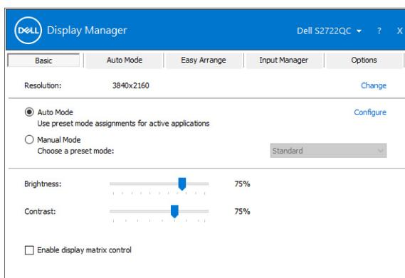
**NOTA:** Quando sono collegati più monitor Dell, selezionare "Enable display matrix control" (Attiva controllo matrice schermo) per applicare luminosità, contrasto e predefiniti colore a tutti i monitor.
