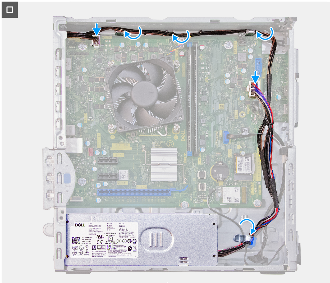
Figura 36. Installazione dell'unità di alimentazione
