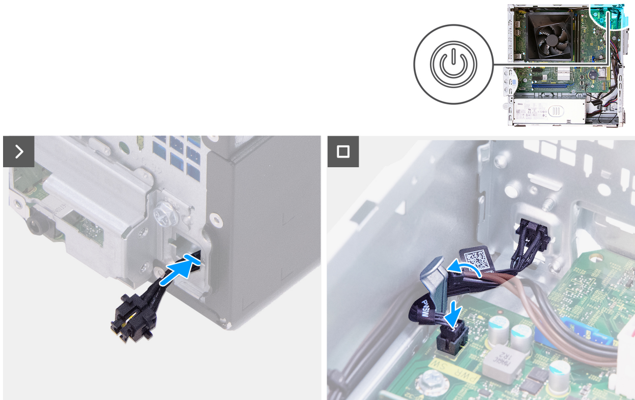
Figura 44. Installazione del pulsante di accensione
