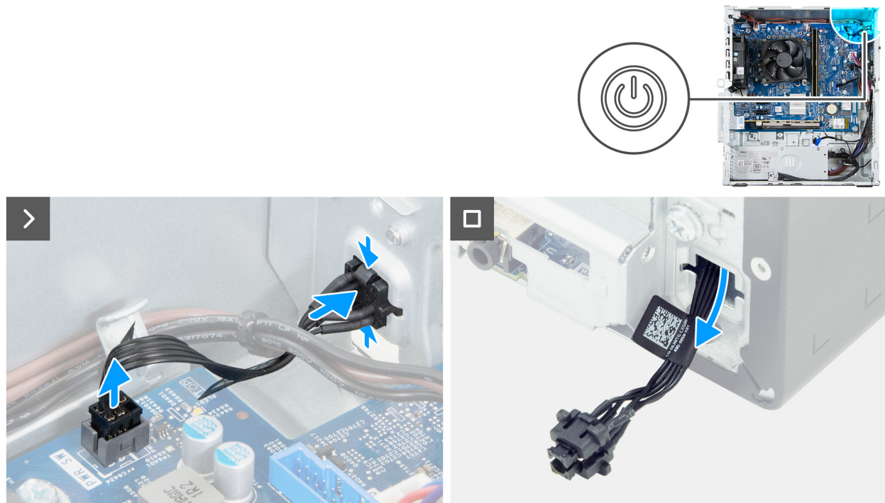
Figura 34. Rimozione del pulsante di accensione
