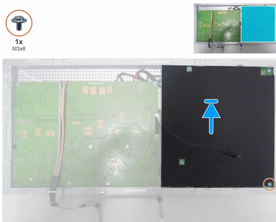
**Figura 47. Installazione del foglio mylar**
