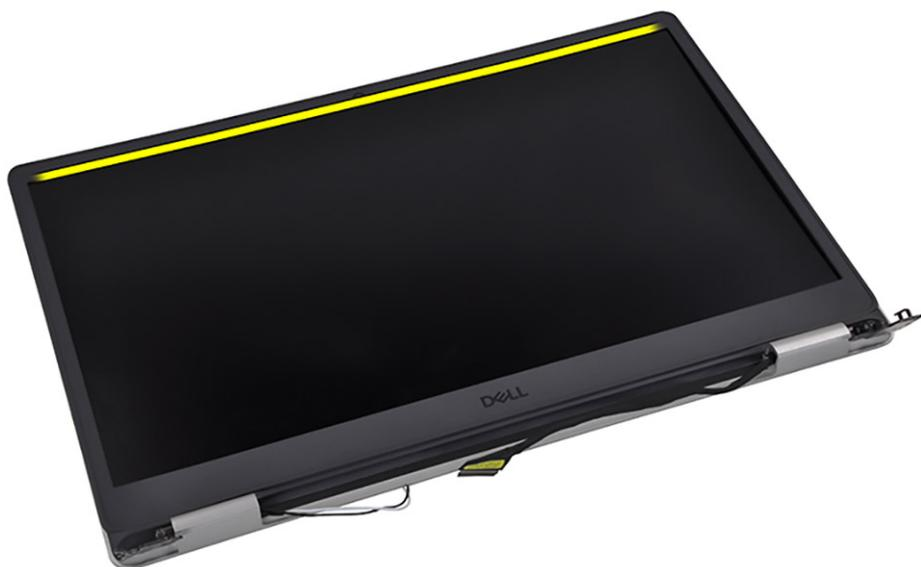
3. Sollevare i cappucci delle cerniere sul lato inferiore del gruppo del display.
