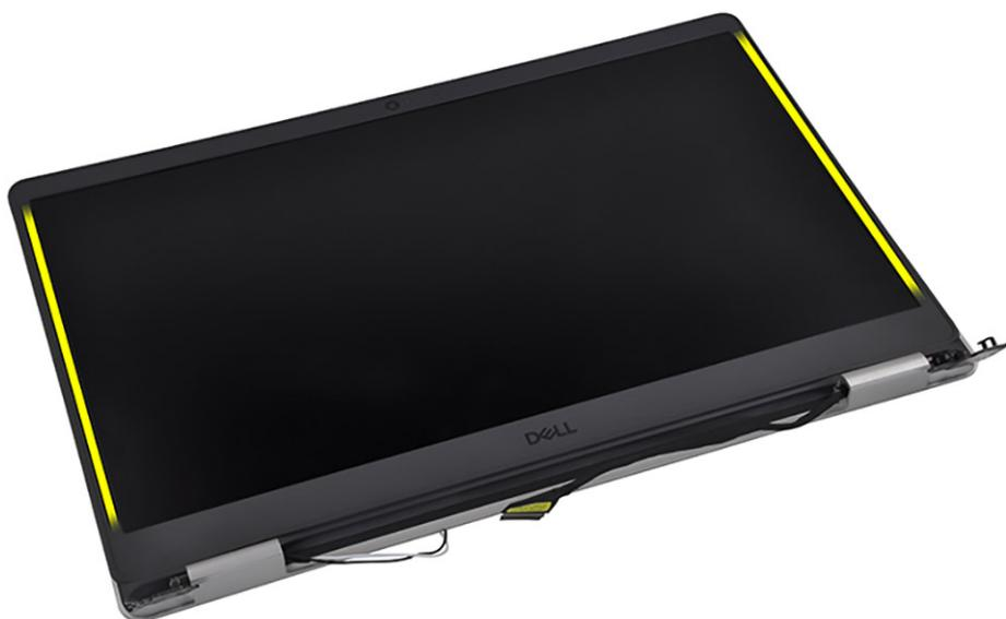
2. Per aprire il frontalino del display far leva sul bordo interno del lato superiore del gruppo del display.
