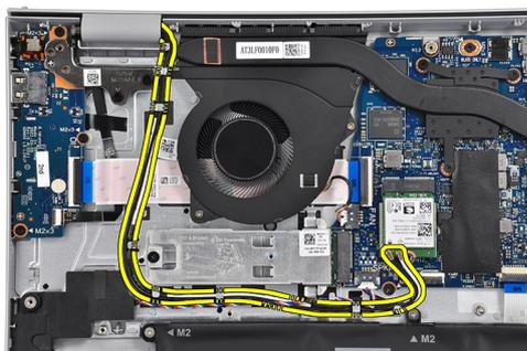
2. Collegare i cavi dell'antenna WLAN ai relativi connettori sulla scheda WLAN.
