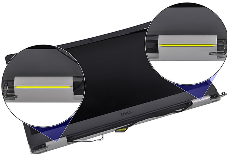
4. Per aprire il frontalino del display far leva sul bordo inferiore del gruppo del display.
