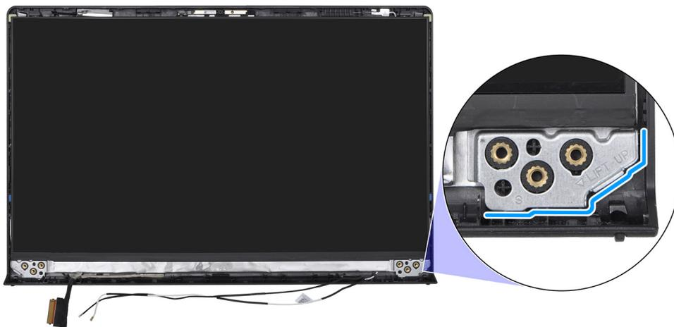
2. Con le mani, fare leva delicatamente sul pannello dalle linguette sul lato destro del gruppo del coperchio posteriore del display e antenna.
