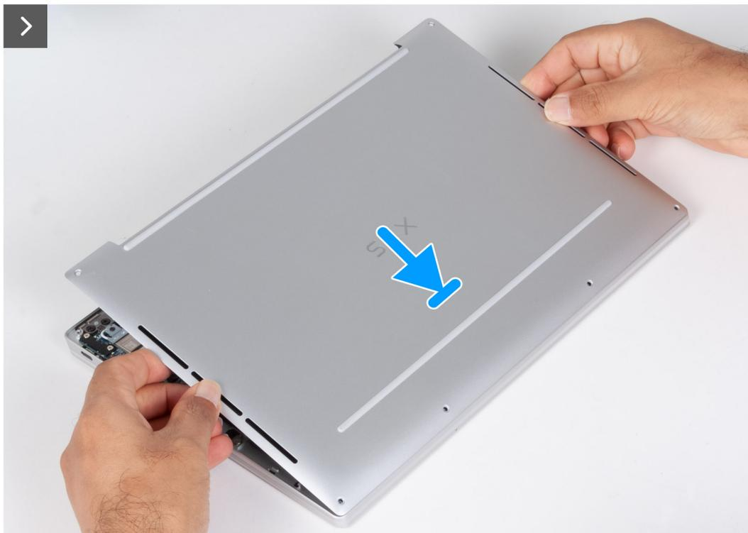
Figura 12. Installazione del coperchio della base
