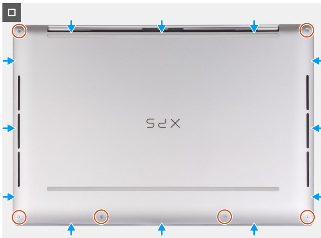
Figura 13. Installazione del coperchio della base
