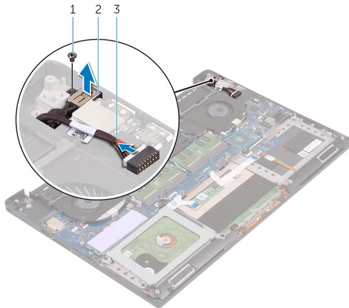
**Figura 32. Rimozione della porta dell'adattatore di alimentazione**
