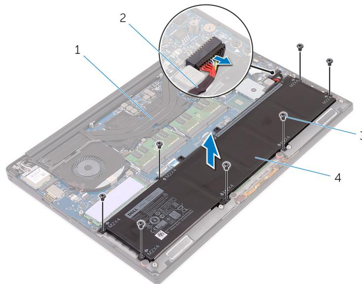
**Figura 4. Rimozione della batteria**
