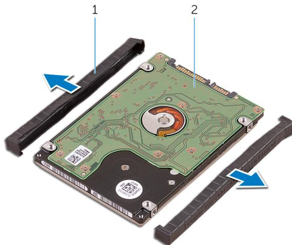
**Figura 10. Rimozione del coperchio del disco rigido**
