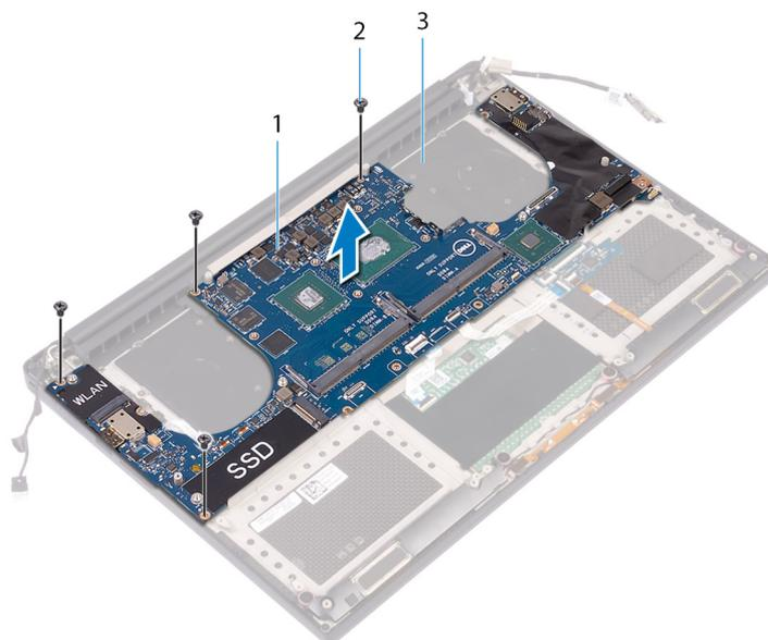
**Figura 23. Rimozione della scheda di sistema**
