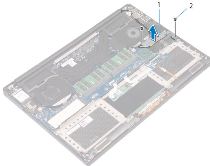
**Figura 19. Rimozione della staffa del cavo dello schermo**
