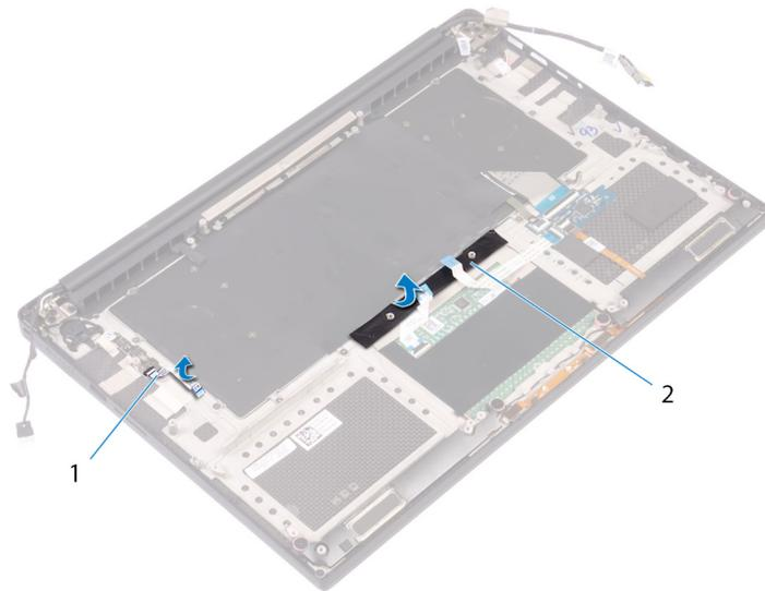
**Figura 26. Rimozione di Mylar**
