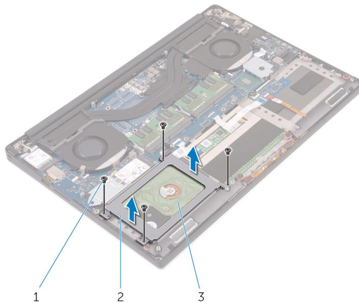
**Figura 7. Rimozione della gabbia del disco rigido**
