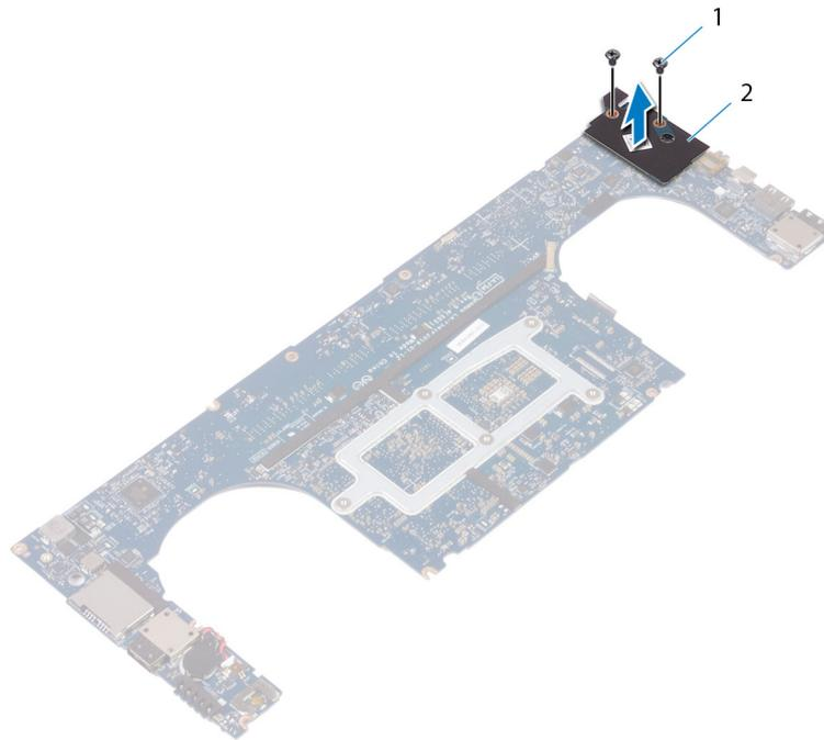
**Figura 24. Rimozione della scheda figlia audio**
