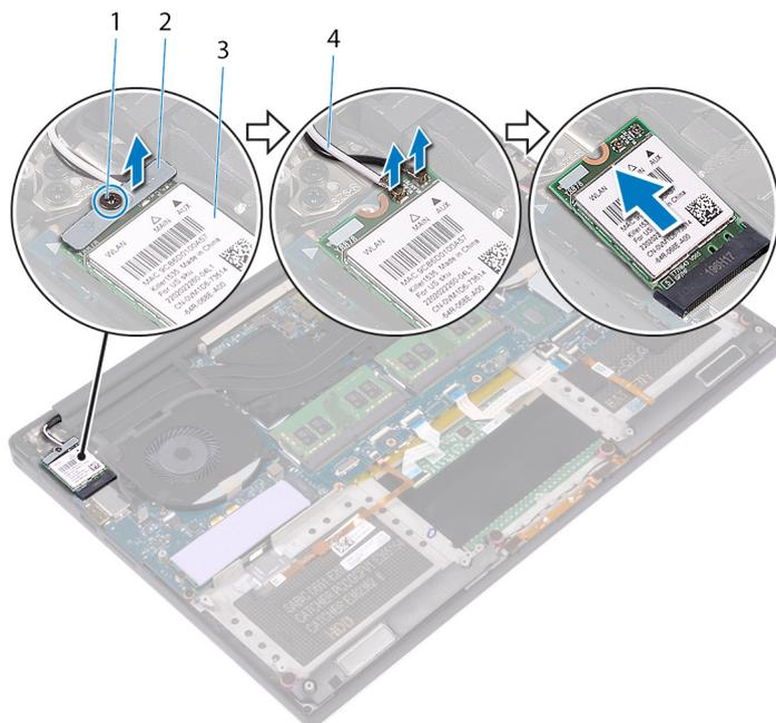
**Figura 16. Rimozione della scheda per reti senza fili**
