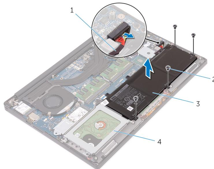
**Figura 3. Rimozione della batteria**
