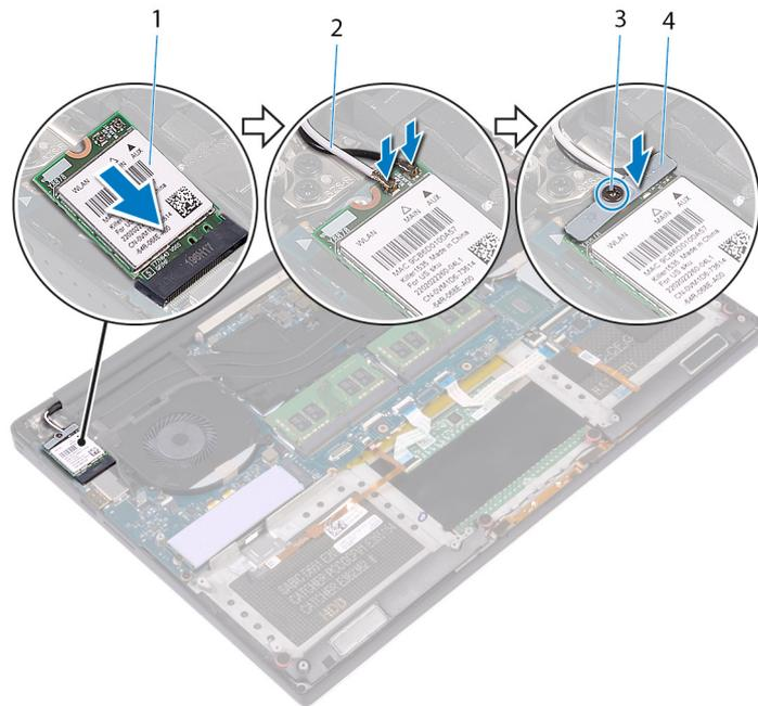
**Figura 17. Ricollocamento della scheda per reti senza fili.**
