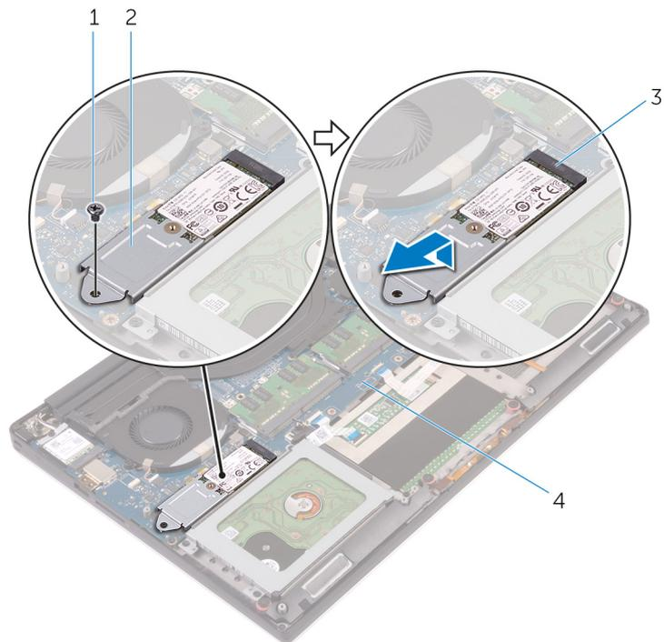
**Figura 11. Rimozione del gruppo dell'unità a stato solido**
