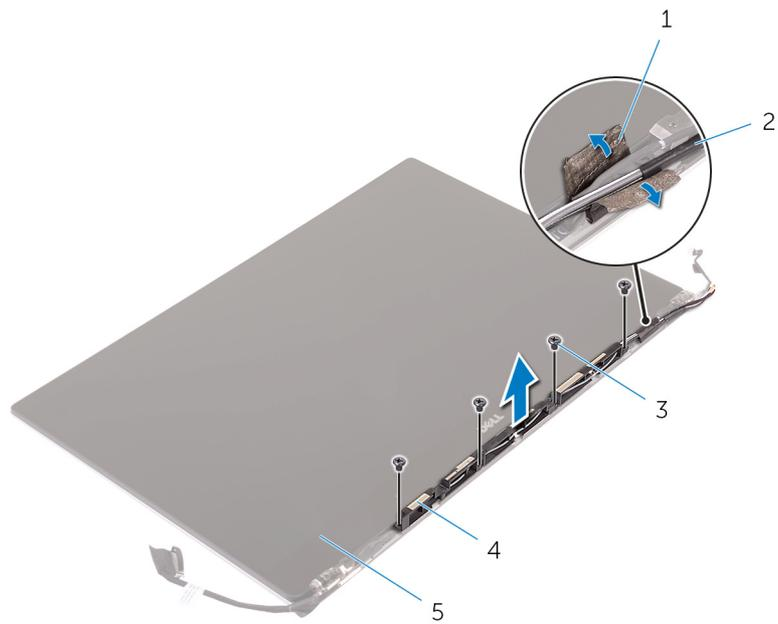
**Figura 35. Rimozione del modulo dell'antenna**
