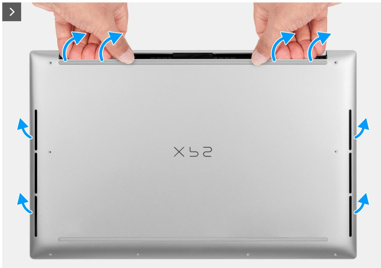
Figura 14. Rimozione del coperchio della base
