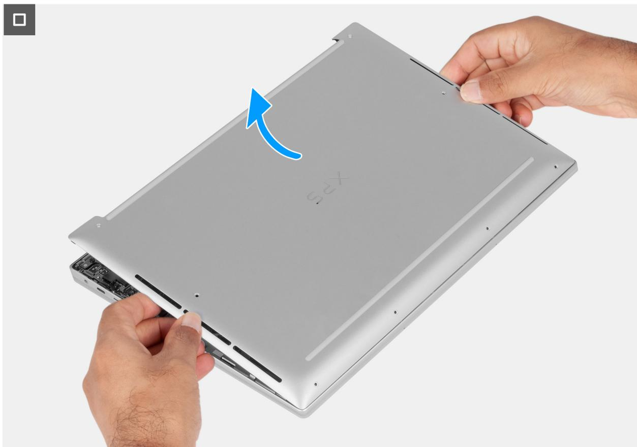
**Figura 15. Rimozione del coperchio della base**
