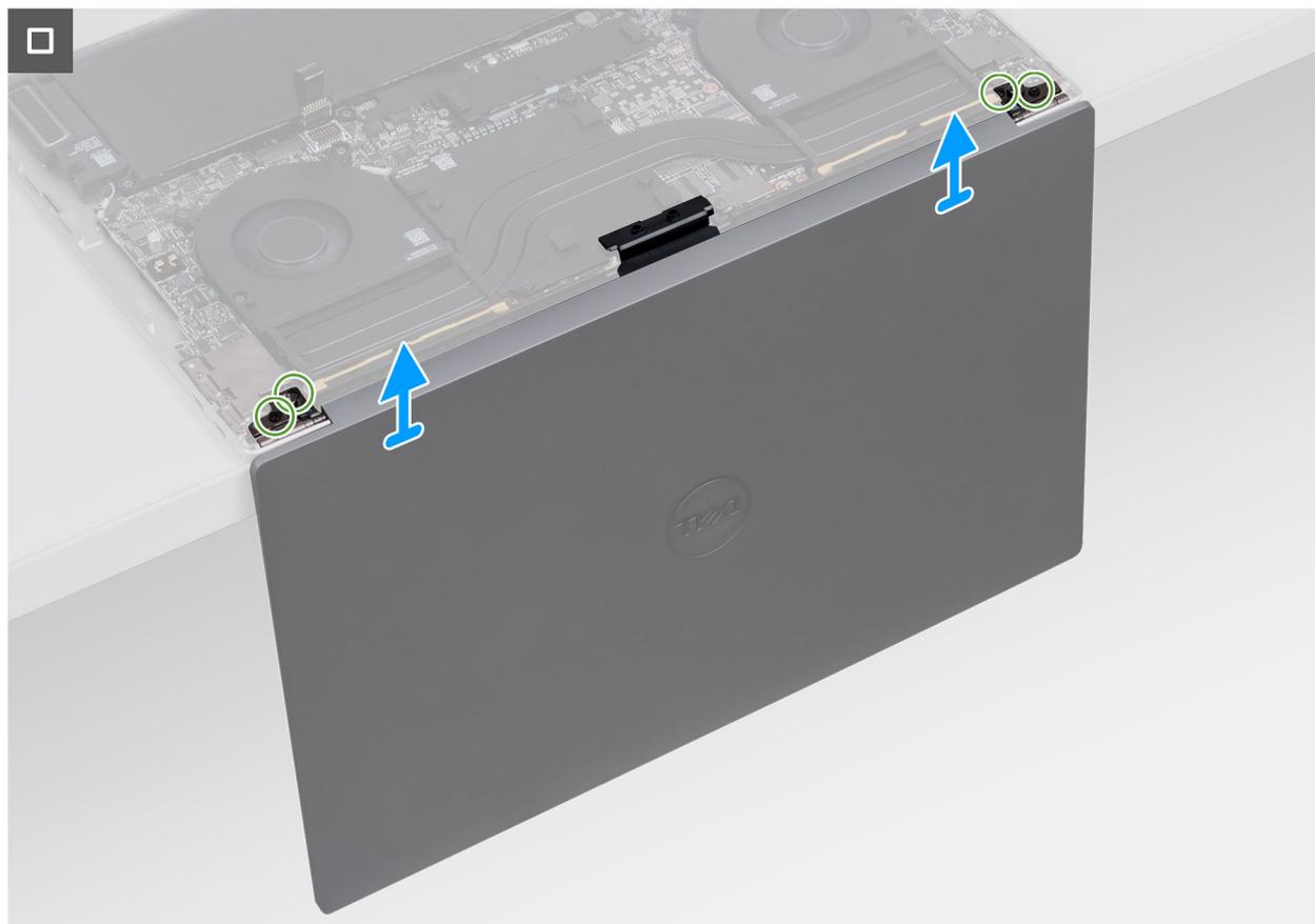
**Figura 39. Rimozione del gruppo del display**
