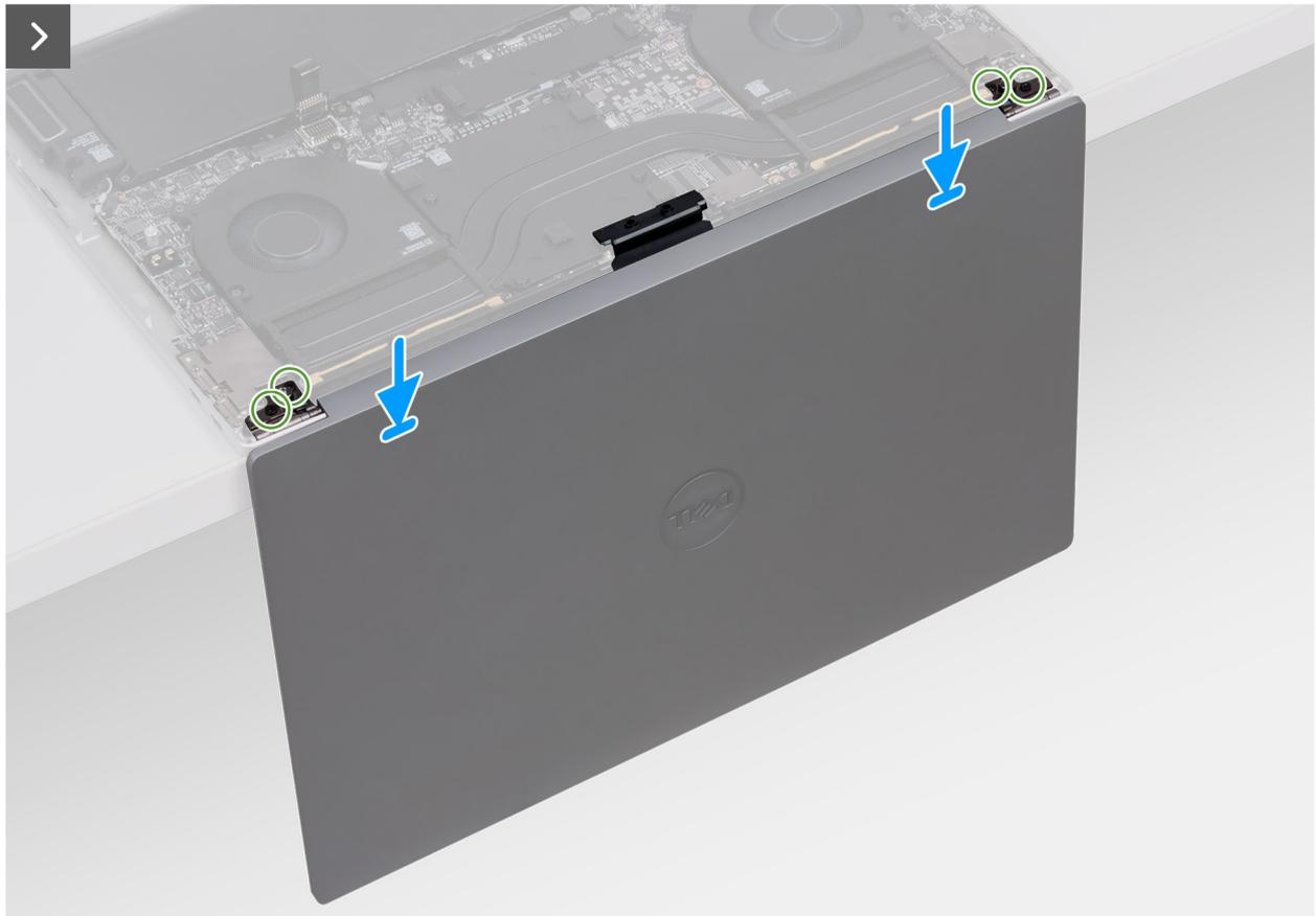
**Figura 41. Installazione del gruppo del display**
