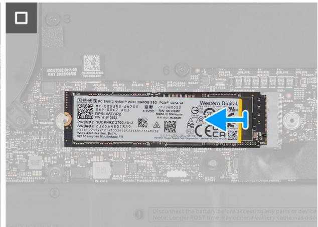
Figura 27. Rimozione dell'unità SSD M.2 2280
