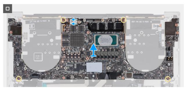
Figura 47. Rimozione della scheda di sistema
