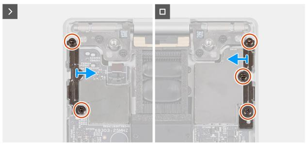
Figura 43. Rimozione delle staffe Type-C
