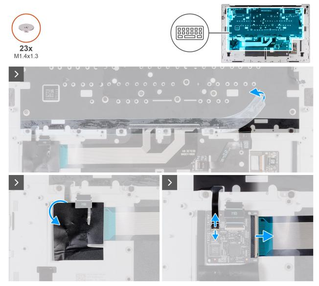
Figura 53. Rimozione della tastiera
