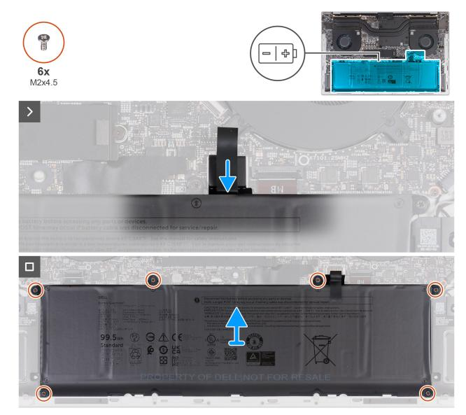
Figura 18. Rimozione della batteria
