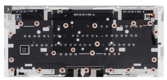
Figura 57. Installazione della tastiera
