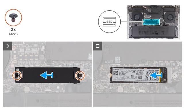
Figura 27. Rimozione dell'unità SSD M.2 2280
