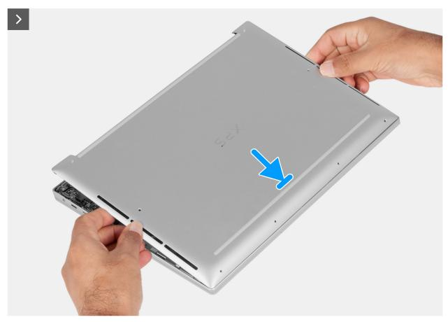
Figura 16. Installazione del coperchio della base
