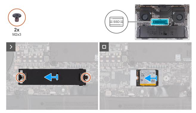
Figura 26. Rimozione dell'unità SSD M.2 2230
