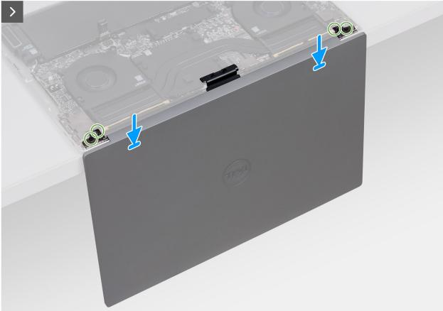
Figura 41. Installazione del gruppo del display
