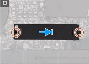
Figura 29. Installazione dell'unità SSD M.2 2280
