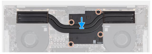
Figura 31. Installazione del dissipatore di calore - GPU integrata
