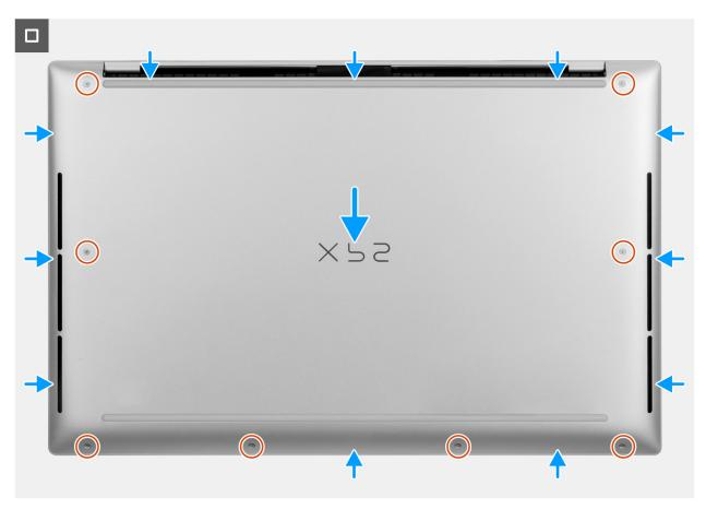
Figura 17. Installazione del coperchio della base
