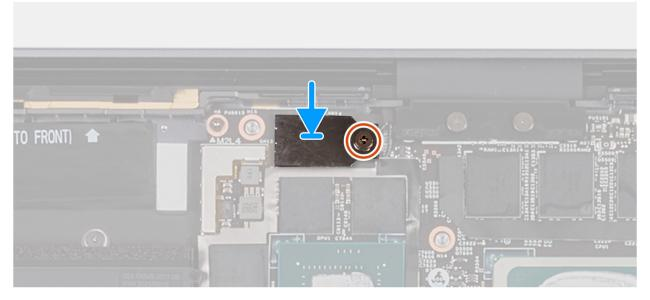
Figura 37. Installazione della protezione del modulo per reti senza fili
