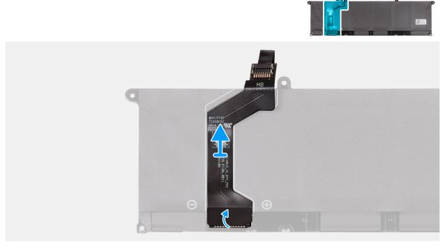
Figura 20. Rimozione del cavo della batteria
