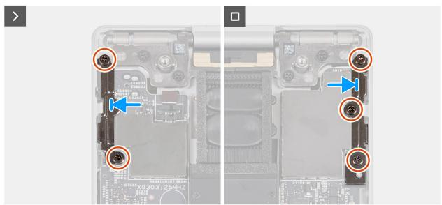
Figura 44. Installazione delle staffe Type-C
