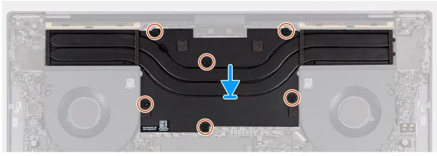
Figura 34. Installazione del dissipatore di calore - GPU dedicata (senza vapor chamber)
