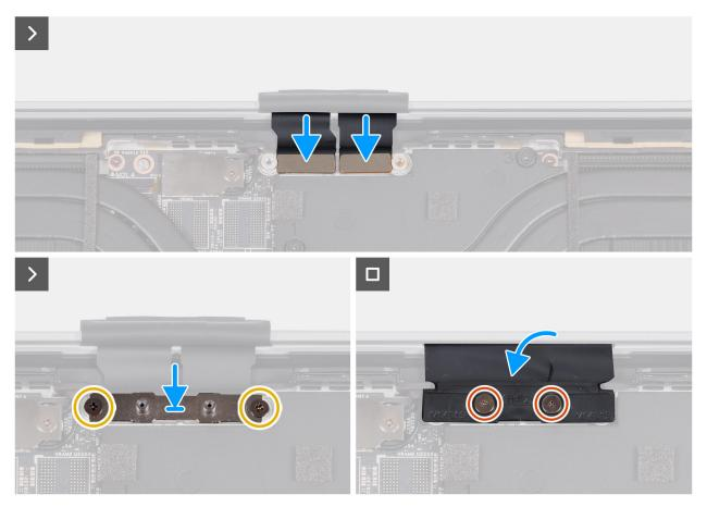
Figura 42. Installazione del gruppo del display
