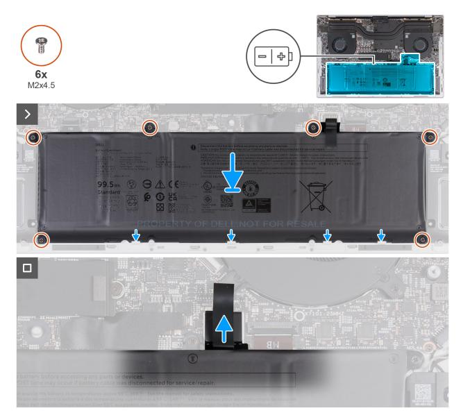
Figura 19. Installazione della batteria
