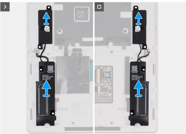
Figura 51. Rimozione degli altoparlanti
