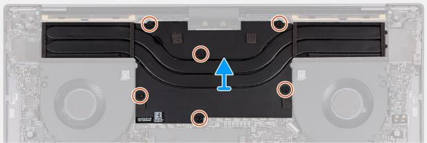
Figura 32. Rimozione del dissipatore di calore - GPU dedicata (senza vapor chamber)
