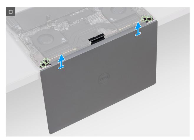
Figura 39. Rimozione del gruppo del display
