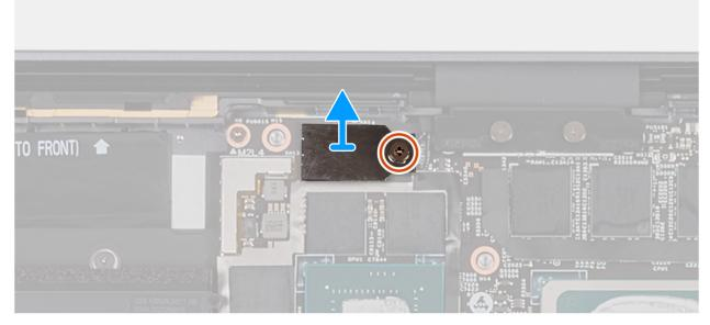
Figura 36. Rimozione della protezione del modulo per reti senza fili
