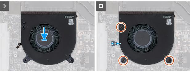
Figura 23. Installazione della ventola della GPU
