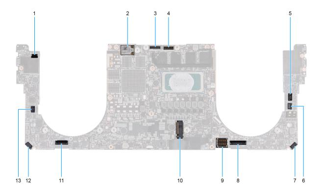
Figura 48. Connettori della scheda di sistema
