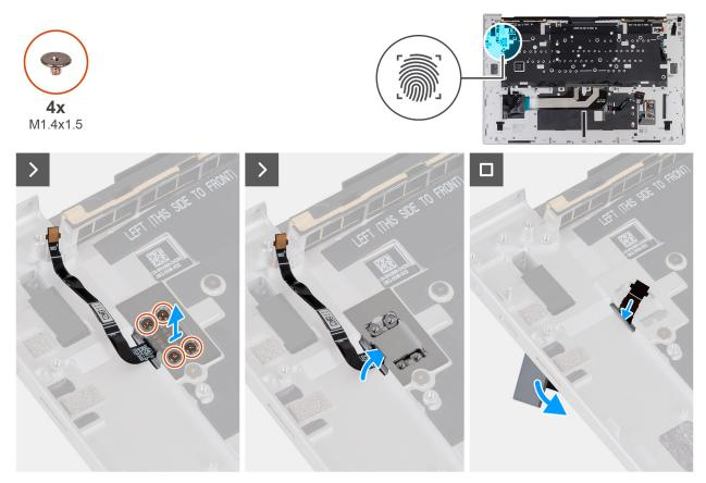
Figura 59. Rimozione del pulsante di accensione con lettore di impronte digitali
