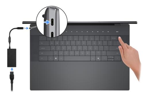
Figura 7. Collegamento dell'adattatore per l'alimentazione e premere il pulsante di accensione
