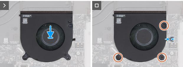
Figura 25. Installazione della ventola della CPU
