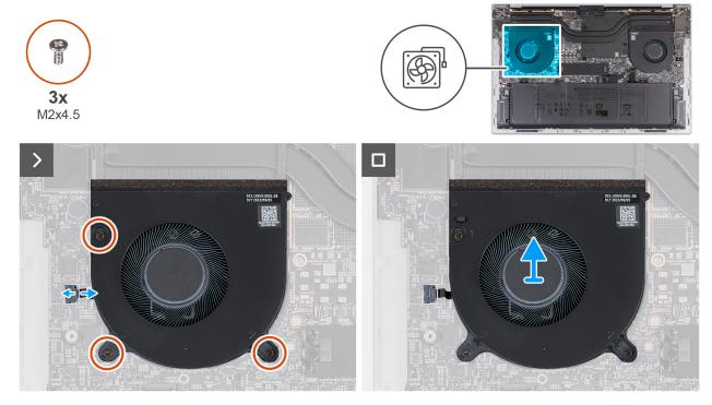
Figura 22. Rimozione della ventola della GPU
