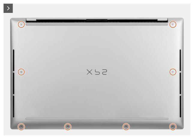
Figura 13. Rimozione del coperchio della base
