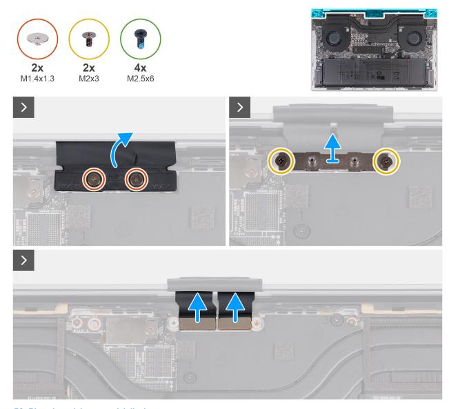
Figura 38. Rimozione del gruppo del display
