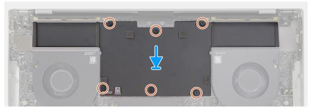
Figura 35. Installazione del dissipatore di calore - GPU dedicata (vapor chamber)
