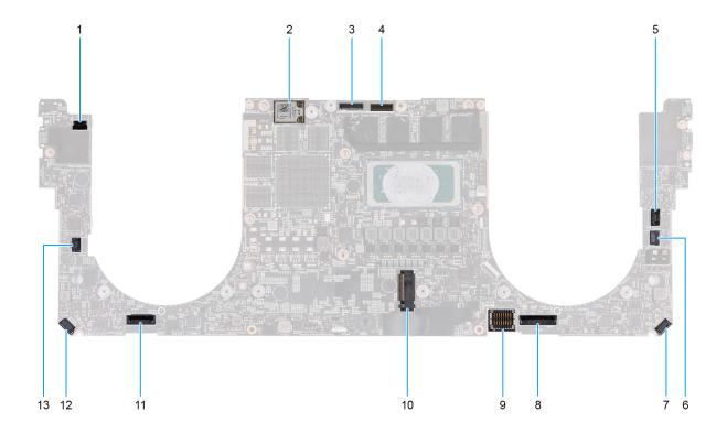
Figura 45. Connettori della scheda di sistema
