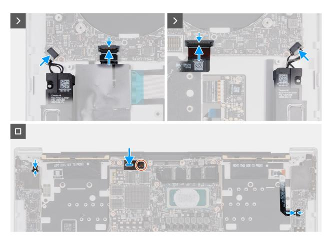
Figura 50. Installazione della scheda di sistema
