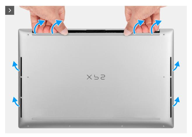
Figura 14. Rimozione del coperchio della base
