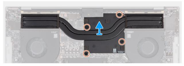
Figura 30. Rimozione del dissipatore di calore - GPU integrate
