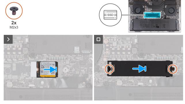
Figura 28. Installazione dell'unità SSD M.2 2230
