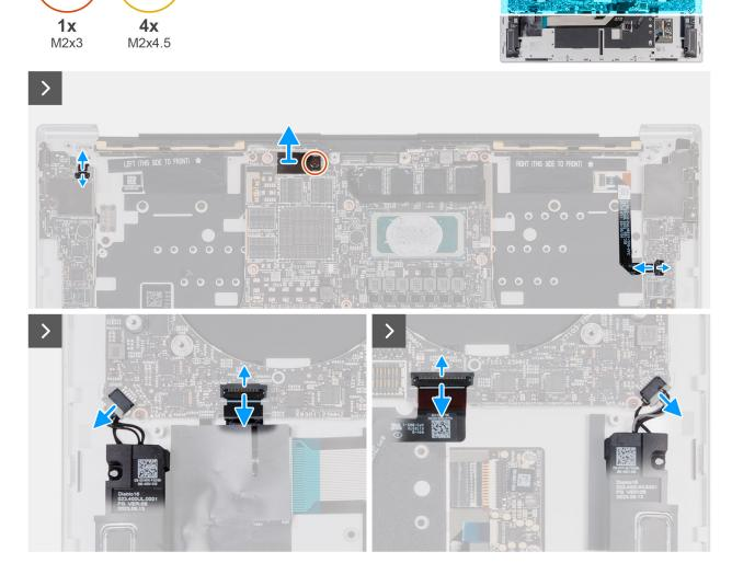
Figura 46. Rimozione della scheda di sistema
