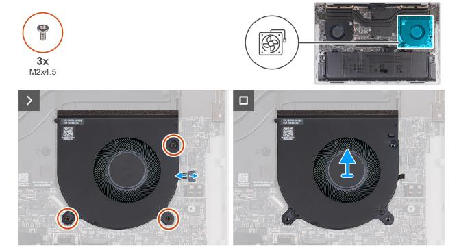
Figura 24. Rimozione della ventola della CPU
