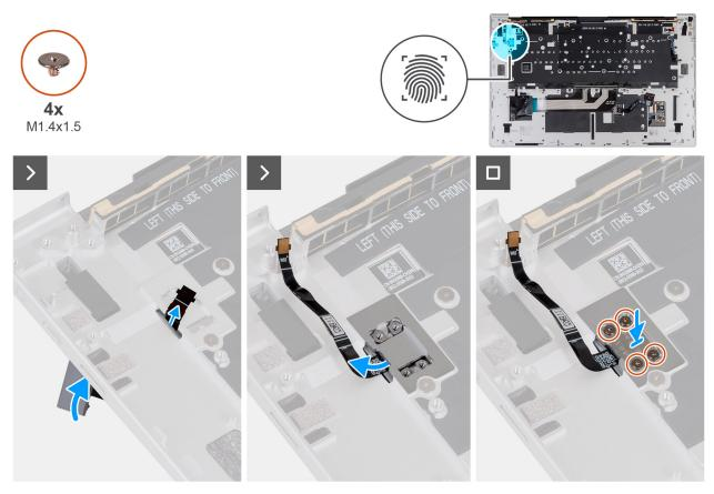
Figura 60. Installazione del pulsante di accensione con lettore di impronte digitali
