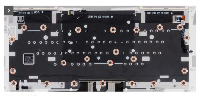
Figura 54. Rimozione della tastiera
