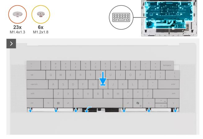
Figura 56. Installazione della tastiera
