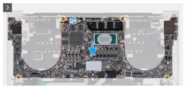
Figura 49. Installazione della scheda di sistema
