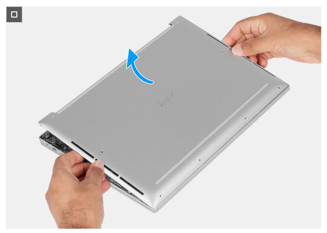
Figura 15. Rimozione del coperchio della base
