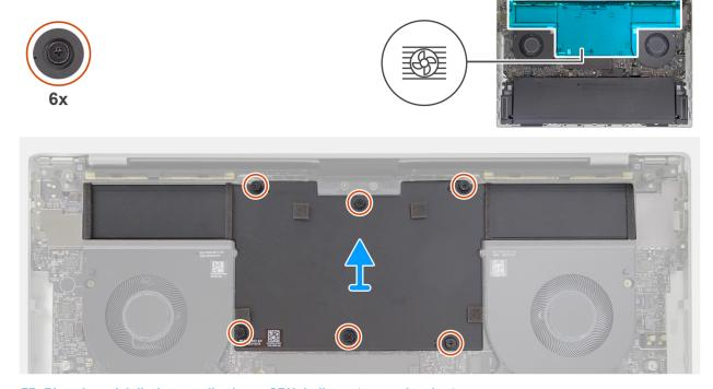
Figura 33. Rimozione del dissipatore di calore - GPU dedicata (vapor chamber)
