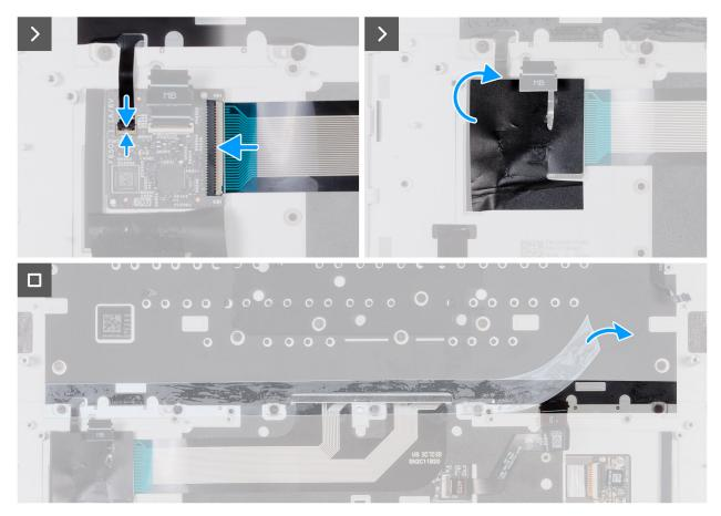
Figura 58. Installazione della tastiera
