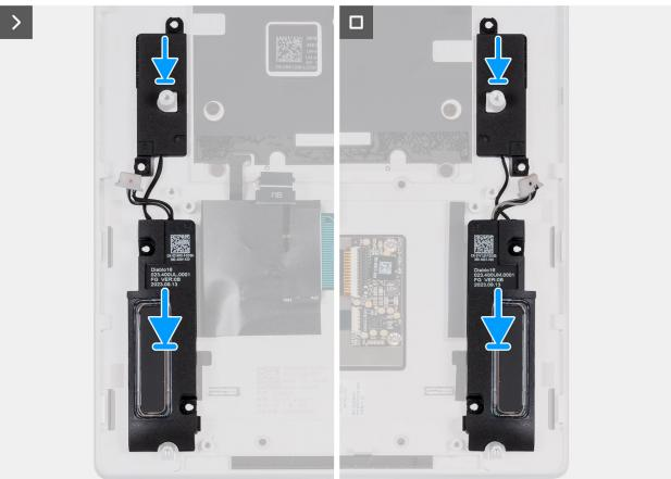
Figura 52. Installazione degli altoparlanti
