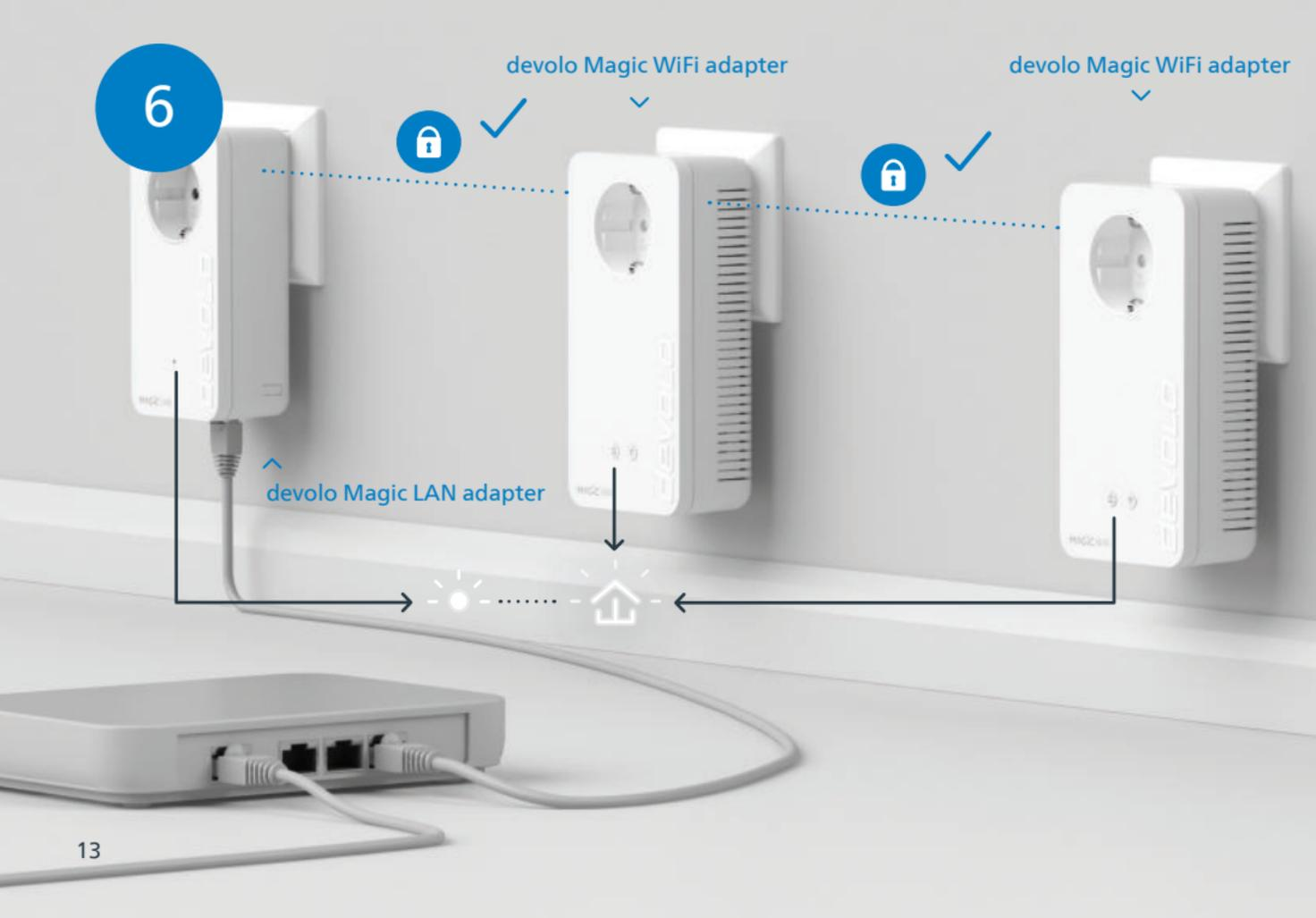
**| DE |** Der Vorgang ist abgeschlossen, sobald alle LEDs der Geräte permanent weiß leuchten. Dieser Vorgang dauert maximal 3 Minuten.
