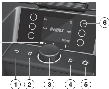
Figura 4. Painel de controlo
